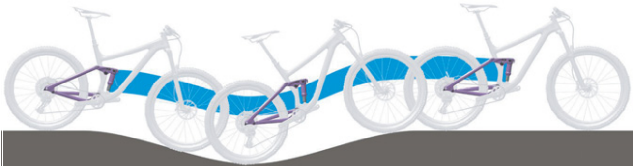
Figura 11: Comportamento di marcia ottimale dell'ammortizzatore del carro posteriore su un terreno con dossi
