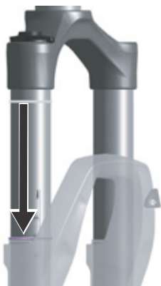
Figura 57: Spostamento dell'O-ring sulla forcella ammortizzata
