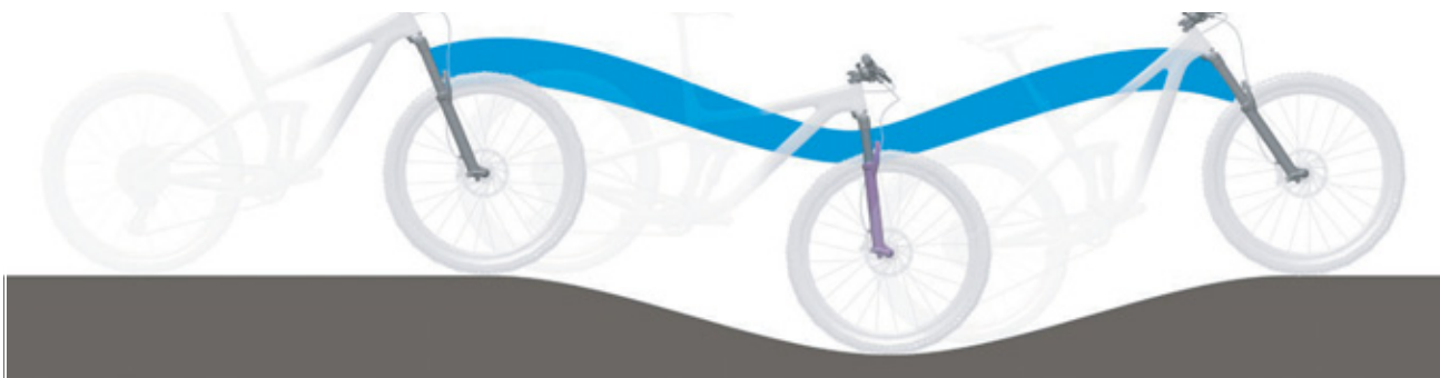
Figura 6: Comportamento di marcia ottimale della forcella su un terreno con dossi
