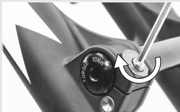
Figura 27: Serraggio del morsetto di sicurezza
