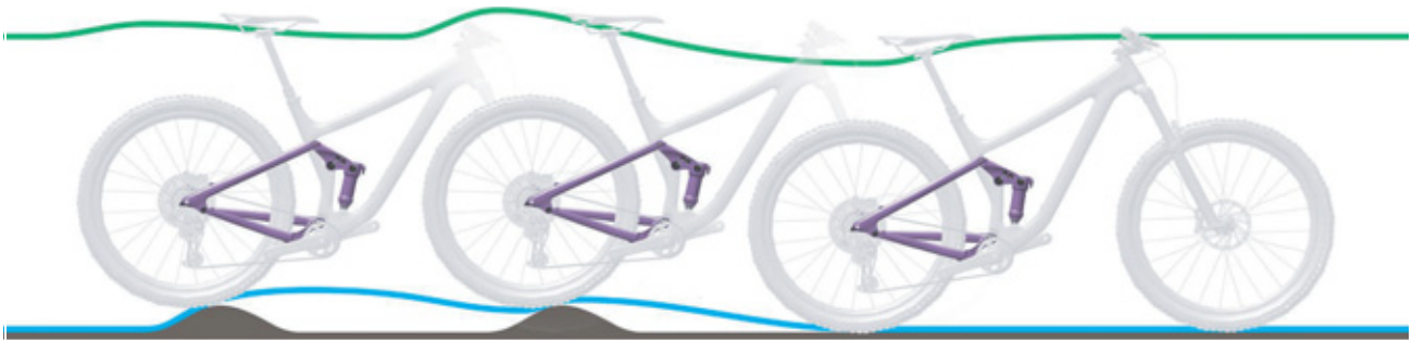
Figura 99: Corsa di estensione troppo lenta dell'ammortizzatore del carro posteriore
