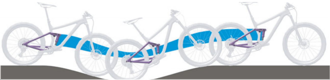
Figura 101: Sospensione dell'ammortizzatore del carro posteriore troppo morbida in salita
