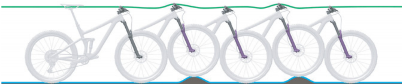
Figura 61: Comportamento di marcia ottimale della forcella
