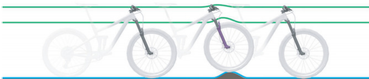
Figura 76: Comportamento di marcia ottimale su un terreno con asperità
