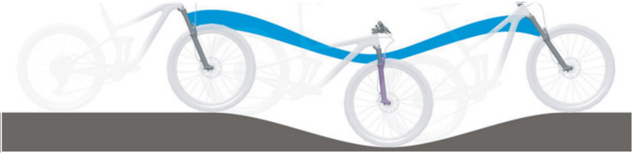
Figura 93: Sospensione della forcella ammortizzata troppo morbida in salita
