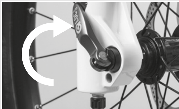
Figura 37: Chiusura del bloccaggio rapido
