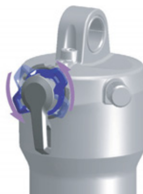
Figura 72: Regolazione più morbida del regolatore dello stadio di compressione
