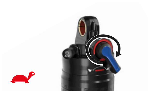
Figura 66: Riduzione della velocità di estensione
