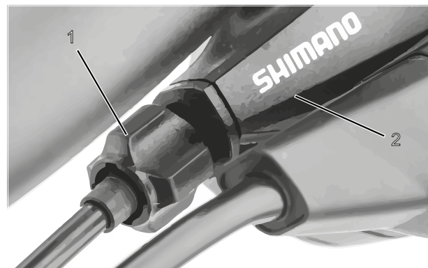
Figura 86: Boccola di regolazione (1) del cambio azionato da cavo singolo con scatola della leva del cambio (2), esempio
