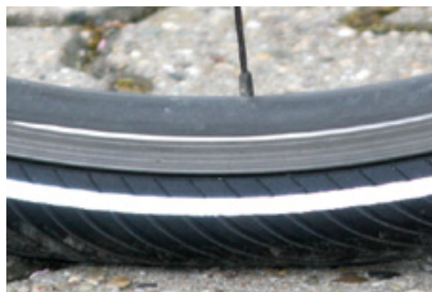
Figur 107: Korrekt dæktryk. Dækkets form er næsten ikke ændret af kropsvægtens belastning
