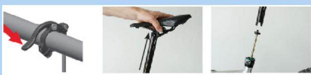
Figur 170: Udtrækning af sadelpind
