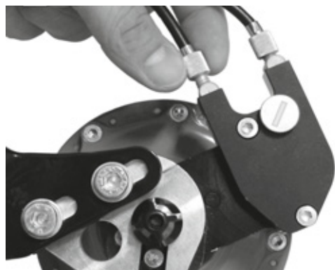
Figur 162: På udgaver af Rohloff-nav med ekstern skifteaktivering sidder kabelindstilleren på wireboksen, som sidder på venstre side
