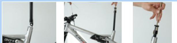
Figur 197: Fastgørelse af patronens ventildæksel
