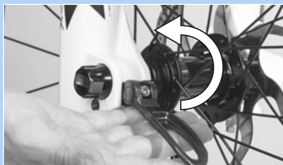
Figur 73: Hurtigbespændingsgrebet trykkes i pilens retning
