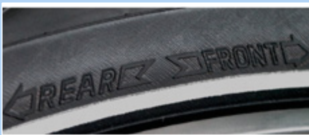
Figur 65: Køreretningspil på MTB-dæk
