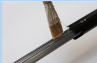
Figur 223: Påføring af fedt
