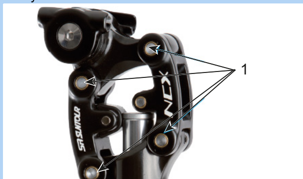
Figur 168: Smørepunkter på SR Suntour affjedret sadelpind
