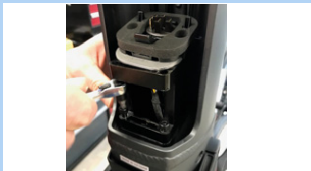
Figur 52: Fjernelse af 4 mm 6-kant-skruer
