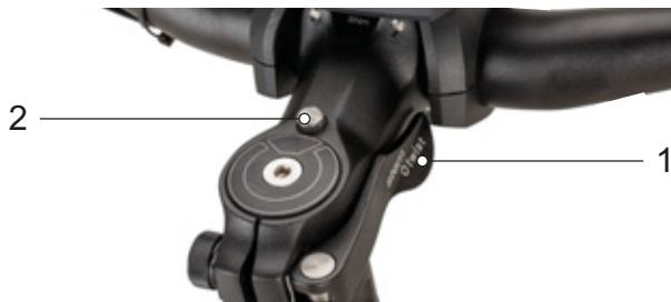
Figur 147: Frempind, udførelse II med greb på frempindens hurtigbespænding (1) og frigørelsesknap (2)
