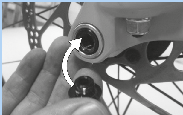
Figur 68: Skub hurtigbespændingsgrebet ind i akslen
