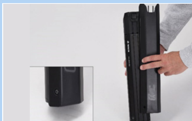
Figur 63: Skub batteridækslet på batteriet
