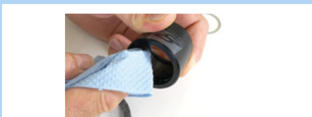
Figur 216: Rengøring af udvendig kappe
