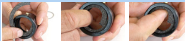
Figur 217: Ilægning af filtring
