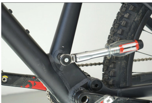
Figur 85: Fastspænding af sadelpindsaksel
