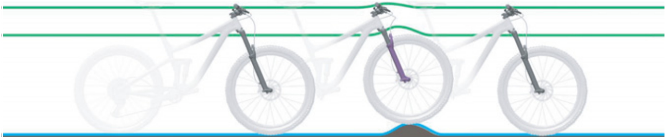
Figura 11: Condición óptima de marcha de la horquilla en caso de irregularidades
