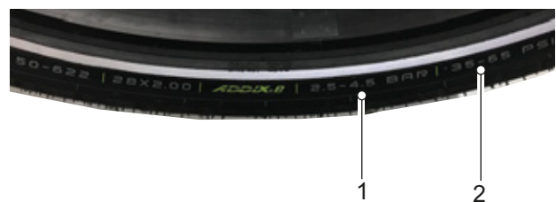
Figura 164: Presión de inflado en bar (1) y psi (2)
