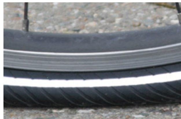
Figura 113: Presión de inflado demasiado baja
