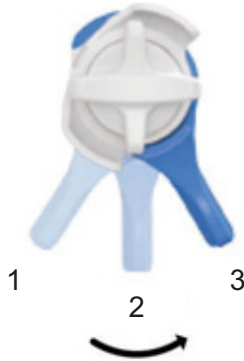
Figura 126: Ajuste de la palanca de 3 vías desde la posición cerrada (1), pasando por la posición media (2) hasta la posición abierta (3)
