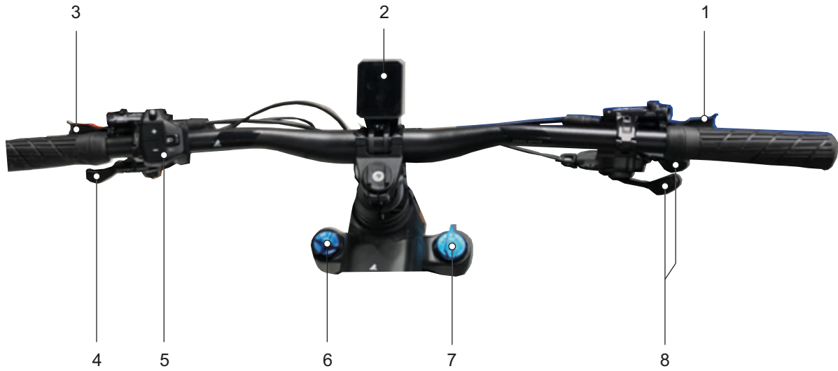
Figura 37: Vista detallada del manillar con pantalla Compact 2.0 FIT, ejemplo
