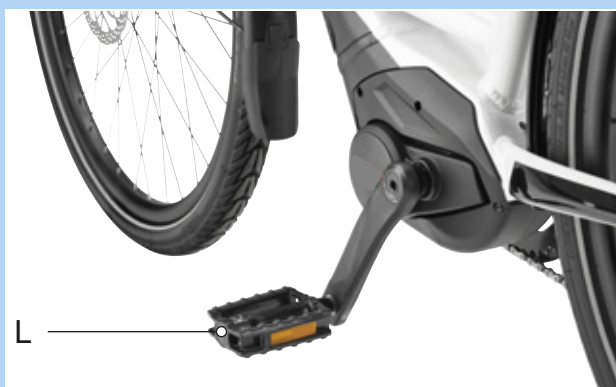
Figura 81: Pedal L en el brazo de manivela izquierdo
