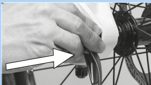
Figura 72: Inserción del cierre rápido en la dirección de la flecha
