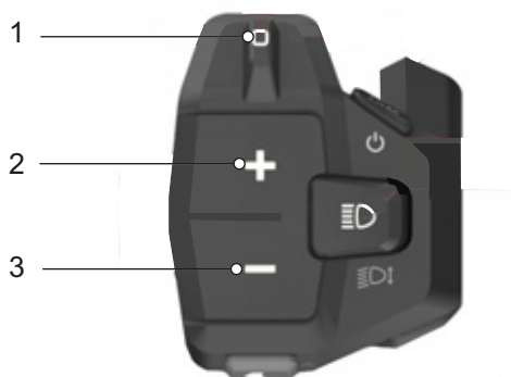
Figura 134: Posición del botón basculante de navegación (1), del botón + (2) y del botón - (3)
