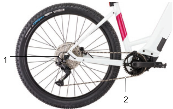
Figura 31: Esquema de la transmisión por cadena con cambio de cadena
