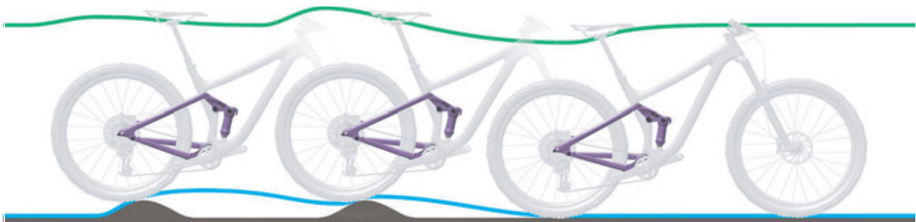
Figura 243: Descompresión demasiado lenta del amortiguador de la horquilla trasera
