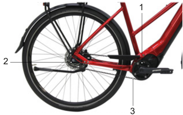
Figura 32: Esquema de la transmisión por correa
