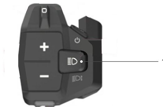
Figura 149: Posición del botón de la luz de marcha
