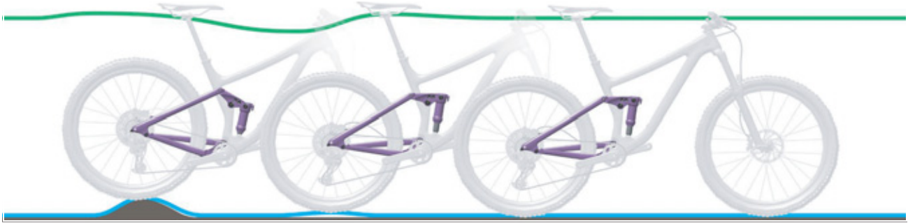
Figura 241: Descompresión demasiado rápida del amortiguador de la horquilla trasera
