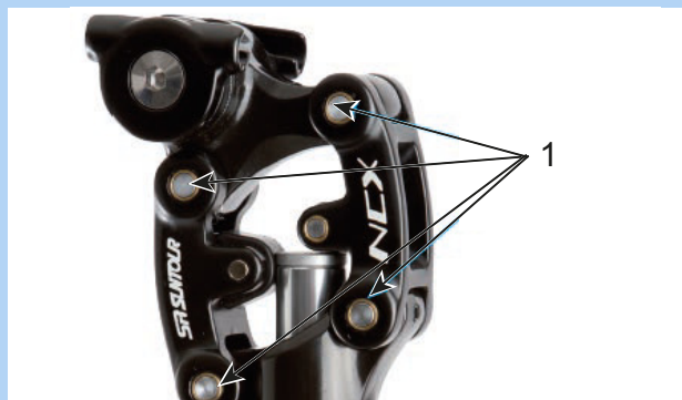
Figura 197: Puntos de lubricación de la tija de sillín de muelle SR SUNTOUR
