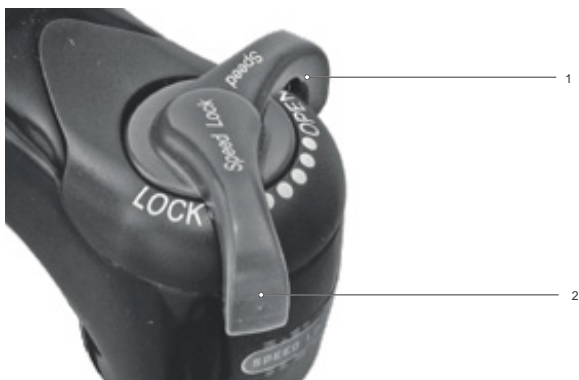
Figura 206: Ajuste para un regulador de niveles de presión más blando
