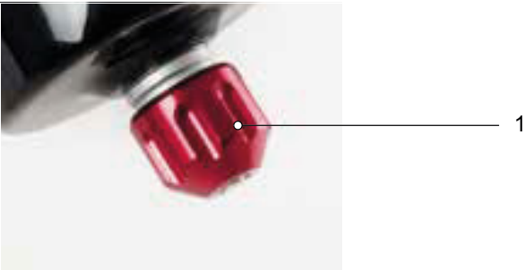
Figura 200: Tornillo de niveles de tracción SR SUNTOUR (1)
