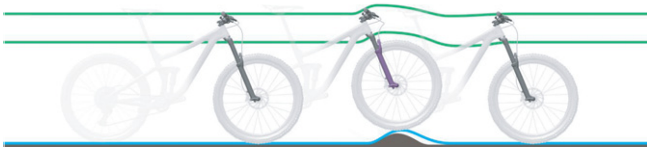
Figura 213: Amortiguación de la horquilla de suspensión demasiado dura en caso de irregularidades
