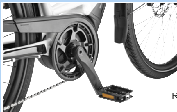
Figura 82: Pedal R en el brazo de manivela derecho
