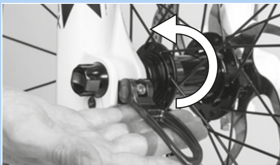
Figura 68: Presión de la palanca de cierre rápido en la dirección de la flecha
