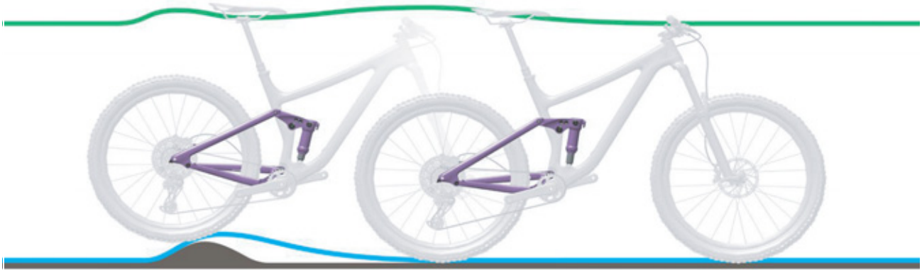
Figura 231: Amortiguación del amortiguador de la horquilla trasera demasiado dura en caso de irregularidades
