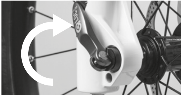
Figura 74: Cierre del cierre rápido
