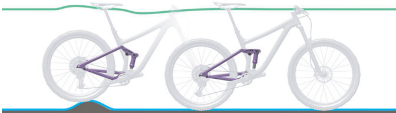
Figura 125: Condición óptima de marcha del amortiguador de la horquilla trasera en caso de irregularidades
