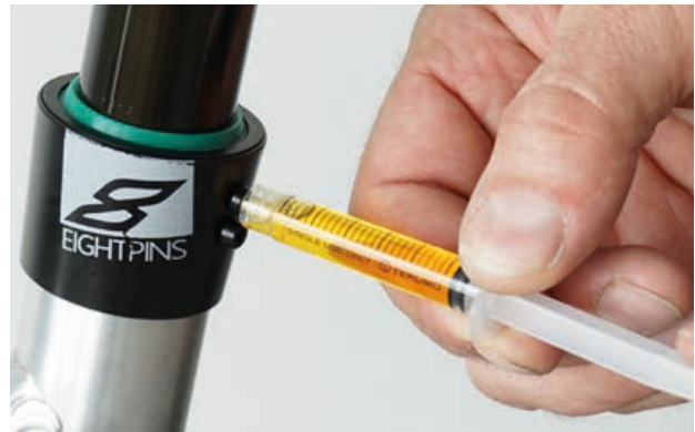
Figura 163: Lubricación de la tija de sillín eightpins
