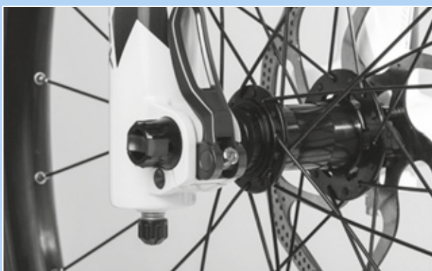
Figura 69: Posición perfecta de la palanca tensora
