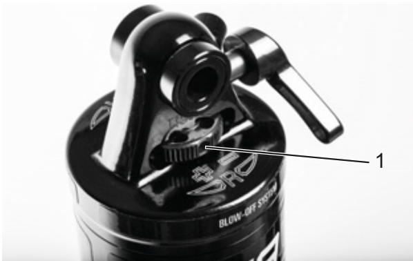
Figura 226: Rueda del regulador de niveles de tracción SR SUNTOUR (1) en el amortiguador de la horquilla trasera
