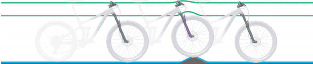
Figura 152: Condición óptima de marcha en terrenos con irregularidades
