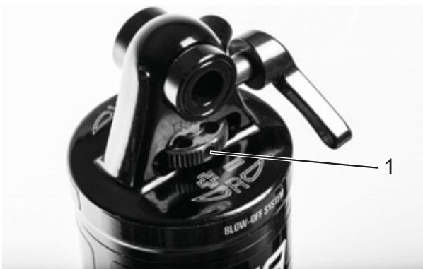
Figura 228: Rueda del regulador de niveles de tracción SR SUNTOUR (1) en el amortiguador de la horquilla trasera
