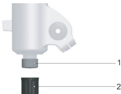
Figura 218: Tornillo de niveles de tracción FOX (1) debajo del capuchón de la horquilla (2)
