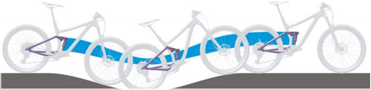
Figura 237: Suspensión del amortiguador de la horquilla trasera demasiado blanda en montaña
