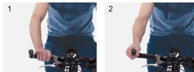
Figura 144: Posiciones de agarre en el acople de manillar
