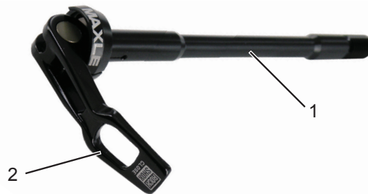
Afbeelding 56: Snelspanner wiel, uitvoering V, met as (1) en spanhendel (2)
