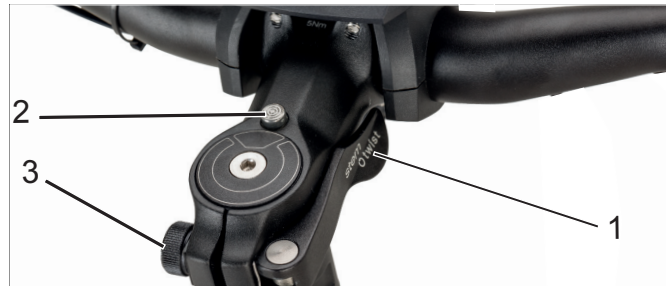
Afbeelding 24: Voorbouw, uitvoering II met spanhendel (1), deblokkeringsknop (2) en kartelmoer (3)
