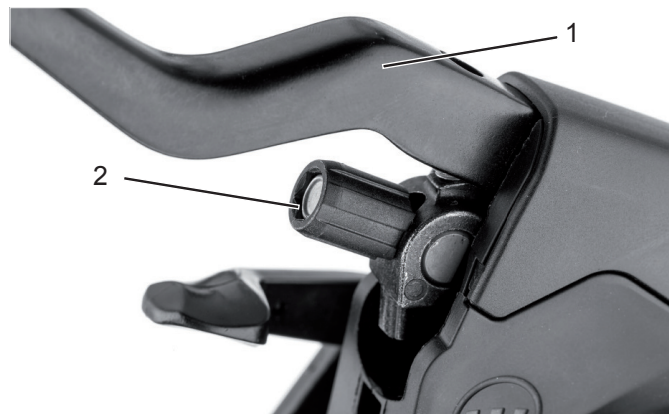
Afbeelding 65: Remhendel (1) van de hydraulisch bediende velgrem met afstelschroef (2)
