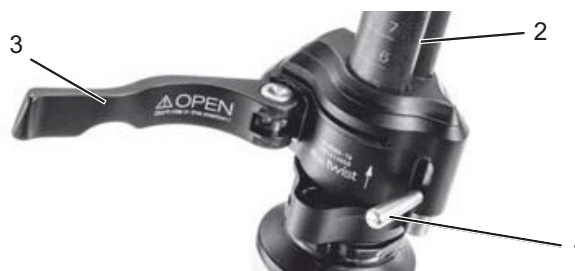
Rysunek 71: Otwarta dźwignia mocująca zacisku szybko mocującego (3) mostka (2), wersja I, wyposażona w dźwignię zabezpieczającą mostka (1)
