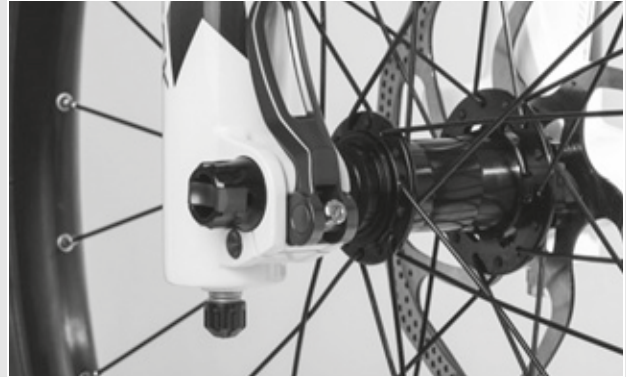
Rysunek 95: Ustawianie siły mocowania zacisku szybko mocującego
