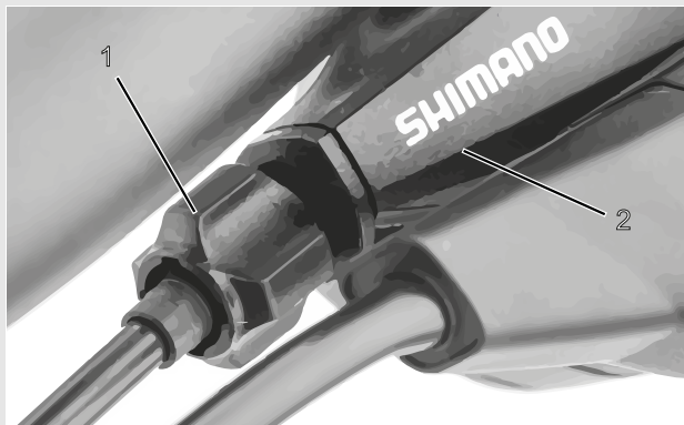
Rysunek 97: Nakrętka regulacyjna (1) jednoczęściowego mechanizmu zmiany przerzutek z obudową dźwigni zmiany biegów (2), przykład
