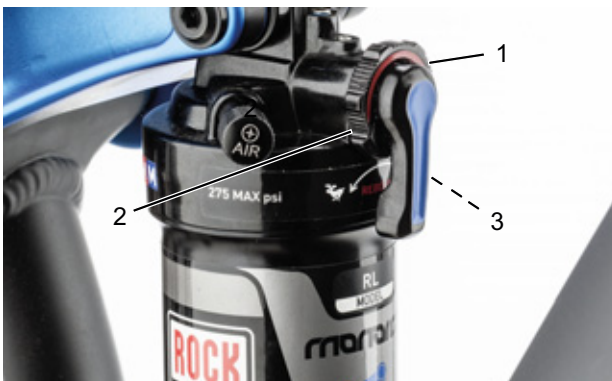
Rysunek 90: Ustawianie twardości tłumika odbicia za pomocą pokrętła regulacyjnego (1)
