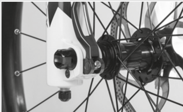
Rysunek 38: Optymalne położenie dźwigni mocującej
