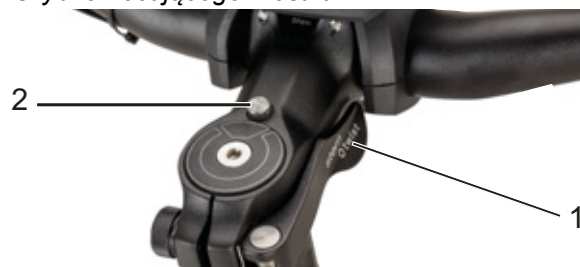
Rysunek 72: Mostek, wersja II z dźwignią mocującą zacisku szybko mocującego (1) mostka i przyciskiem odblokowującym (2)
