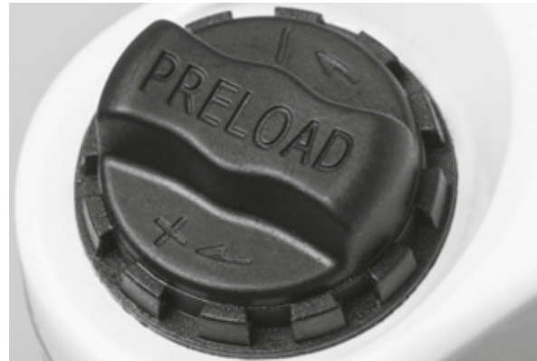
Rysunek 61: Pokrętko regulacyjne ujemnego skoku sprężyny, usytuowane na koronie widelca amortyzowanego
