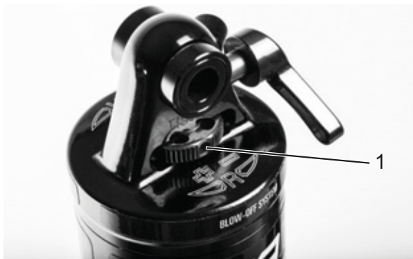
Afbeelding 60: Wiel (1) van de trekdemperafsteller Suntour op de achterbouwdemper
