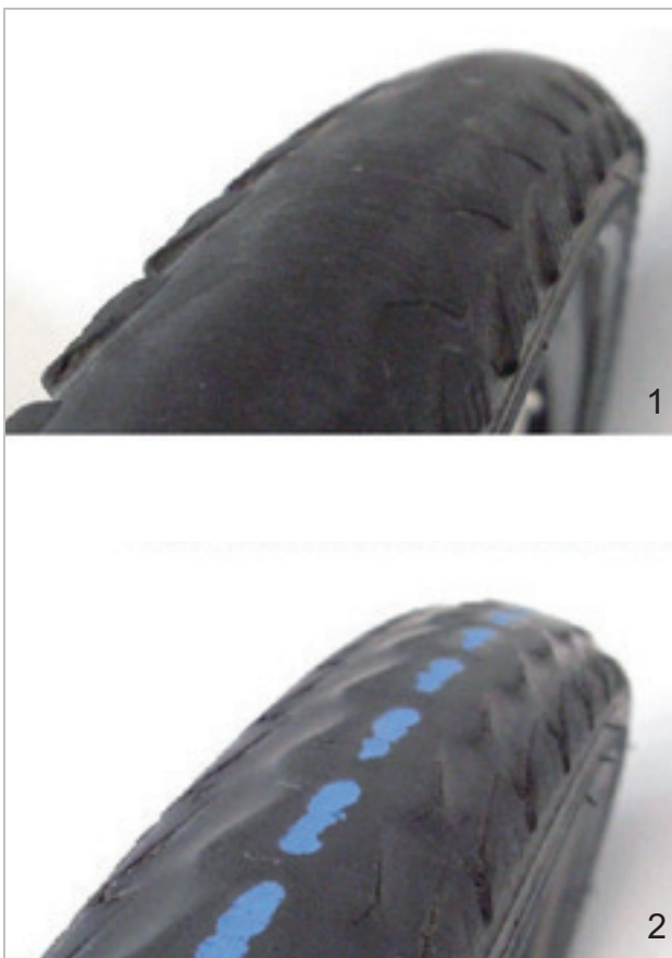
Abbildung 180: Reifen ohne Profil, der gewechselt werden kann (1) und Reifen mit durchscheinendem Pannenschutz (2), der gewechselt werden muss
