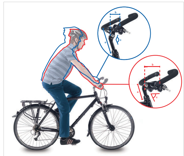
Abbildung 107: Citybike (blau) und Trekkingrad Position (rot) durch Winkeländerung
