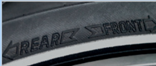
Abbildung 68: Laufrichtungspfeil auf MTB-Reifen
