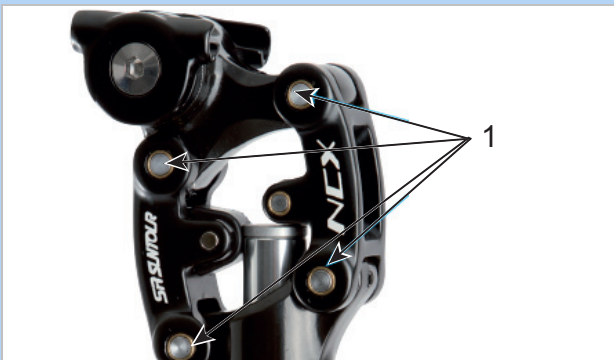
Abbildung 202: Schmierpunkte SR SUNTOUR Feder-Sattelstütze
