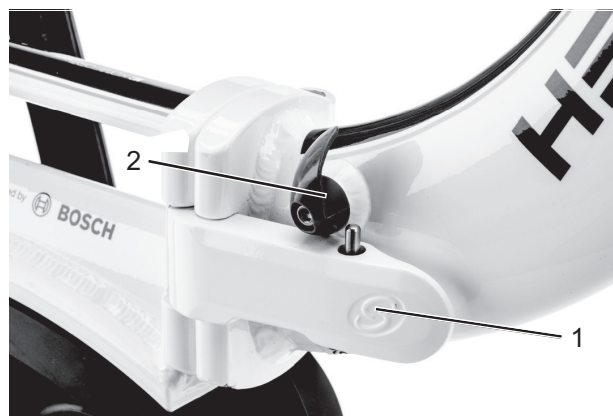
Abbildung 172: Geschlossener (1) und geöffneter (2) Rahmen-Sicherungshebel
