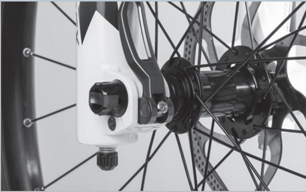
Abbildung 77: Perfekte Lage des Spannhebels
