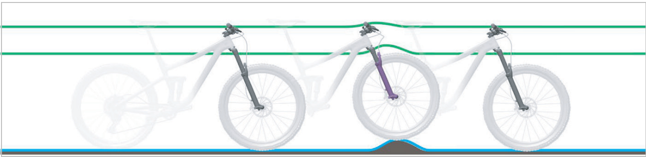
Abbildung 17: Optimales Fahrverhalten der Federgabel bei Unebenheiten
