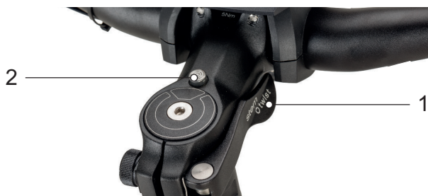
Abbildung 171: Vorbau, Ausführung II mit Spannhebel des Vorbau-Schnellspanners (1) und Entsperrknopf (2)
