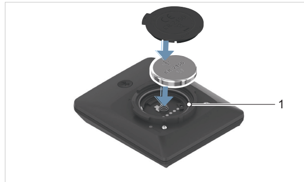
Abbildung 133: Batterie einlegen mit korrekt ausgerichtetem Dichtgummi (1)
