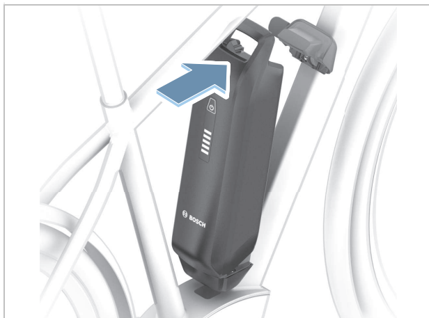
Abbildung 146: PowerPack Akku nach oben klappen
