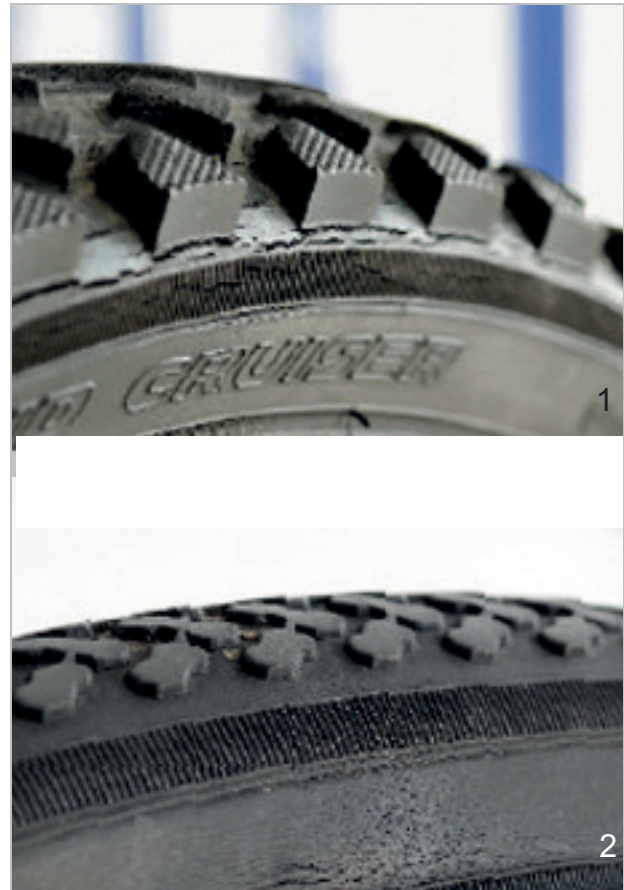
Abbildung 181: Beispiele für Ermüdungsrisse (1) und Alterungsrisse (2)
