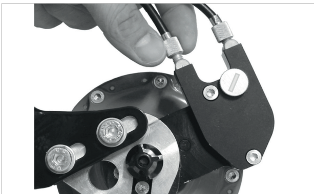
Abbildung 197: ROHLOFF-Naben Versionen mit externer Schaltansteuerung haben die Zugeinsteller an der Seilbox, die sich auf der linken Seite befindet
