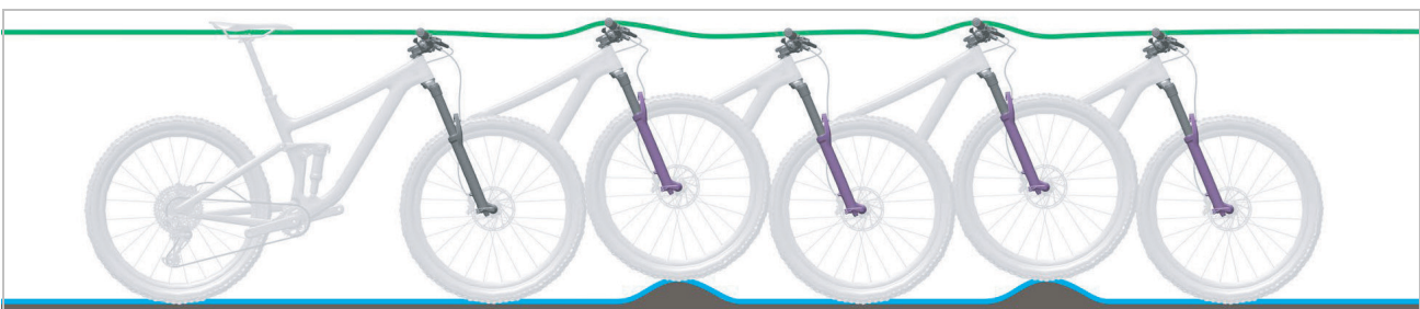
Abbildung 18: Optimales Fahrverhalten der Federgabel
