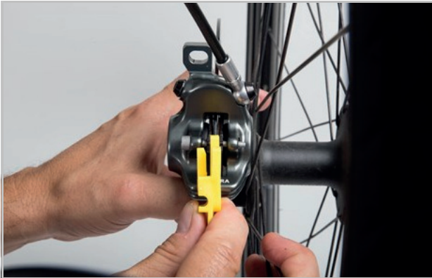
Abbildung 182: Bremsbelag im eingebauten Zustand mithilfe der Transportsicherung prüfen
