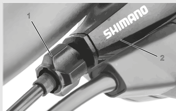
66. ábra: Az egybovdenes, bovdenel működő sebességváltó beállítóhüvelye (1) váltókarházzal (2), példa
