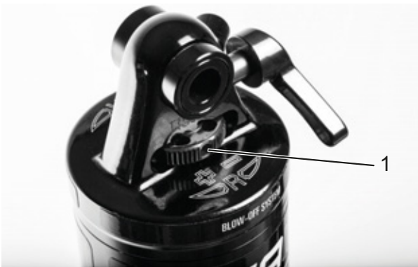
42. ábra: Suntour kerék húzófokozat-beállító (1) a hátsó lengéscsillapítón
