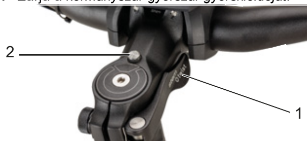
58. ábra: II kivitelű kormányszár a kormányszár-gyorszár (1) gyorskioldójával és reteszelésoldó gombbal (2)
