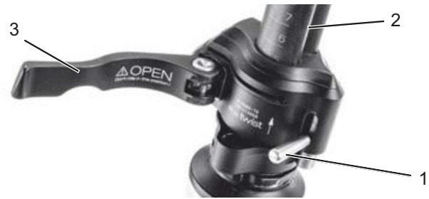
57. ábra: A kormányszár-gyorszár (3) nyitott gyorskioldója a kormányszáron (2), I kivitel, a kormányszáron (1) lévő rögzítőkarral
