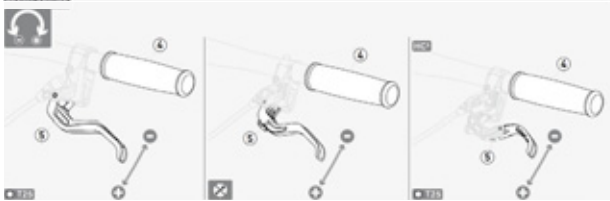
36. ábra: Magura tárcsafék fékkar markolási szélességének beállítása
