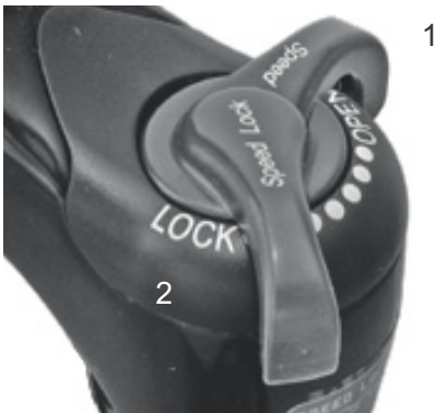
52. ábra: Suntour nyomásfokozat-beállító OPEN (1) és LOCK (2) pozíciókkal
