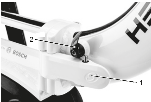
59. ábra: Zárt (1) és nyitott (2) váz-rögzítőkar
