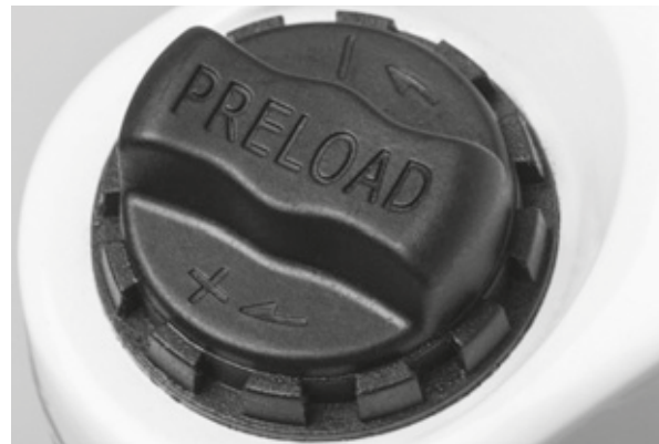
38. ábra: A negatív rugóút beállító kereke a teleszkópos villa koronáján
