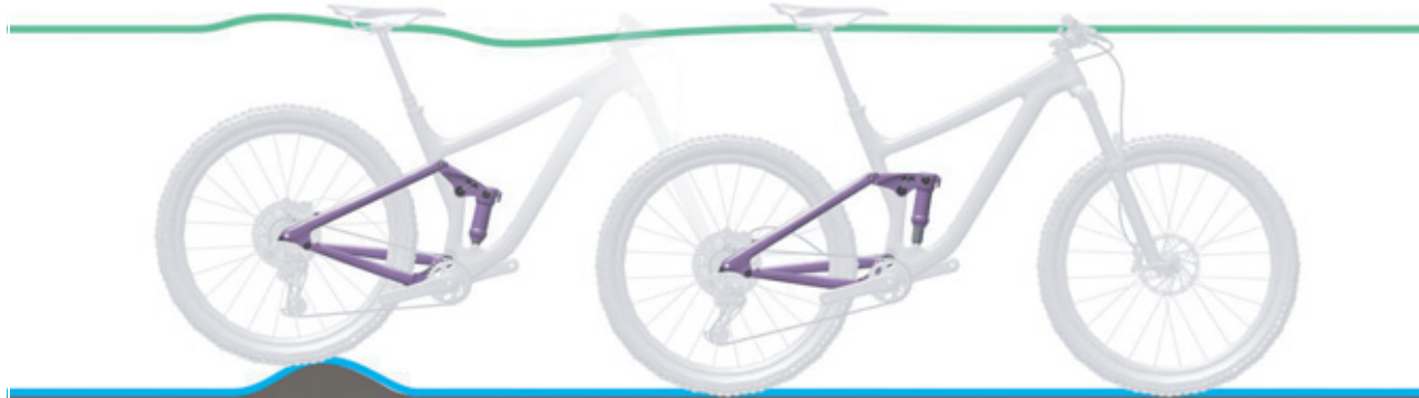
Obr. 105: Optimální chování tlumiče zadního odpružení při jízdě u nerovností
