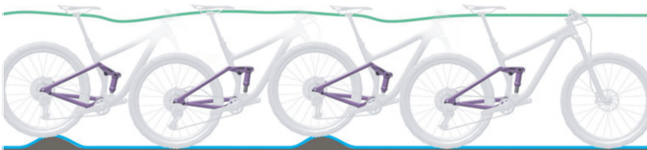
Obr. 18: Optimální chování tlumiče zadního odpružení při jízdě
