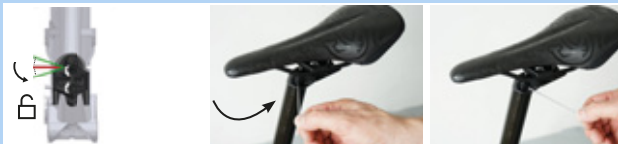
Obr. 155: Přesuňte ovladač nastavení výšky do polohy „Otevřeno“
