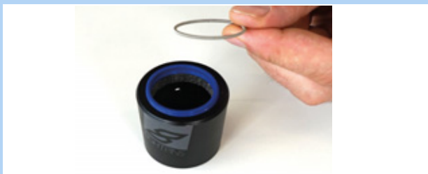
Obr. 199: Vyjmutí pružné podložky
