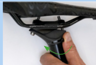
Obr. 211: Zavření nastavení výšky
