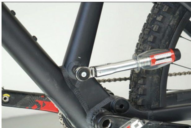
Obr. 72: Utažení osy sedlovky
