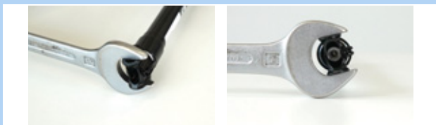
Obr. 176: Zabezpečení proti otáčení
