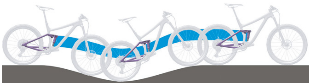
Obr. 19: Optimální chování tlumiče zadního odpružení při jízdě v kopcovitém terénu
