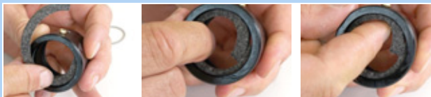
Obr. 168: Vložení plstěného kroužku
