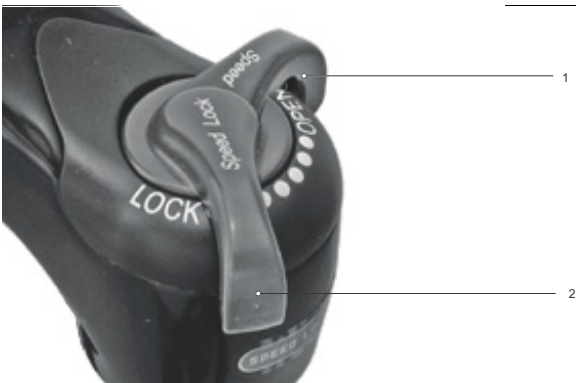
Obr. 224: Měkké nastavení nastavovacího šroubu komprese
