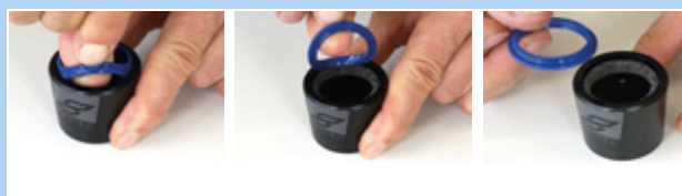
Obr. 165: Vytažení stíracího kroužku
