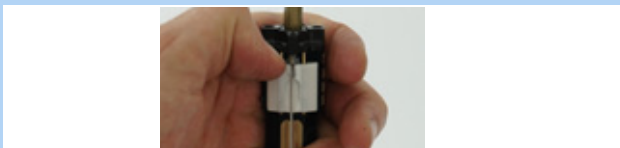
Obr. 181: Posunutí bílého ovládacího šoupátka dolů
