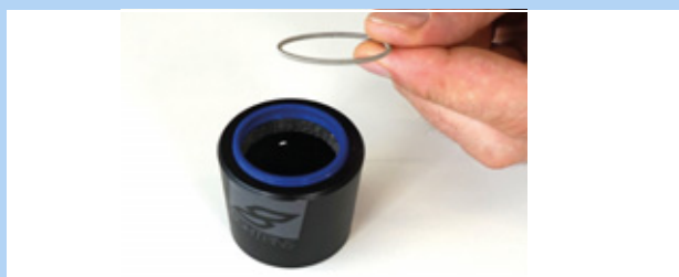
Obr. 164: Vyjmutí pružné podložky
