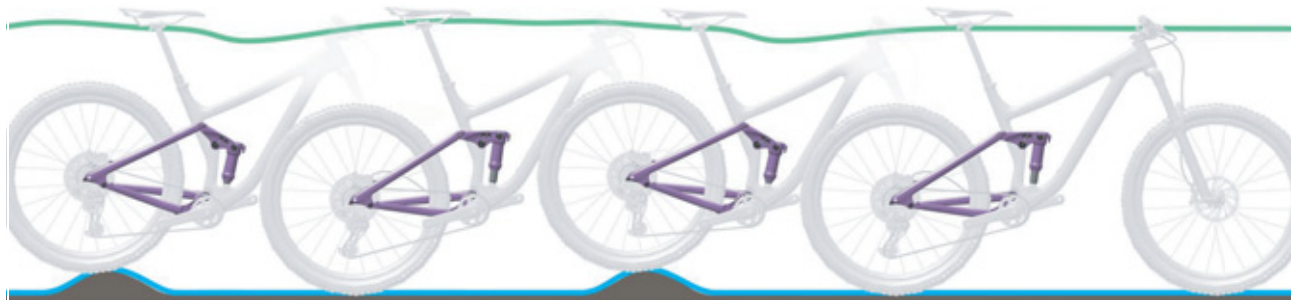
Obr. 103: Optimální chování tlumiče zadního odpružení při jízdě
