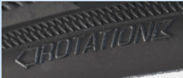
Obr. 48: Šipka označující směr jízdy
