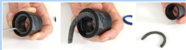
Obr. 166: Odstranění plstěného kroužku
