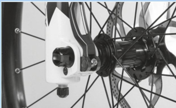
Obr. 152: Nastavení upínací síly rychloupínáku
