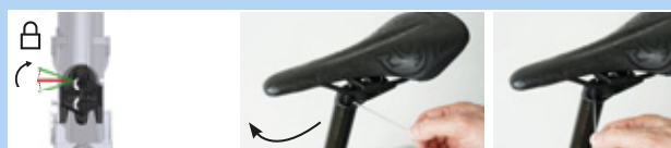
Obr. 192: Zavření nastavení výšky
