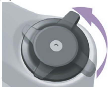
Obr. 133: Měkké nastavení nastavovacího šroubu komprese
