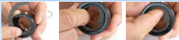
Obr. 203: Vložení plstěného kroužku
