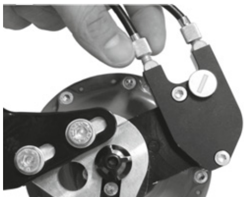
Obr. 148: Náboje Rohloff s externím ovládním řazení mají seřizovače napnutí na lanovodu, který je umístěn na levé straně
