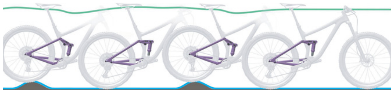
Rysunek 18: Optymalne działanie tylnego amortyzatora
