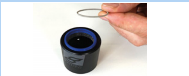
Rysunek 221: Wyciągnięty pierścień sprężysty
