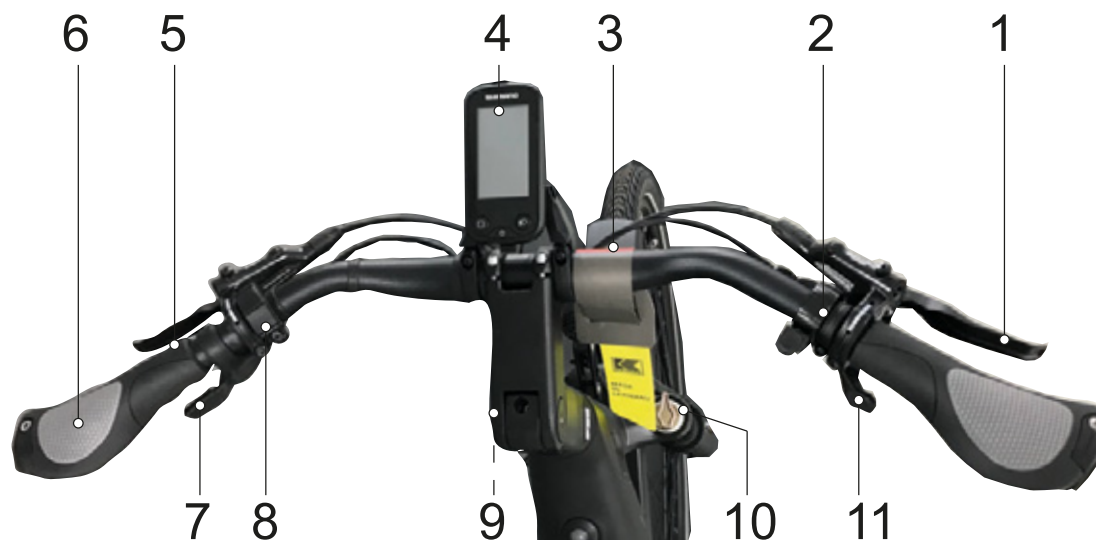
Rysunek 38: Widok szczegółowy kierownicy z komputerem pokładowym SC-E5003 firmy SHIMANO
