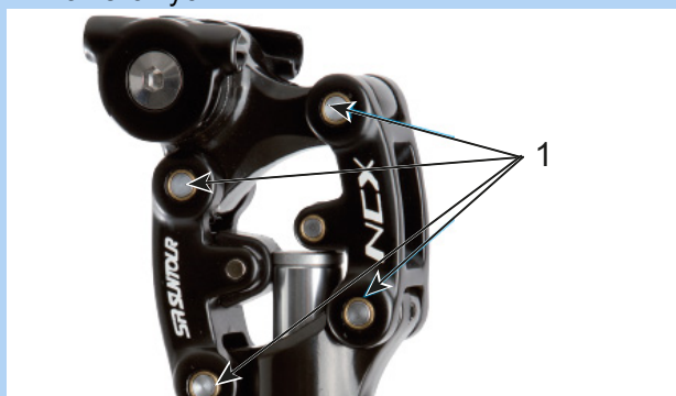
Rysunek 176: Punkty smarowania amortyzowanej sztycy podsiodłowej Suntour SR
