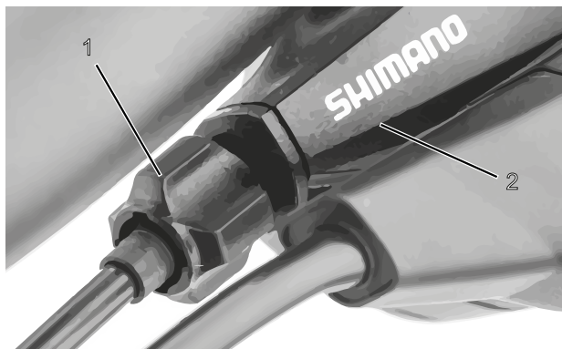
Rysunek 171: Nakrętka regulacyjna (1) jednoczęściowego mechanizmu zmiany przerzutek z obudową dźwigni zmiany biegów (2), przykład
