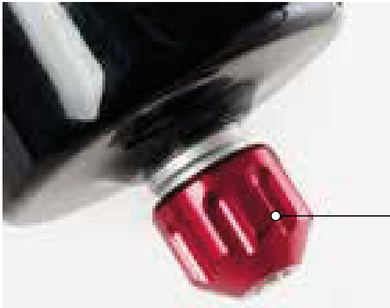
Rysunek 111: Przykładowy nastawnik odbicia Suntour (1)
