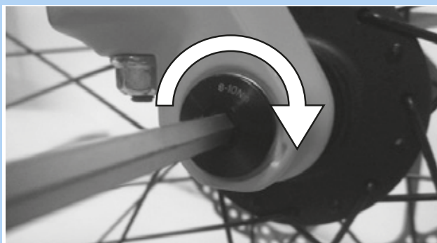
Rysunek 52: Dokręcić oś zgodnie z kierunkiem strzałki
