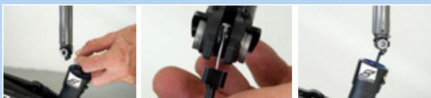
Rysunek 235: Zaczepianie i wsuwanie sztycy podsiodłowej
