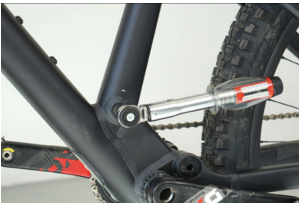
Rysunek 72: Dociąganie osi sztycy podsiodłowej
