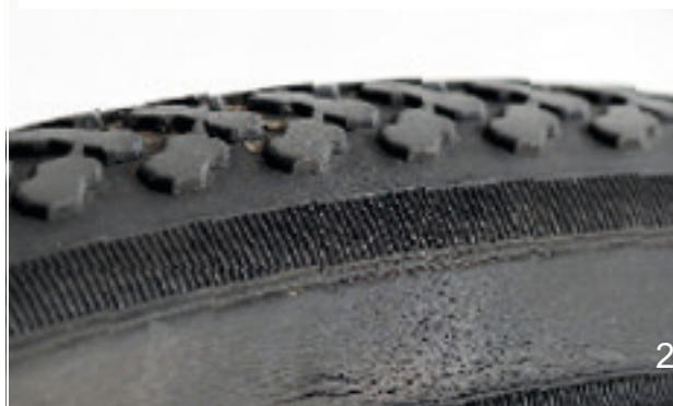
Rysunek 165: Przykłady pęknięć zmęczeniowych (1) i w wyniku starzenia się (2)
