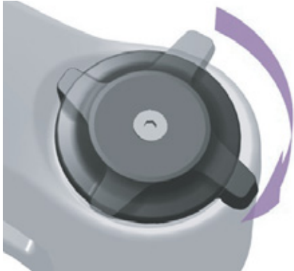
Rysunek 150: Ustawienie nastawnika dobiecia na twardszy tryb pracy
