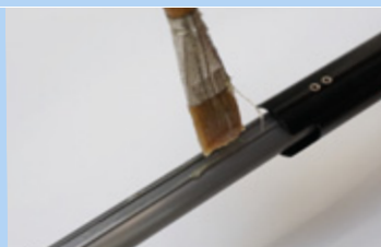
Rysunek 231: Nakładanie smaru
