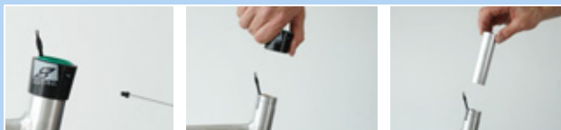
Rysunek 185: Demontaż tulei zewnętrznej i tulei ślizgowej
