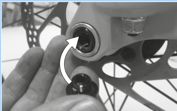
Rysunek 53: Sposób wsuwania dźwigni zacisku szybkomocującego w oś
