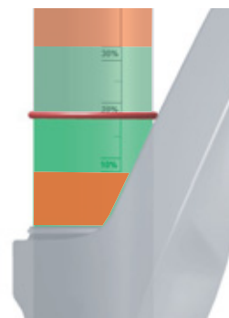
Rysunek 97: Zalecany zakres parametru SAG (zielony) i zakazany zakres parametru SAG (czerwony)
