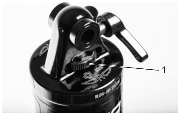
Rysunek 256: Nastawnik odbicia koła Suntour (1) na tylnym amortyzatorze
