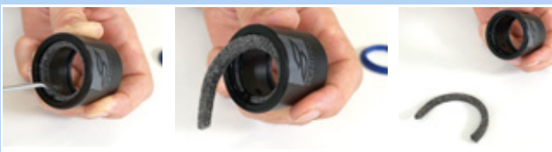
Rysunek 223: Wyciąganie pierścienia filcowego
