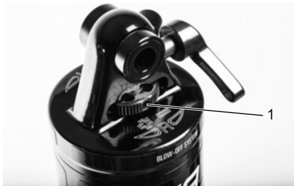
Rysunek 258: Nastawnik odbicia koła Suntour (1) na tylnym amortyzatorze
