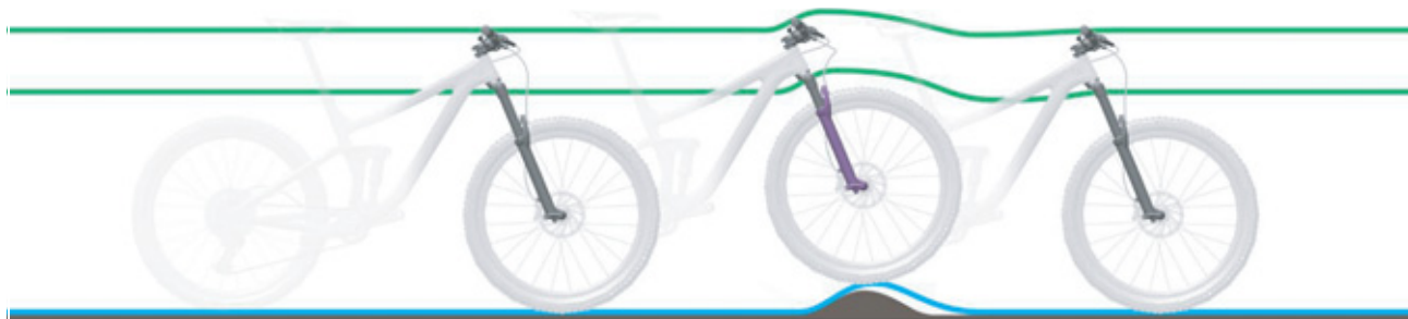
Rysunek 253: Zbyt twarde tłumienie widelca amortyzowanego na nierównościach
