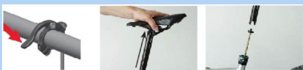
Rysunek 178: Wyciąganie sztycy podsiodłowej
