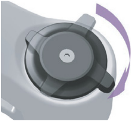
Figura 132: Ajuste para un regulador de niveles de presión más duro
