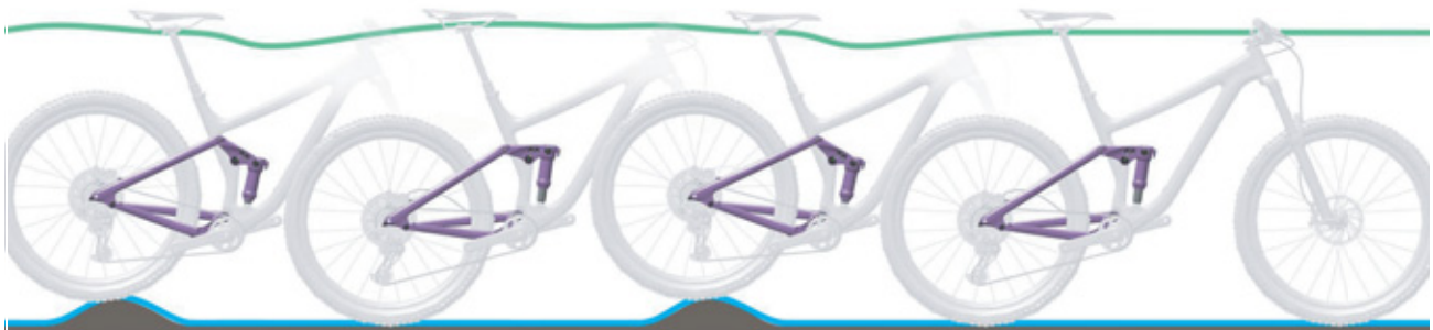
Figura 103: Condición óptima de marcha del amortiguador de la horquilla trasera
