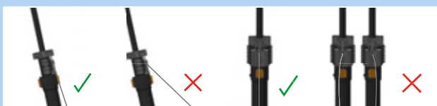
Figura 182: Cable Bowden correcto e incorrecto
