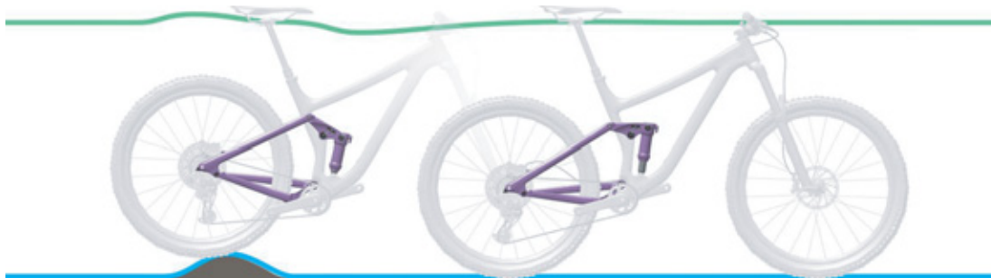
Figura 17: Condición óptima de marcha del amortiguador de la horquilla trasera en caso de irregularidades
