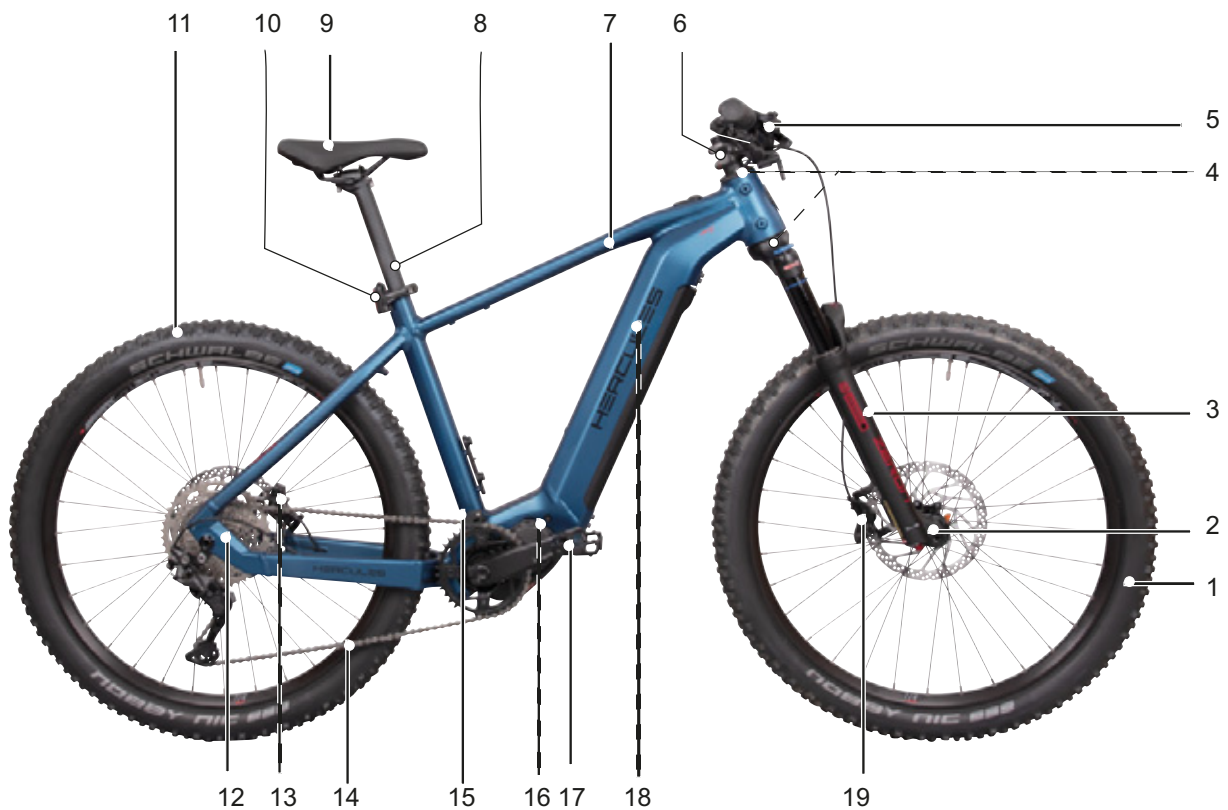
Figura 2: Pedelec visto desde el lado derecho
