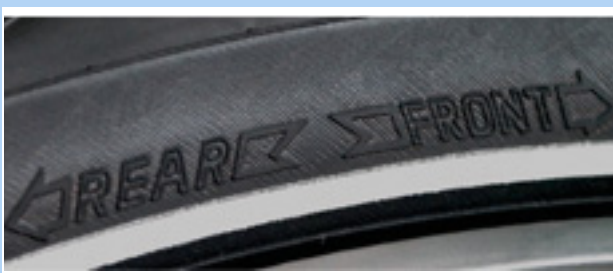
Figura 49: Flecha de sentido de la marcha en cubiertas de MTB
