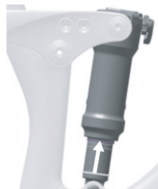
Figura 100: Desplazamiento de la junta tórica en el amortiguador de la horquilla trasera
