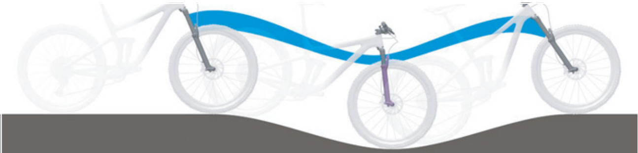
207. ábra: A teleszkópos villa túl puha rugózása hegymenetben
