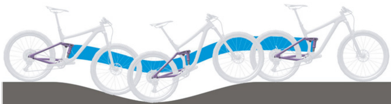
20. ábra: A hátsó lengéscsillapító optimális menetviselkedése dombos terepen
