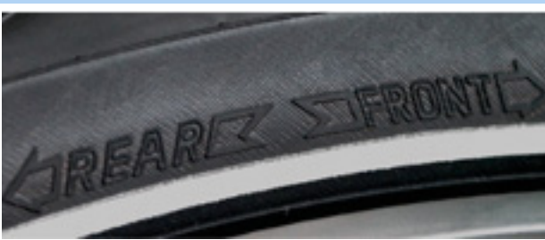
70. ábra: Futásirányjelző nyíl MTB gumiabroncsokon
