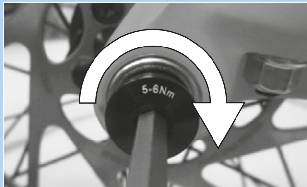
74. ábra: A rögzítőcsavar meghúzása
