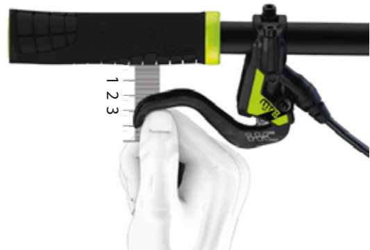
127. ábra: Kézifék pozicionálása
