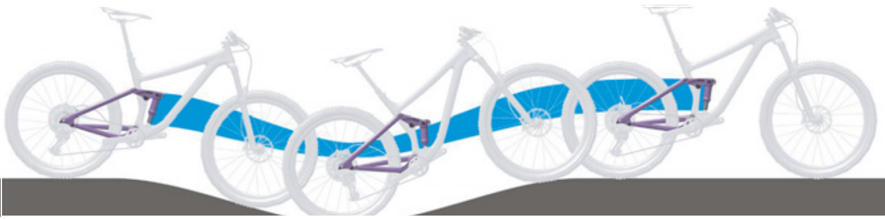
223. ábra: A hátsó lengéscsillapító túl puha rugózása hegymenetben
