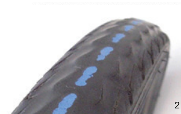
168. ábra: Profil nélküli gumiabroncs, amelyet cserélni lehet (1), és gumiabroncs áttetsző defektvédelemmel (2), amelyet cserélni kell
