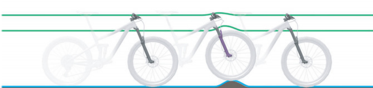
11. ábra: A villa optimális menetviselkedése egyenetlenségek esetén
