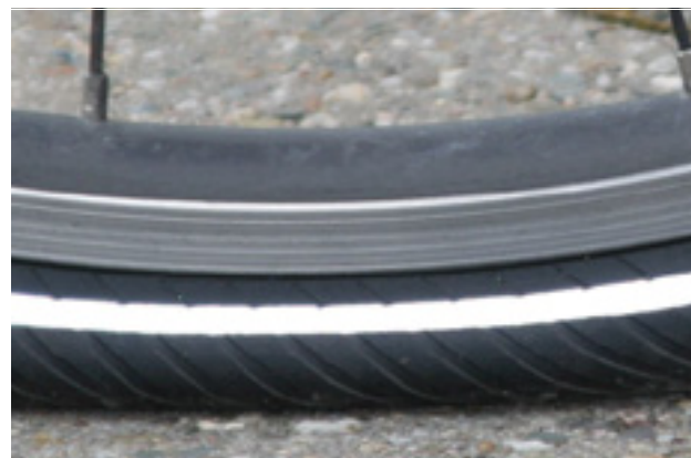
123. ábra: Túlontúl alacsony töltőnyomás
