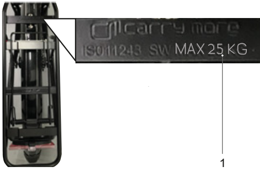
145. ábra: A csomagtartón fel van tüntetve maximális teherbírása (1)
