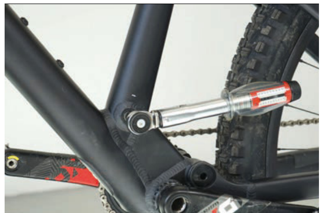
106. ábra: A nyeregcsőtengely meghúzása
