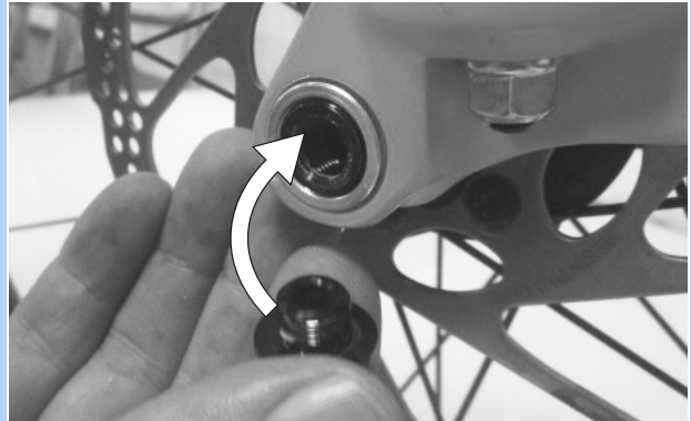
73. ábra: Rögzítőcsavar beszerelése
