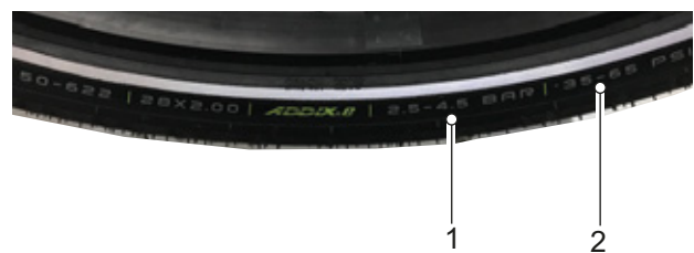
Figura 164: Pressione di gonfiaggio in bar (1) e in psi (2)
