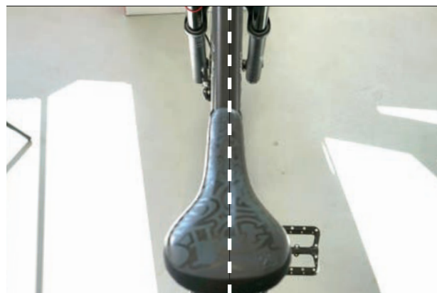
Figura 95: Posizionamento della sella in direzione di marcia
