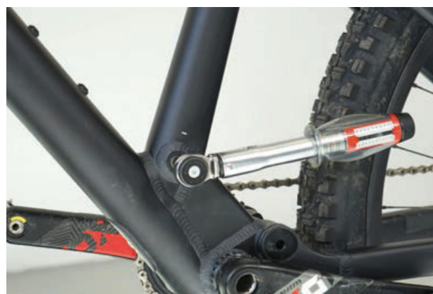
Figura 96: Serraggio dell'asse del canotto reggisella
