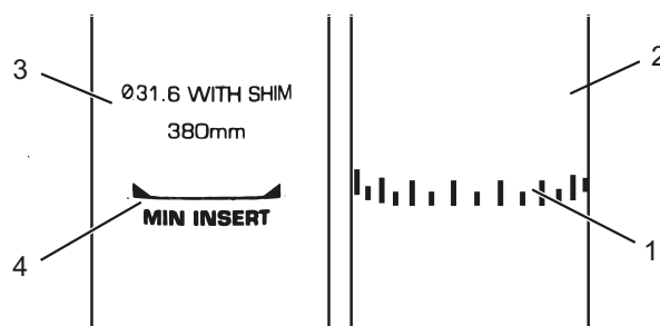
Figura 99: Particolare dei cannotti reggisella, esempi di segno indicante la minima profondità di inserimento
