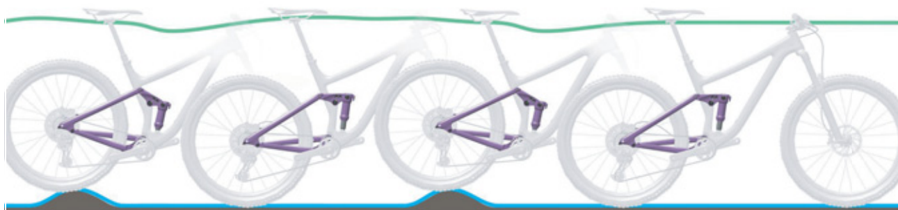
Figura 124: Comportamento di marcia ottimale dell'ammortizzatore del carro posteriore
