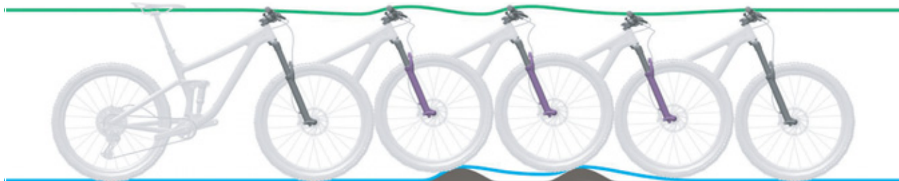
Figura 201: Corsa di estensione troppo lenta della forcella ammortizzata
