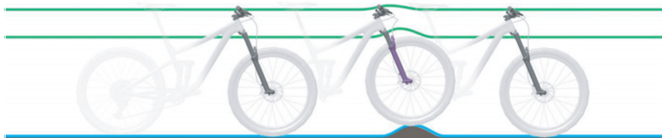
Figura 152: Comportamento di marcia ottimale su un terreno con asperità
