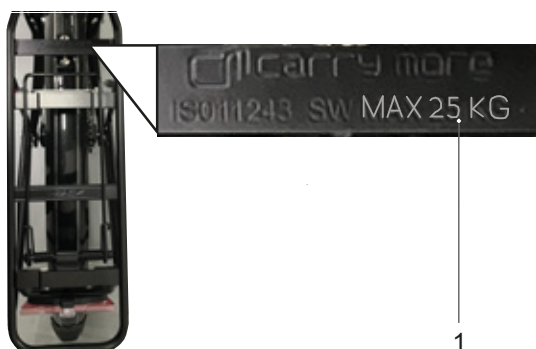
Figura 141: Sul portapacchi è indicata la sua portata massima (1)
