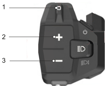
Figura 134: Ubicazione interruttore a bilico (1), pulsante più (2) e pulsante meno (3)
