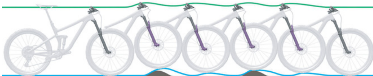
Figura 215: Corsa di estensione troppo veloce della forcella ammortizzata
