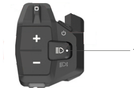
Figura 149: Ubicazione del pulsante luce di marcia
