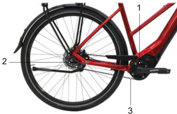
Figura 32: Schema della trasmissione a cinghia
