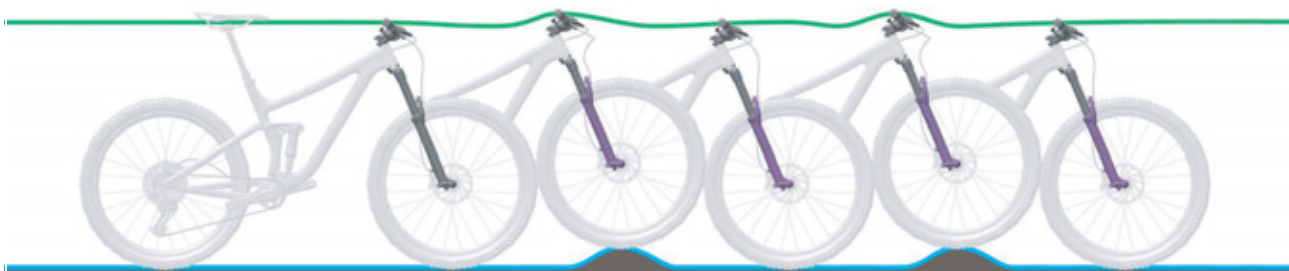
Obr. 104: Optimální chování vidlice při jízdě
