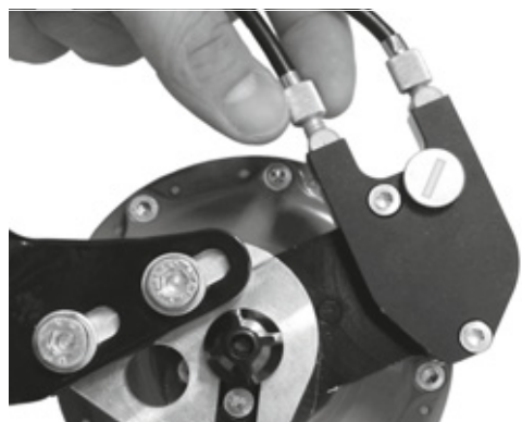
Obr. 144: Náboje Rohloff s externím ovládním řazení mají seřizovače napnutí na lanovodu, který je umístěn na levé straně
