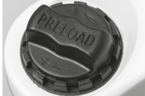
64. ábra: A negatív rugóút beállító kereke a teleszkópos villa koronáján
