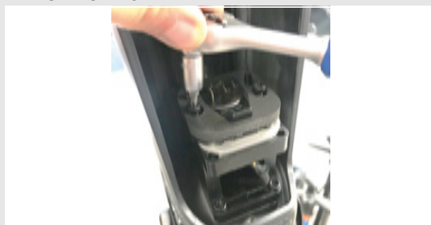
26. ábra: Akkumulátortartó csavarok oldása
