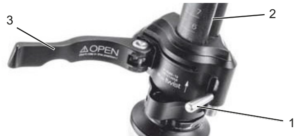
81. ábra: A kormányszár-gyorszár (3) nyitott gyorskioldója a kormányszáron (2), I kivitel, a kormányszáron (1) lévő rögzítőkarral
