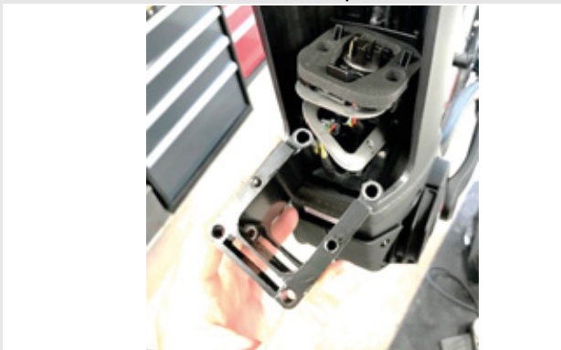
29. ábra: A PowerTube adapter kihúzása
