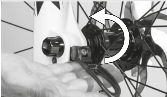
41. ábra: A kar rögzítése
