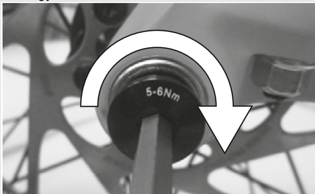
35. ábra: A rögzítőcsavar meghúzása
