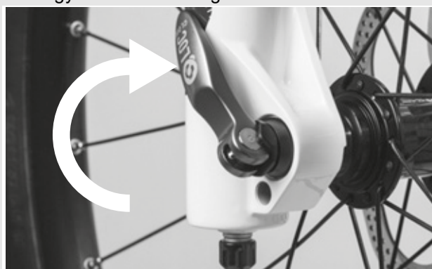
47. ábra: A gyorszár zárása
