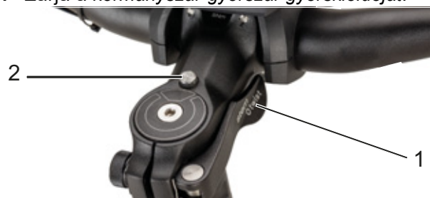
82. ábra: II kivitelű kormányszár a kormányszár-gyorszár (1) gyorskioldójával és reteszelésoldó gombbal (2)
