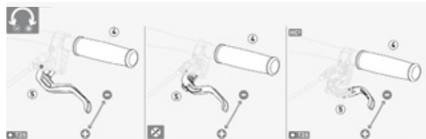
62. ábra: Magura tárcsafék fékkar markolási szélességének beállítása
