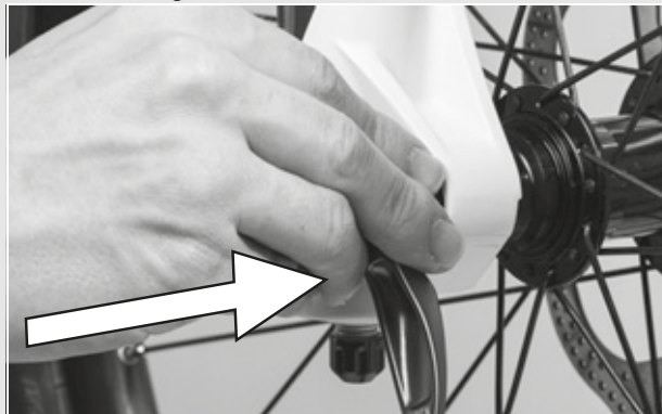
45. ábra: A gyorszár betolása
