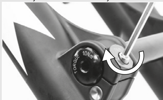
37. ábra: A rögzítőkapcs meghúzása
