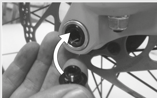
34. ábra: A gyorskioldó kar betolása a tengelybe
