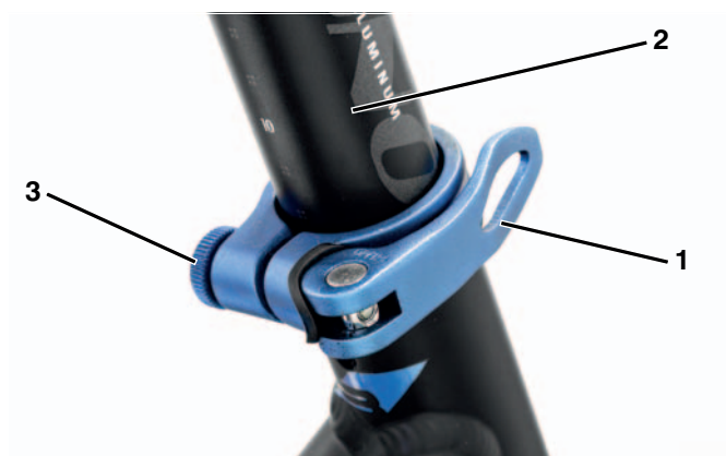
Billede 19: Sadelpindens hurtigbespænding i slutpositionen
