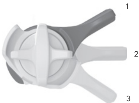
Afbeelding 74: FOX-drukdemperafsteller op de achterbouwdeemper met de standen OPEN (1), MIDDEL (2) en HARD (3)
