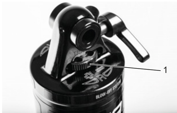
Afbeelding 61: Wiel (1) van de trekdemperafsteller Suntour op de achterbouwdemper
