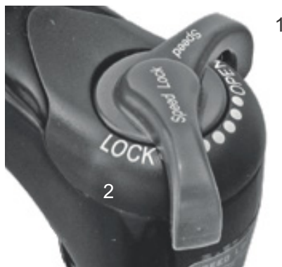
Afbeelding 76: Suntour-drukdemperafsteller met de standen OPEN (1) en LOCK (2)
