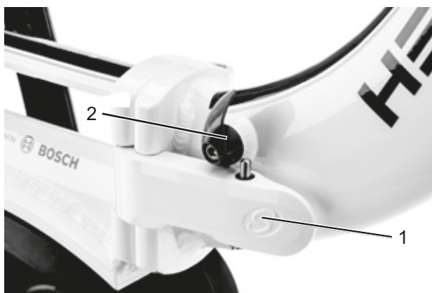
Afbeelding 43: Gesloten (1) en geopende (2) framevergrendelhendel
