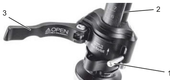
Afbeelding 41: Geopende spanhendel van de snelspanner (3) op de voorbouw (2), uitvoering I, met vergrendelhendel op de voorbouw (1)
