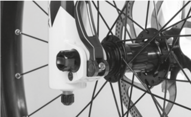
Afbeelding 48: Spankracht van de snelspanner afstellen
