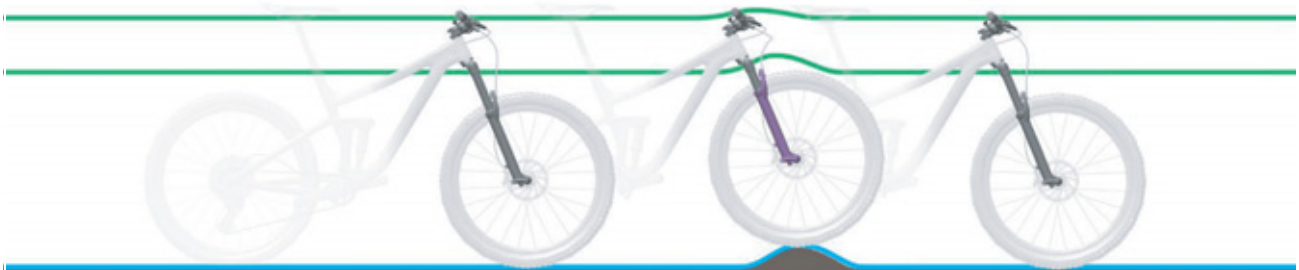
Afbeelding 7: Optimaal rijgedrag van de vork bij oneffenheden
