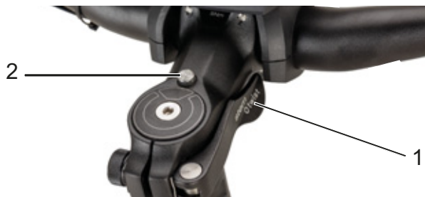
Afbeelding 42: Voorbouw, uitvoering II met spanhendel van de snelspanner van de voorbouw (1) en deblokkeringsknop (2)
