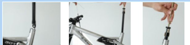
187. ábra: Tubus szelepfedél rögzítése
