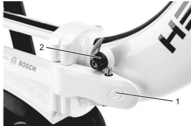
135. ábra: Zárt (1) és nyitott (2) váz-rögzítőkar
