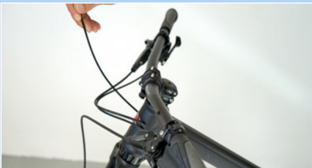
218. ábra: Végsapka beakasztása
