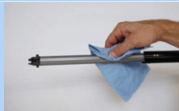
212. ábra: Hosszirányú vezetőhorny tisztítása
