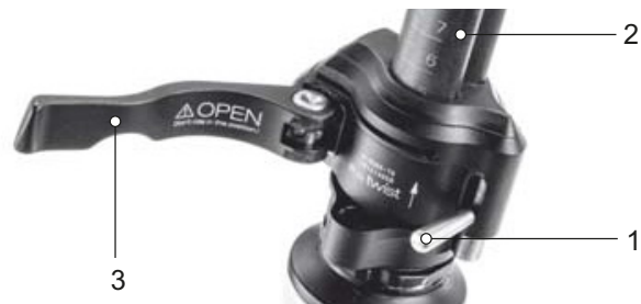
133. ábra: A kormányszár-gyorszár (3) nyitott gyorskioldója a kormányszáron (2), I kivitel, a kormányszáron (1) lévő rögzítőkarral
