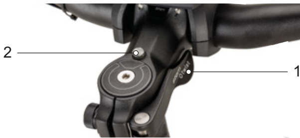
134. ábra: II kivitelű kormányoszár a kormányoszár-gyorszár (1) gyorskioldójával és reteszelésoldó gombbal (2)
