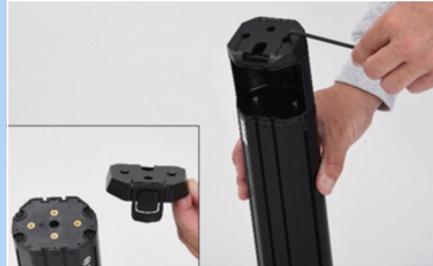
58. ábra: Akkumulátor-szerelőlemez csavaros rögzítése
