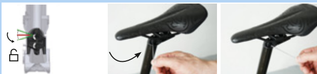
159. ábra: A magasságállító működtető beállítása „nyitott” állásba
