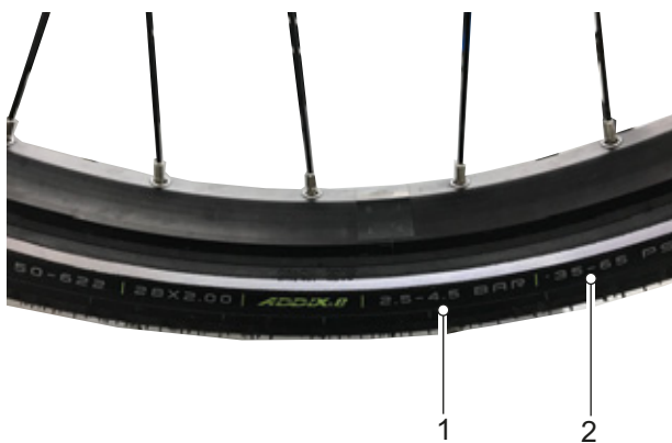
145. ábra: Guminyomás bar-ban (1) és psi-ben (2)
