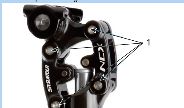
158. ábra: SR kenőpontok Suntour rugós nyeregcső
