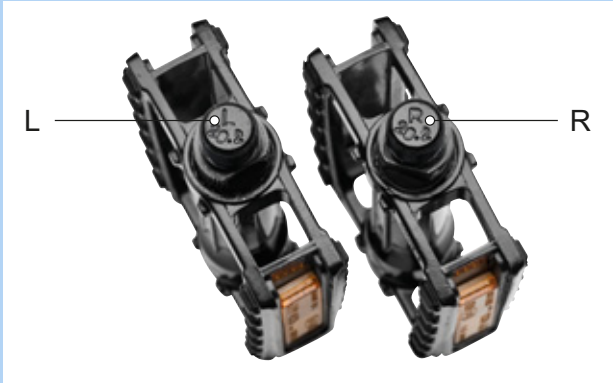
76. ábra: Példa: pedálok jelölése
