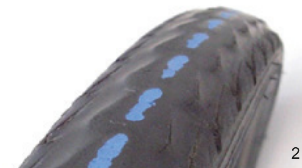
146. ábra: Profil nélküli gumiabroncs, amivel még kerékpározni lehet (1), és cserélendő gumiabroncs áttetsző defektvédelemmel (2)
