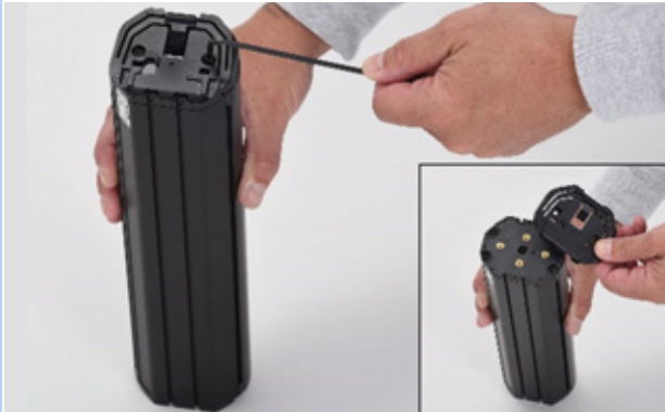
53. ábra: A felső csatlakozó felület kiszérése
