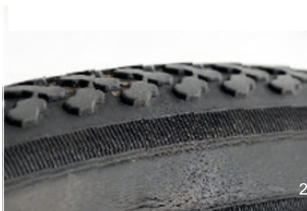
147. ábra: Példák kifáradási repedésekre (1) és öregedési repedésekre (2)
