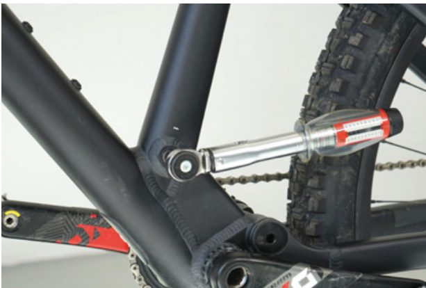
81. ábra: A nyeregcsőtengely meghúzása
