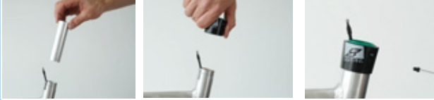
216. ábra: Siklópersely és külső hüvely beépítése
