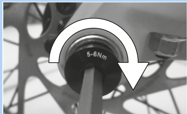
65. ábra: A rögzítőcsavar meghúzása
