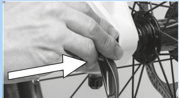
73. ábra: A gyorsár betolása nyilirányban
