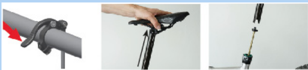
160. ábra: A nyeregcső kihúzása
