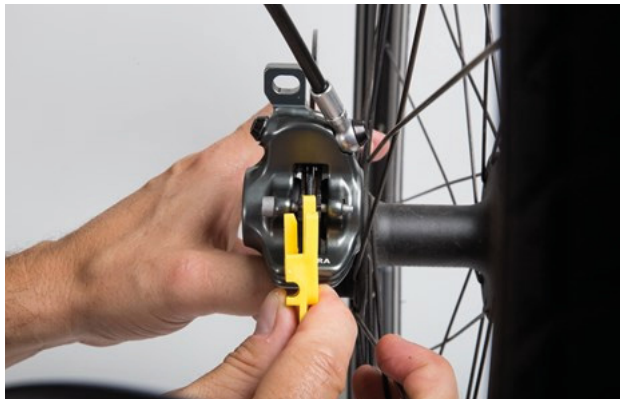
148. ábra: Fékbetét ellenőrzése beépített állapotban a szállítási rögzítés segítségével
