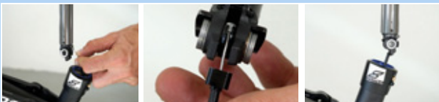
217. ábra: A nyeregcső felakasztása és betolása
