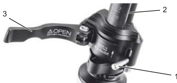
Afbeelding 57: Geopende spanhendel van de snelspanner (3) op de voorbouw (2), uitvoering I, met vergrendelhendel op de voorbouw (1)
