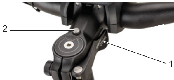
Afbeelding 58: Voorbouw, uitvoering II met spanhendel van de snelspanner van de voorbouw (1) en deblokkeringsknop (2)
