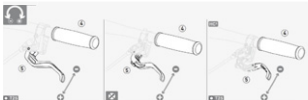
Afbeelding 36: Grijpafstand Magura schijfremhendel afstellen
