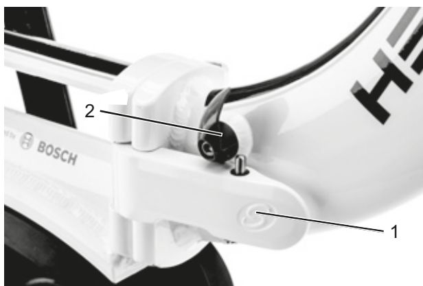
Afbeelding 59: Gesloten (1) en geopende (2) framevergrendelhendel
