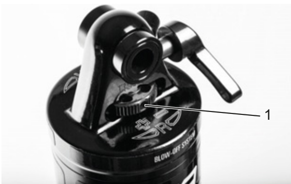
Afbeelding 42: Wiel (1) van de Suntour trekdemperafsteller op de achterbouwdemper
