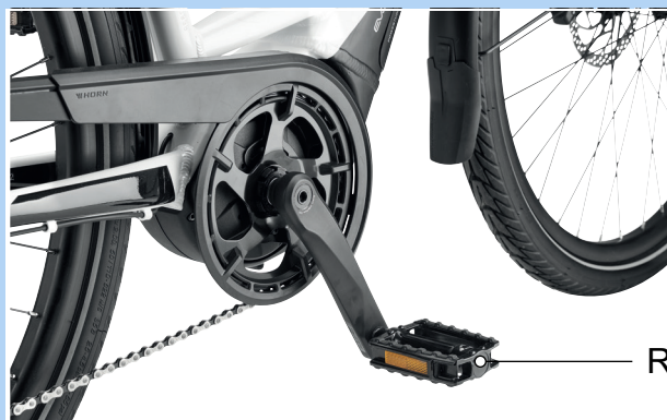
Abbildung 71: R-Pedal im rechten Kurbelarm
