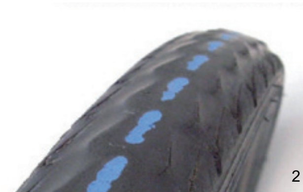
Abbildung 139: Reifen ohne Profil, der gewechselt werden kann (1), und Reifen mit durchscheinendem Pannenschutz (2), der gewechselt werden muss
