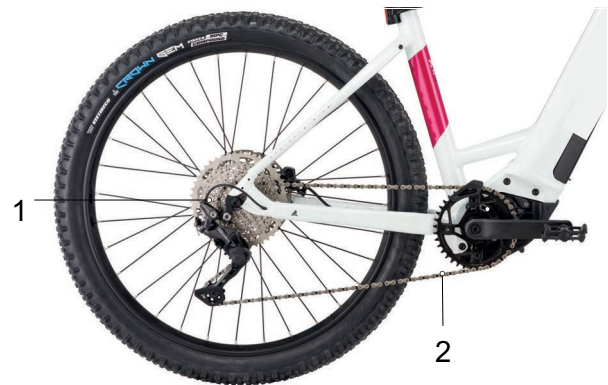
Abbildung 29: Schema Kettenantrieb mit Kettenschaltung
