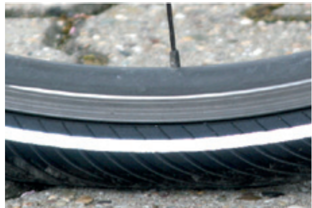
Abbildung 91: Korrekter Fülldruck. Der Reifen ist unter der Last des Körpergewichts kaum verformt.
