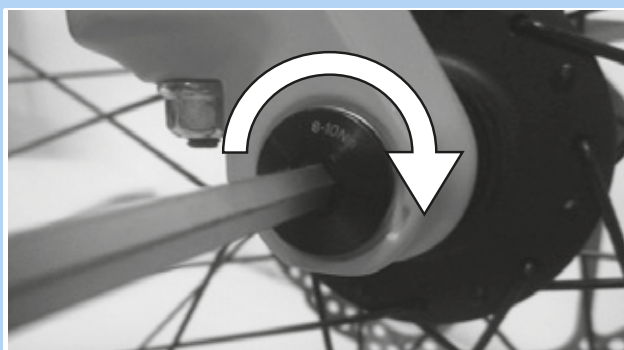
Figura 63: Apriete del eje en la dirección de la flecha
