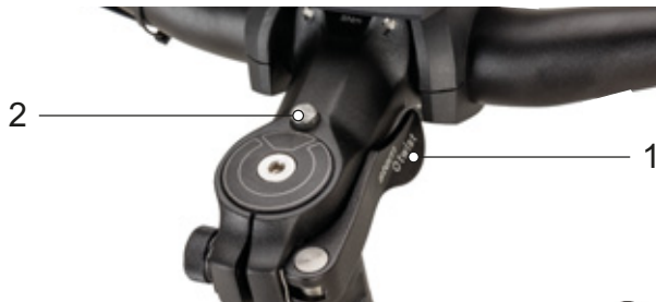
Figura 134: Potencia, versión II con palanca tensora del cierre rápido de la potencia (1) y botón de desbloqueo (2)
