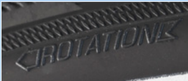
Figura 60: Flecha de sentido de la marcha
