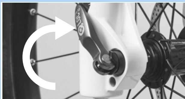
Figura 75: Cierre del cierre rápido
