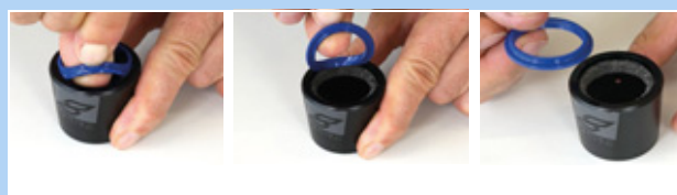
Figura 169: Extracción del rascador
