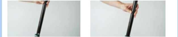
Figura 194: Desplazamiento hacia abajo de la tija de sillín
