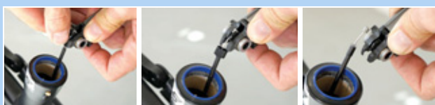
Figura 200: Retirada del cable Bowden
