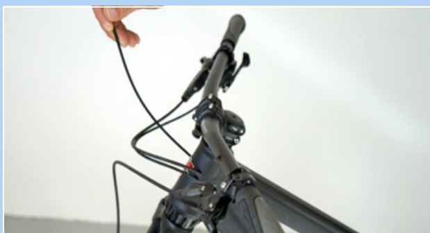
Figura 218: Enganchar la tapa del extremo
