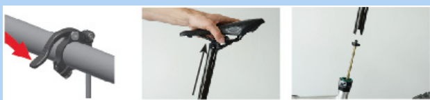
Figura 160: Extracción de la tija de sillín
