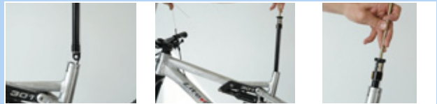
Afbeelding 194: Ventieldop van de patroon aanbrengen
