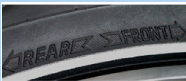
Afbeelding 53: Pijl draairichting op MTB-banden
