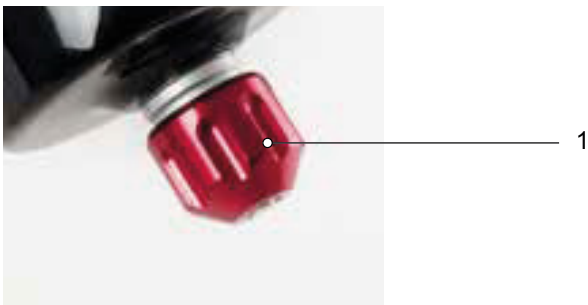
Afbeelding 229: Suntour trekdemper schroef (1)
