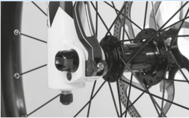
Afbeelding 62: Perfecte stand van de spanhendel
