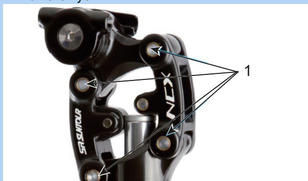
Rysunek 168: Punkty smarowania amortyzowanej sztycy podsiodłowej Suntour SR
