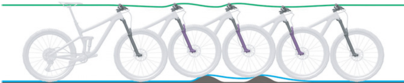
Rysunek 233: Zbyt wolne rozprężanie widelca amortyzowanego
