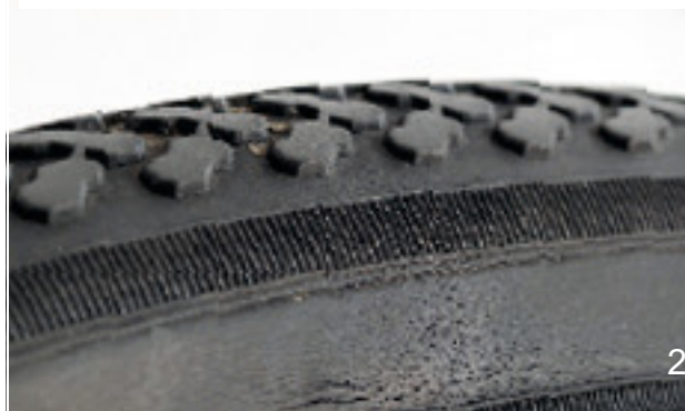
Rysunek 157: Przykłady pęknięć zmęczeniowych (1) i w wyniku starzenia się (2)
