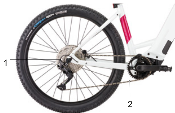
Rysunek 26: Schemat napędu łańcuchowego z przerzutką
