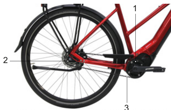
Rysunek 27: Schemat napędu paskowego
