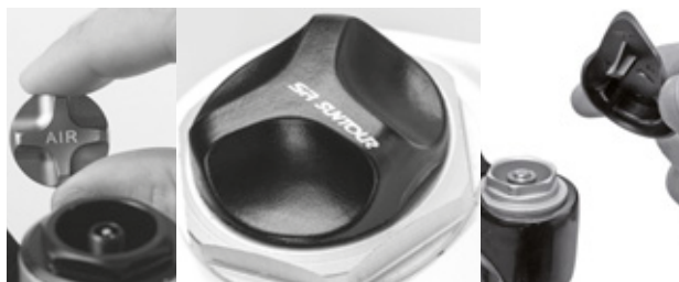
Rysunek 119: Oslony gwintowane dostępne w różnych wersjach
