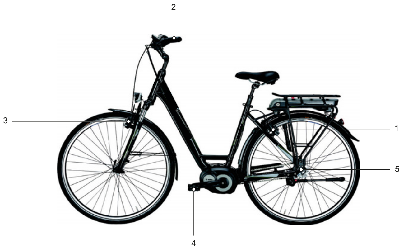
Rysunek 22: Układ hamulcowy wyposażony w hamulec nożny – przykład
