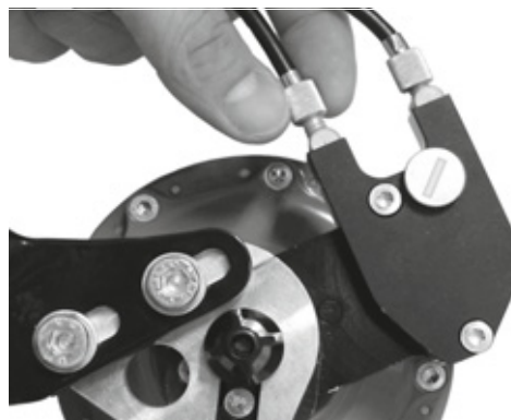
Rysunek 162: Wersje piast Rohloff z zewnętrznym sterowaniem zmiany biegów mają regulator linki na przepustnicy kablowej, która znajduje się po lewej stronie
