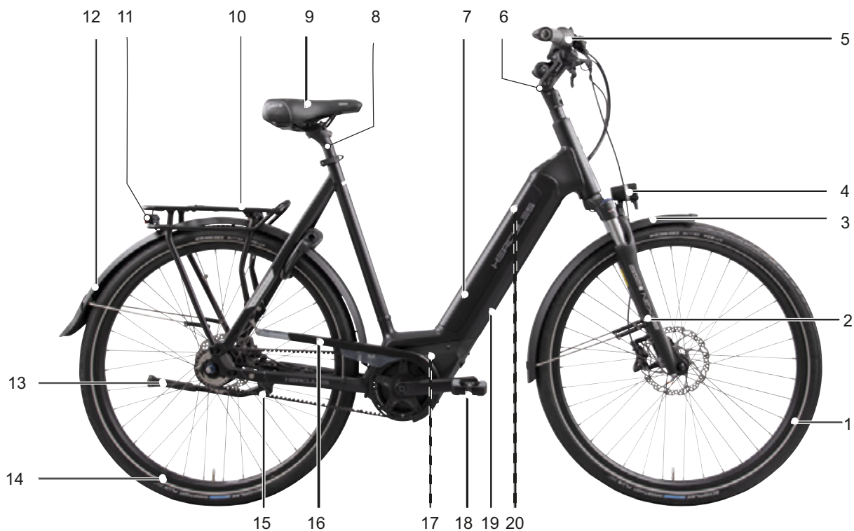
Rysunek 2: Rower typu Pedelec z prawej, przykład HERCULES E-Imperial I-R5
