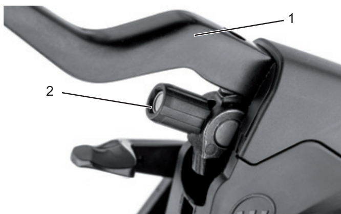
Figura 76: Leva del freno (1) del freno a pattino ad azionamento idraulico con vite di regolazione (2)
