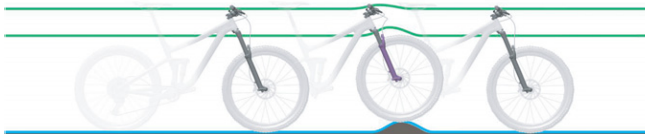
Figura 130: Comportamento di marcia ottimale su un terreno con asperità
