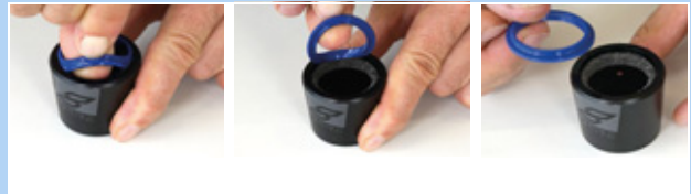
Figura 165: Estrazione del parapolvere
