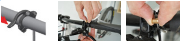
Figura 157: Smontaggio della cartuccia
