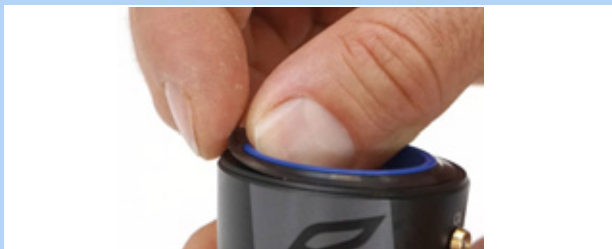
Figura 198: Estrazione dell'anello a labbro di tenuta
