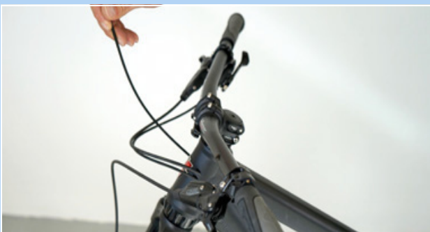
Figura 214: Aggancio del cappuccio terminale
