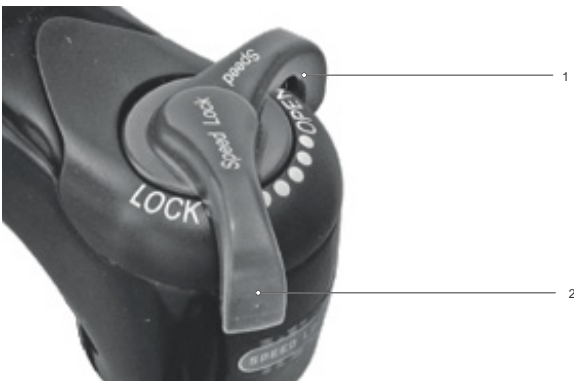
Figura 222: Regolazione più rigida del regolatore dello stadio di compressione
