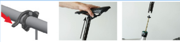
Figura 156: Estrazione del cannotto reggisella
