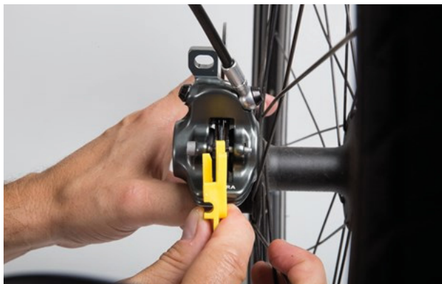
Figura 144: Controllo della guarnizione del freno nello stato montato mediante la sicura di trasporto
