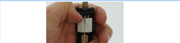
Figura 181: Spinta del cursore di azionamento bianco verso il basso
