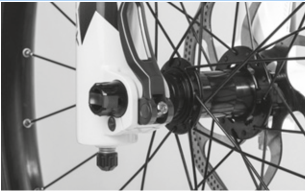
Figura 58: Corretta posizione della leva di serraggio
