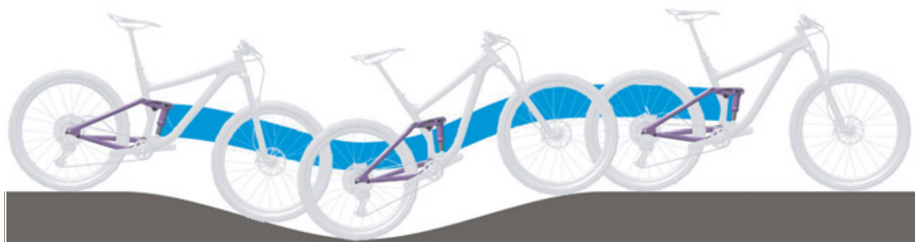
Figura 19: Comportamento di marcia ottimale dell'ammortizzatore del carro posteriore su un terreno con dossi
