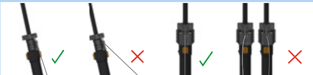
Figura 182: Cavo meccanico corretto ed errato
