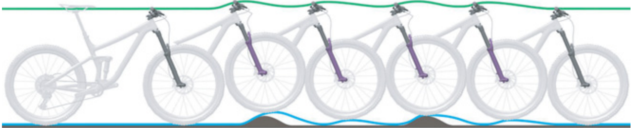
Figura 217: Corsa di estensione troppo veloce della forcella ammortizzata
