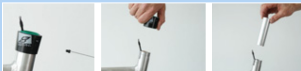
Figura 197: Smontaggio della boccola esterna e del manicotto scorrevole
