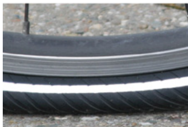
Figura 89: Pressione di gonfiaggio insufficiente
