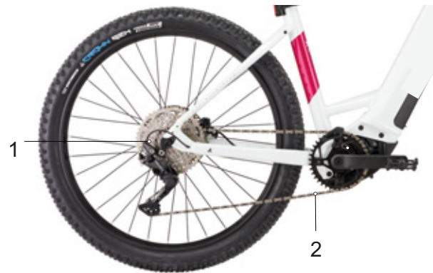
Figura 32: Schema della struttura a catena con cambio a catena
