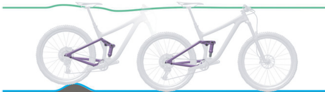
Figura 105: Comportamento di marcia ottimale dell'ammortizzatore del carro posteriore su asperità
