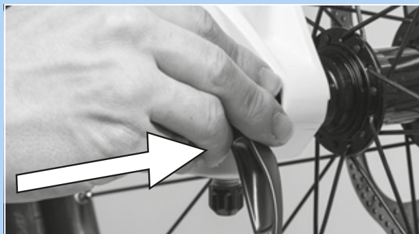
Figura 61: Inserimento del bloccaggio rapido nel verso della freccia
