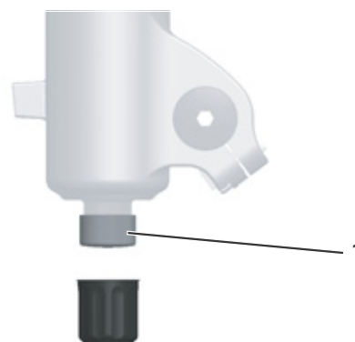
Figura 54: Regolatore del rebound FOX (1) sulla forcella
