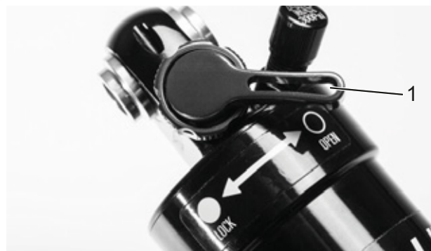
Figura 66: Regolatore della compressione Suntour aperto (1)
