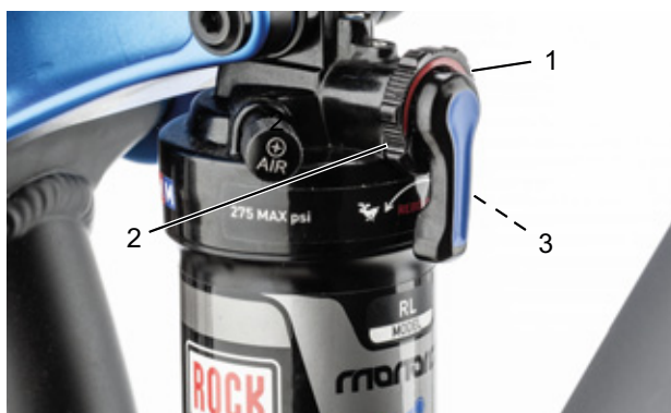
Figura 68: Regolazione della rigidità dell'ammortizzatore a stadi di trazione con la manopola di regolazione (1) dell'ammortizzatore del carro posteriore
