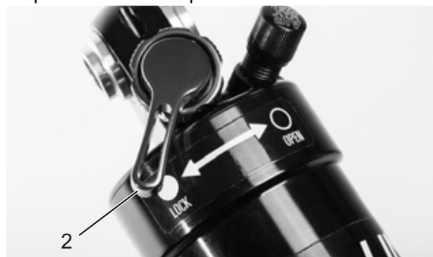
Figura 67: Regolatore della compressione Suntour chiuso (2)
