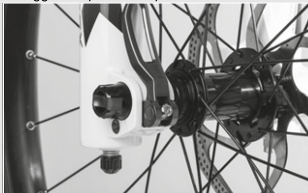
Figura 30: Corretta posizione della leva di serraggio
