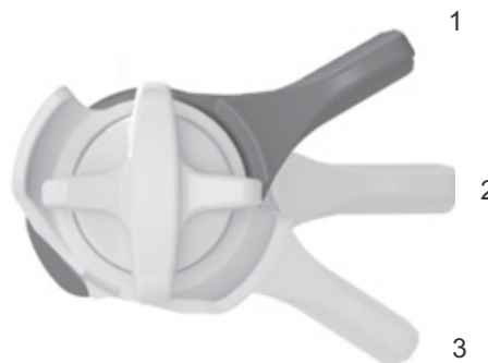
Figura 63: Regolatore della compressione FOX sull'ammortizzatore del carro posteriore con le posizioni APERTO (1), MEDIO (2) e RIGIDO (3)
