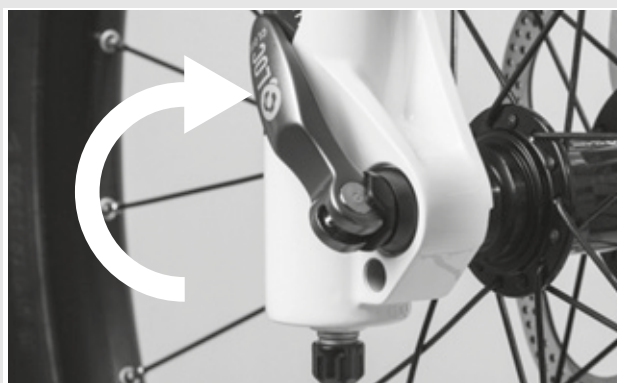
Figura 35: Chiusura del bloccaggio rapido
