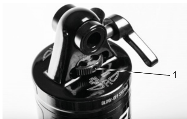
Figura 55: Regolatore del rebound Suntour (1) sull'ammortizzatore del carro posteriore
