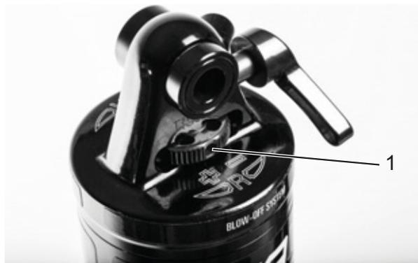
Illustration 42 : Molette de réglage de la détente Suntour (1) sur l'amortisseur arrière
