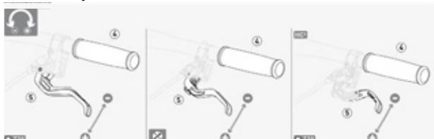
Illustration 36 : Régler la garde d'un levier de frein à disque Magura
