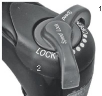
Illustration 52 : Dispositif de réglage de la compression Suntour avec les positions OPEN (1) et LOCK (2)
