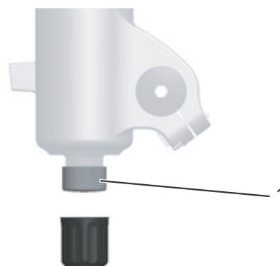
Illustration 41 : Dispositif de réglage de la détente FOX (1) sur l'extrémité de fourche
