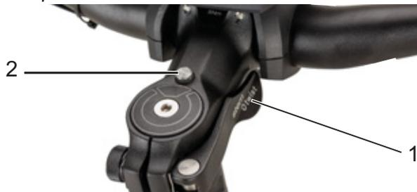
Illustration 58 : Potence, modèle II avec levier de serrage de l'attache rapide de la potence (1) et bouton de déblocage (2)
