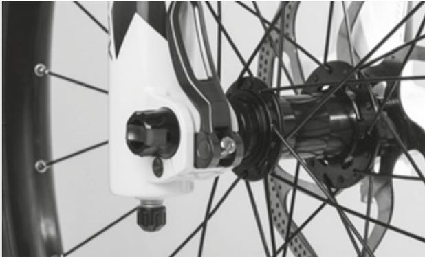
Illustration 64 : Régler la force de serrage de l'attache rapide
