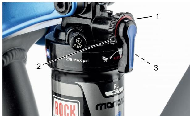
Abbildung 85: Härte des Zugstufen-Dämpfers am Einstellrad (1) des Hinterbau-Dämpfer einstellen
