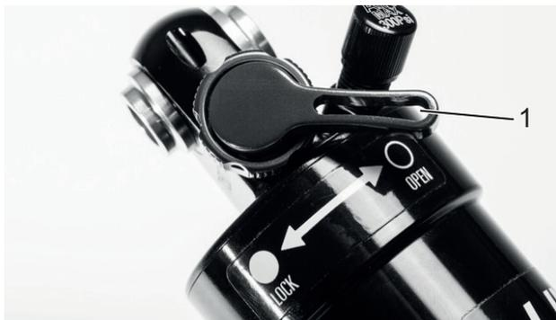
Abbildung 83: Suntour-Druckstufeneinsteller geöffnet (1)
