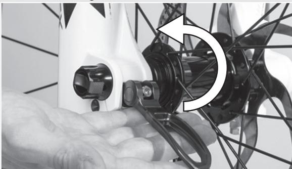
Abbildung 36: Hebel sichern
