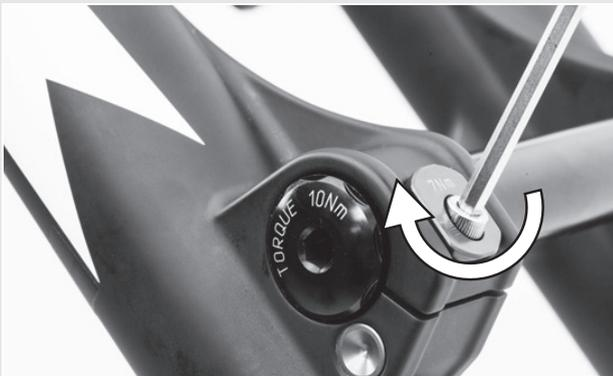
Abbildung 32: Sicherheitsklemme anziehen
