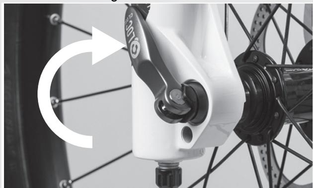
Abbildung 42: Schnellspanner schließen
