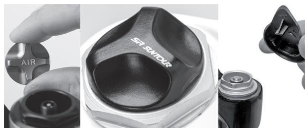
Abbildung 60: Schraubabdeckungen in unterschiedlichen Ausführungen
