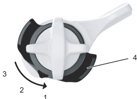
Abbildung 81: Feineinstellung der OFFENEN Position erfolgt durch den Einsteller (4)
