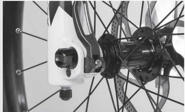
Abbildung 37: Perfekte Lage des Spannhebels
