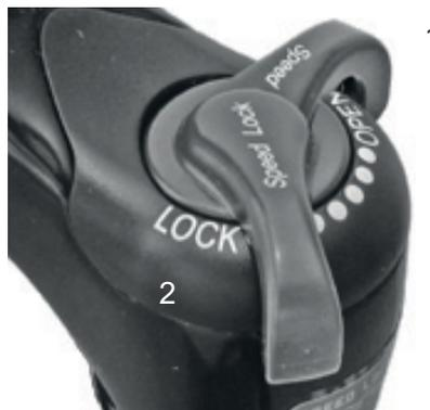
Abbildung 82: Suntour-Druckstufeneinsteller mit den Positionen OPEN (1) und LOCK (2)
