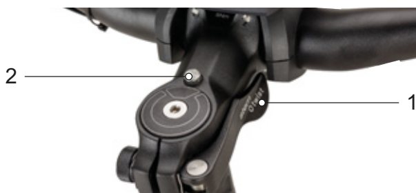
Illustration 136 : Potence, modèle II avec levier de serrage de l'attache rapide de la potence (1) et bouton de déblocage (2)
