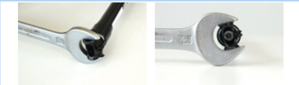
Illustration 182 : Empêcher l'interface de montage de tourner
