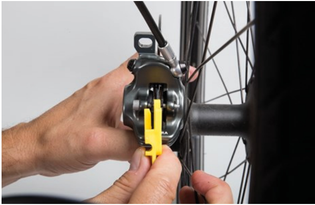
Illustration 150 : Contrôler la plaquette de frein montée à l'aide de la cale de transport
