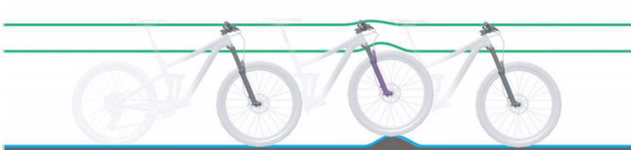
Illustration 128 : Comportement optimal sur les irrégularités
