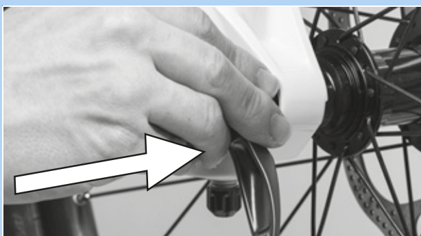
Illustration 73 : Enfoncez l'attache rapide dans le sens de la flèche
