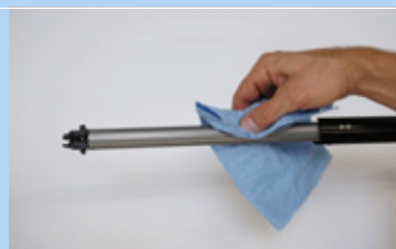
Illustration 214 : Nettoyer la rainure de guidage longitudinale
