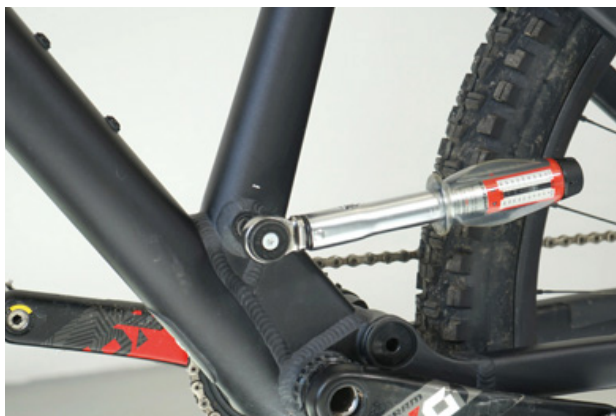
Illustration 81 : Serrer l'axe de la tige de selle
