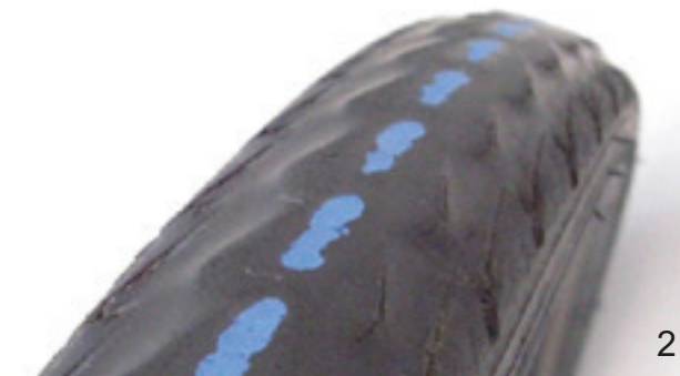
Illustration 148 : Pneu sans profil pouvant encore être utilisé (1) et pneu avec bande de protection visible (2) devant être changé
