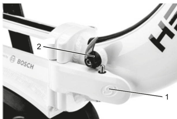
Illustration 137 : Levier de blocage du cadre fermé (1) et ouvert (2)
