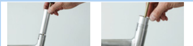
Illustration 192 : Insérer le tube de la douille de glissement dans le tube de selle
