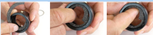
Illustration 209 : Insérer l'anneau de feutre
