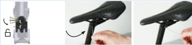
Illustration 161 : Placer le mécanisme de réglage de la hauteur en « position ouverte »
