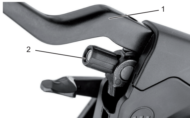
Figur 73: Bremsehåndtag (1) på den hydraulisk aktiverede fælgbremse med indstillingsskrue (2)
