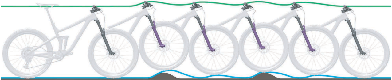
Abbildung 229: Zu schnelles Ausfedern der Federgabel
