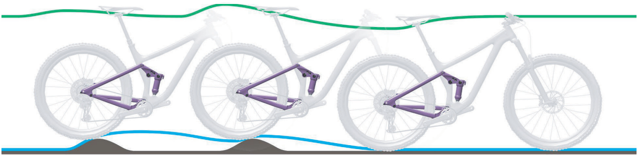
Abbildung 239: Zu langsames Ausfedern des Hinterbau-Dämpfers
