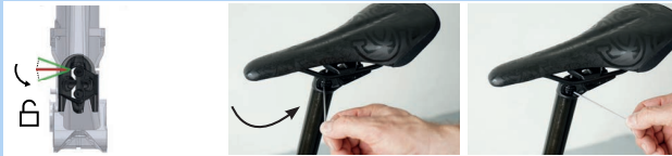
Abbildung 167: Höhenverstellungsbetätigung in „Geöffnete Stellung“ bringen
