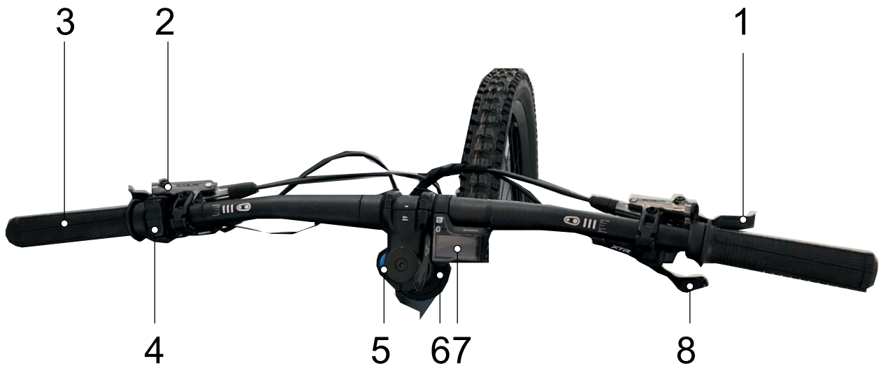
Abbildung 42: Detailansicht Lenker mit SHIMANO SC-E800 Bordcomputer, Beispiel
