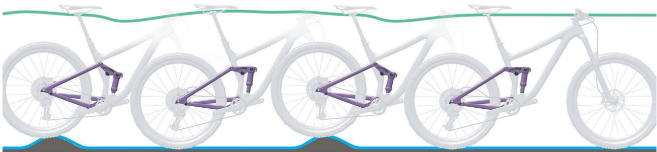
Abbildung 108: Optimales Fahrverhalten des Hinterbau-Dämpfers
