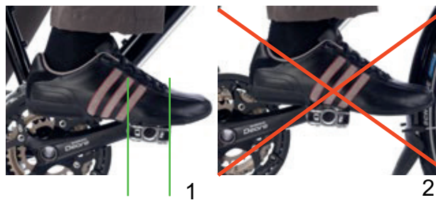
Abbildung 133: Korrekte (1) und falsche (2) Fußposition auf dem Pedal
