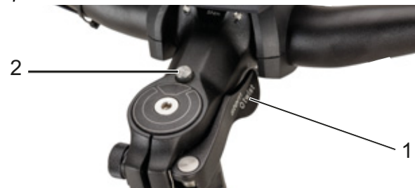
Figura 72: Potencia, versión II con palanca tensora del cierre rápido de la potencia (1) y botón de desbloqueo (2)
