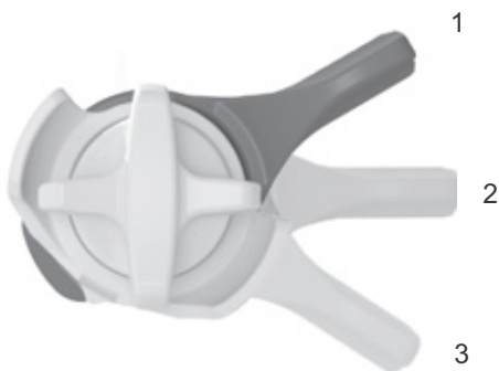
Figura 85: Regulador de niveles de presión FOX en el amortiguador de la horquilla trasera con las posiciones ABIERTO (1), MEDIO (2) y DURO (3)
