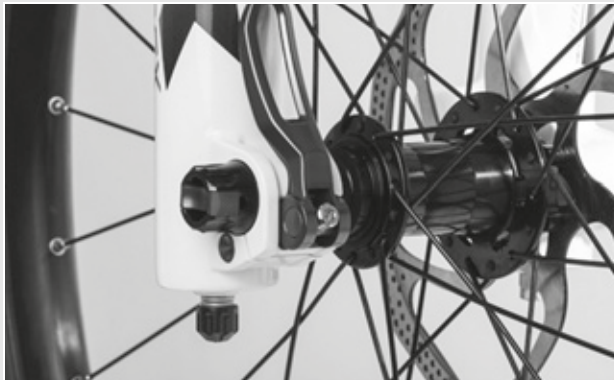
Figura 38: Posición perfecta de la palanca tensora
