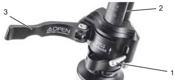
Figura 71: Palanca tensora abierta del cierre rápido de la potencia (3) en la potencia (2), versión I, con palanca de seguridad en la potencia (1)
