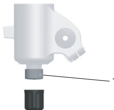
Figura 63: Regulador de niveles de tracción FOX (1) en la horquilla
