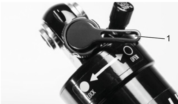
Figura 88: Regulador de niveles de presión Suntour abierto (1)
