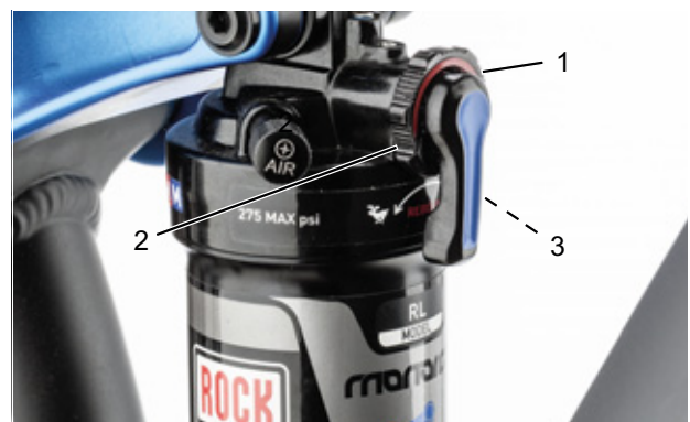
Figura 90: Ajuste de la dureza del amortiguador de niveles de tracción en la rueda de ajuste (1) del amortiguador de la horquilla trasera
