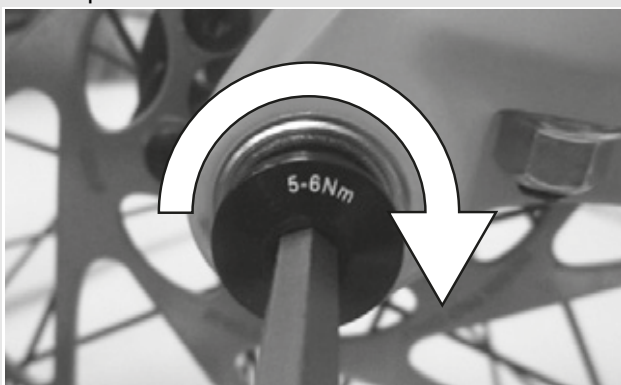
Figura 31: Apriete del tornillo de seguridad
