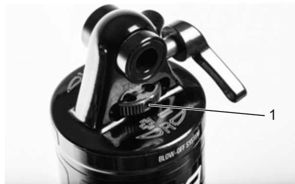
Figura 64: Rueda del regulador de niveles de tracción Suntour (1) en el amortiguador de la horquilla trasera
