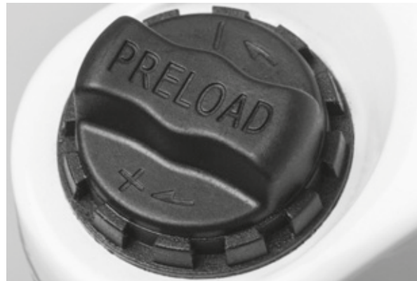
Figura 61: Rueda de ajuste del recorrido de muelle negativo en la corona de la horquilla de suspensión
