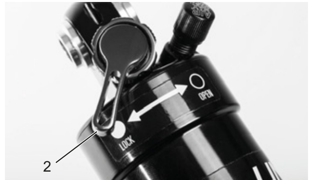
Figura 89: Regulador de niveles de presión Suntour cerrado (2)
