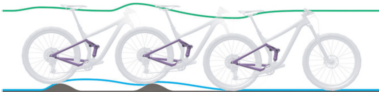
Obr. 229: Příliš pomalé roztahování tlumiče zadního odpružení
