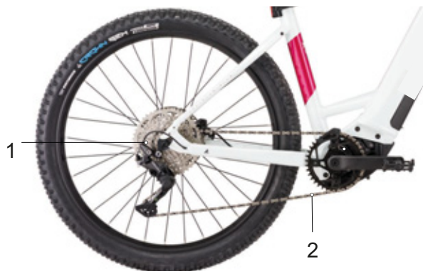
Obr. 37: Schéma řetězového převodu s přesmykačem
