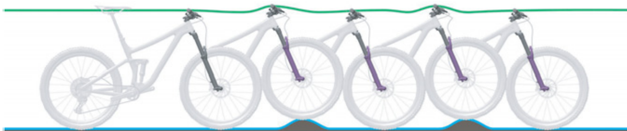
Obr. 131: Optimální chování vidlice při jízdě
