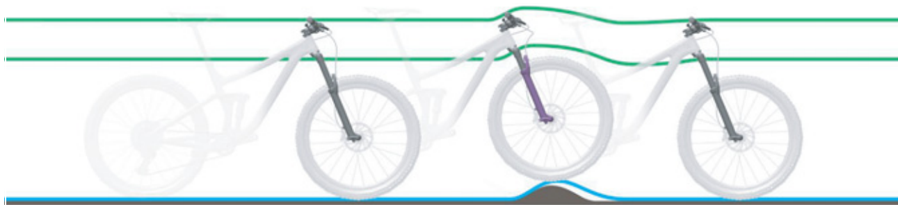
Obr. 209: Příliš tvrdé tlumení odpružené vidlice u nerovností
