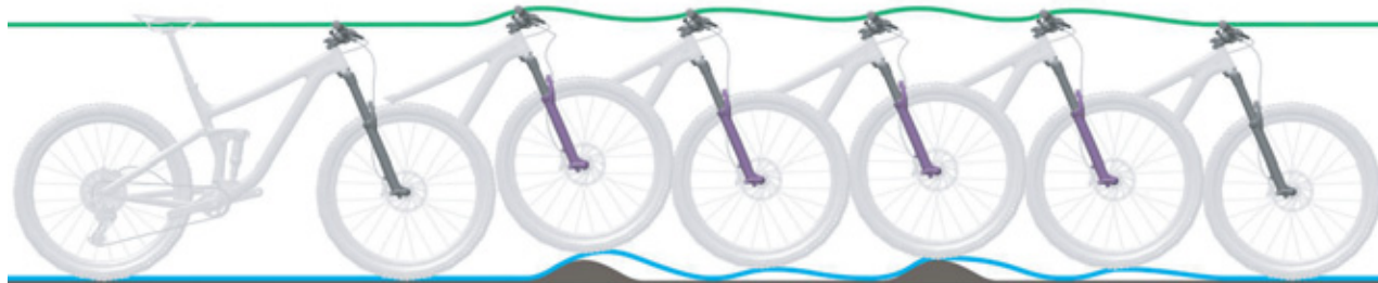
Obr. 211: Příliš rychlé roztahování odpružené vidlice
