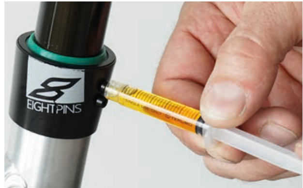
Obr. 166: Namazání sedlovky eightpins
