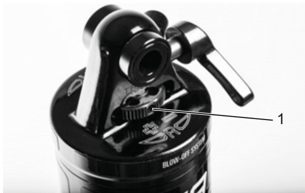
Obr. 222: Nastavovací kolečko odskoku SR SUNTOUR (1) na tlumiči zadního odpružení
