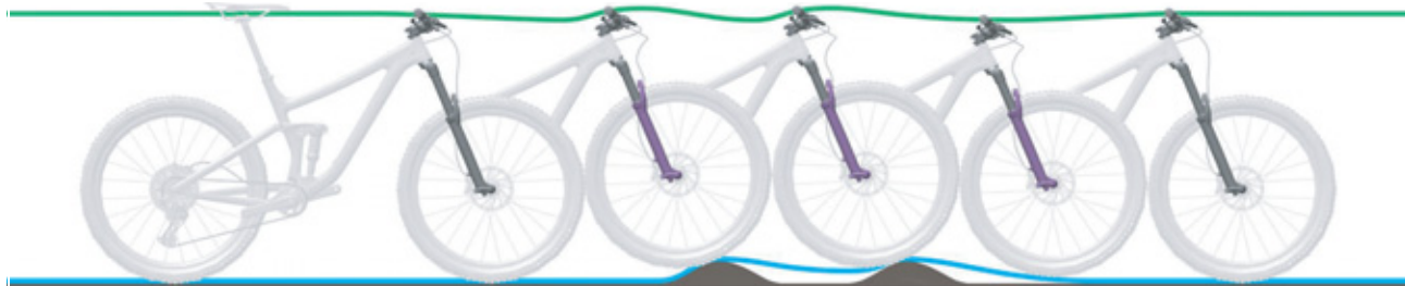
Obr. 213: Příliš pomalé roztahování odpružené vidlice
