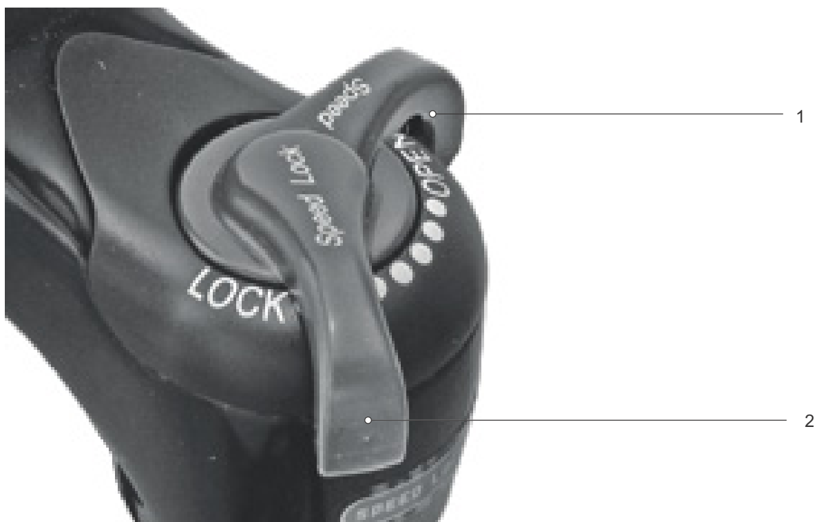
Obr. 157: Tlumič komprese SR SUNTOUR v otevřené (1) a zavřené (2) poloze
