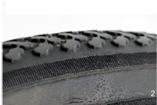
Obr. 169: Příklady únavových trhlin (1) a trhlin vzniklých stárnutím (2)
