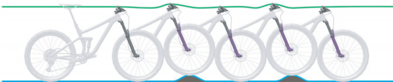
Obr. 12: Optimální chování vidlice při jízdě
