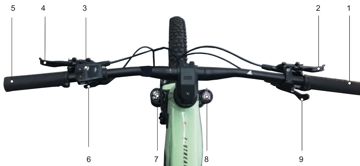
Obr. 42: Detailní pohled na řídítka s palubním počítačem FIT Remote LCD, příklad
