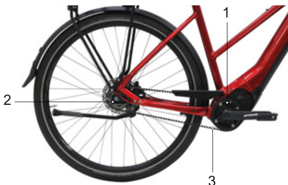
Obr. 38: Schéma řemenového pohonu
