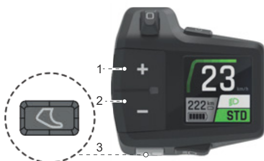
Obr. 154: Poloha tlačítka Plus (1), Minus (2), a Funkce podpory tlačení (3)
