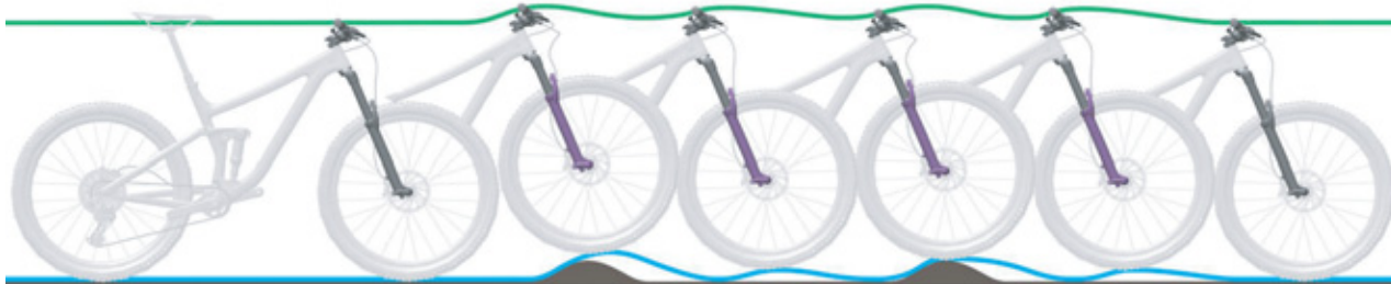
Obr. 203: Příliš rychlé roztahování odpružené vidlice
