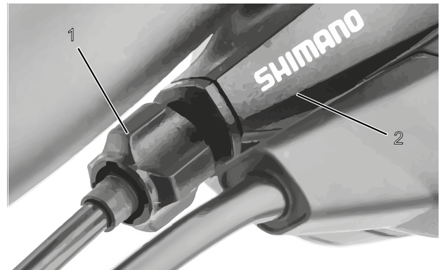
Figura 86: Casquillo de ajuste (1) del cambio de marchas accionado por cable de accionamiento con carcasa de la palanca de cambio (2), ejemplo
