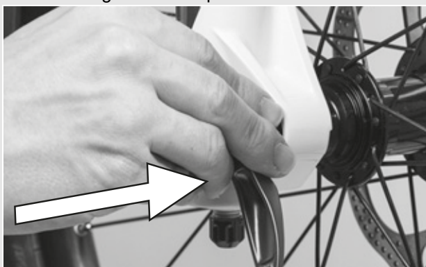
Figura 35: Inserción del cierre rápido
