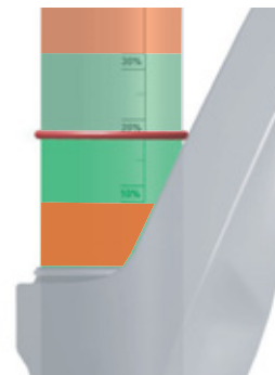
Figura 58: Rango SAG especificado (verde) y rango SAG prohibido
