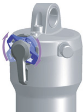
Figura 102: Ajuste para un regulador de niveles de presión más duro
