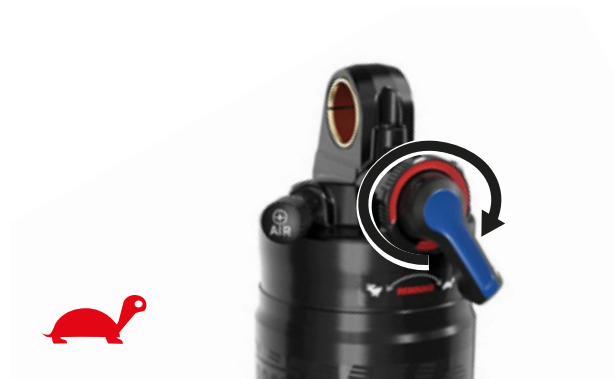
Figura 66: Reducción de la velocidad de descompresión
