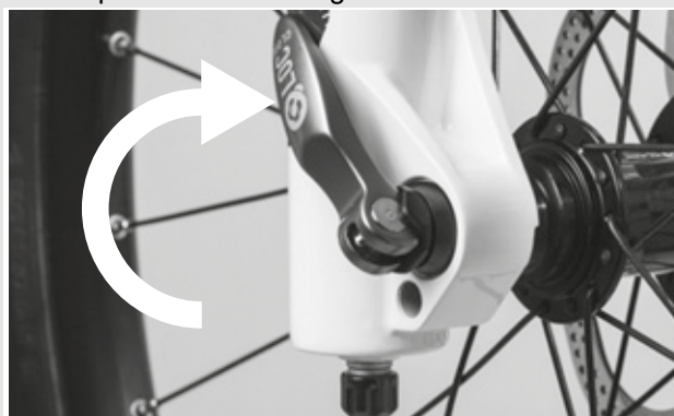
Figura 37: Cierre del cierre rápido
