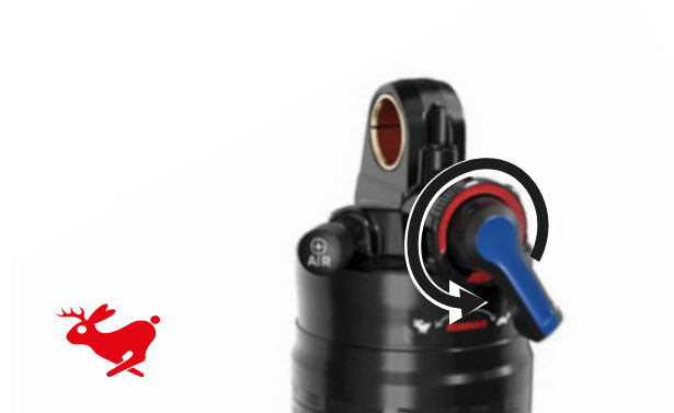
Figura 67: Incremento de la velocidad de descompresión
