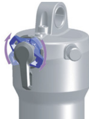
Figura 71: Ajuste para un regulador de niveles de presión más duro
