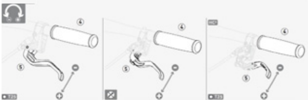
Figura 51: Ajustar el ancho de agarre de la palanca de freno con freno de disco Magura
