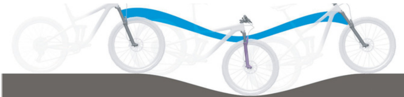
Figura 93: Suspensión de la horquilla de suspensión demasiado blanda en montaña
