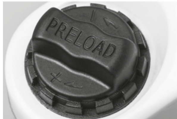
Figura 53: Rueda de ajuste SAG en la corona de la horquilla de suspensión
