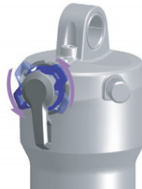
Figura 72: Ajuste para un regulador de niveles de presión más blando
