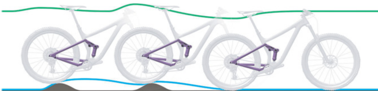
Figura 99: Descompresión demasiado lenta del amortiguador de la horquilla trasera
