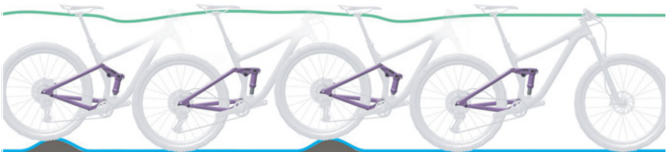
Figura 62: Condición óptima de marcha del amortiguador de la horquilla trasera
