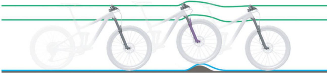
Figura 95: Amortiguación de la horquilla de suspensión demasiado dura en caso de irregularidades
