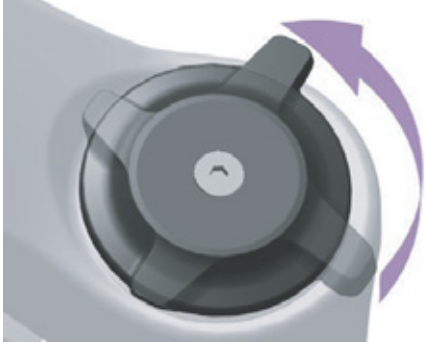
Figura 79: Ajuste para un regulador de niveles de presión más blando
