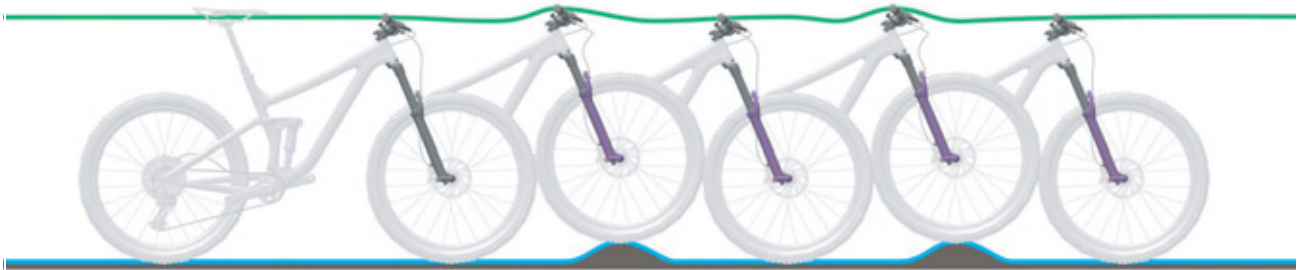
Figura 61: Condición óptima de marcha de la horquilla
