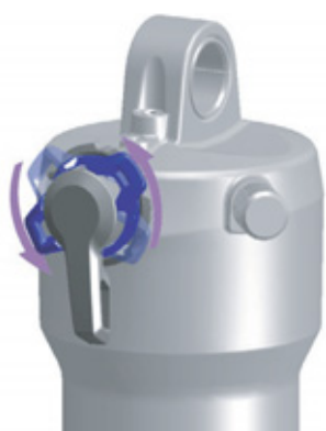
Figura 104: Ajuste para un regulador de niveles de presión más blando
