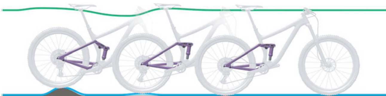
Figura 97: Descompresión demasiado rápida del amortiguador de la horquilla trasera
