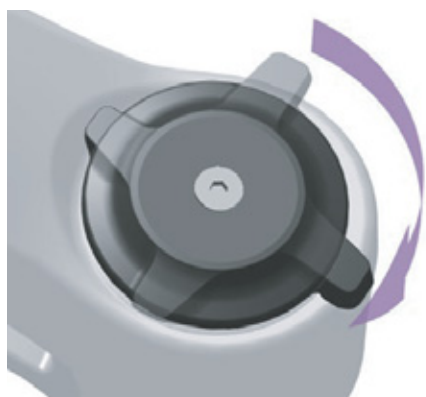
Figura 94: Ajuste para un regulador de niveles de presión más duro
