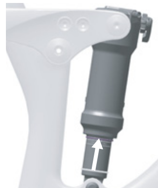
Figura 60: Desplazamiento de la junta tórica en el amortiguador de la horquilla trasera
