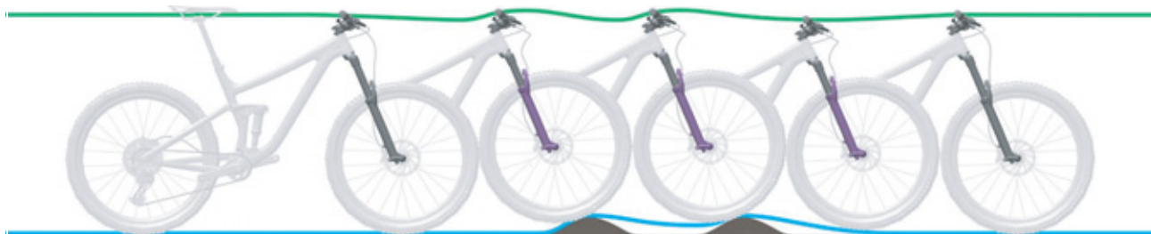
Figura 91: Descompresión demasiado lenta de la horquilla de suspensión
