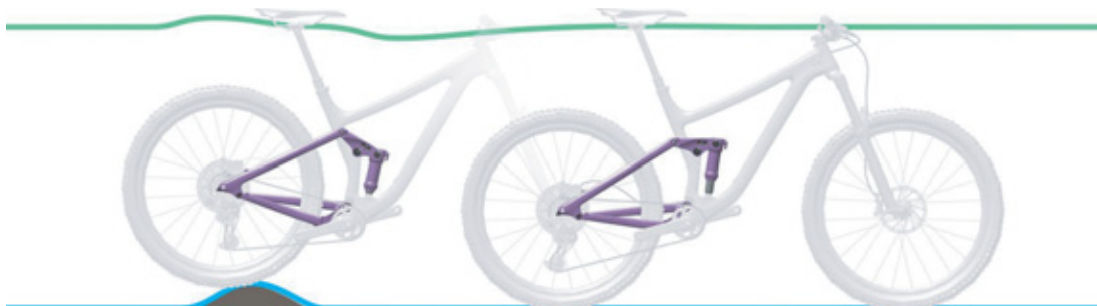
Figura 12: Condición óptima de marcha del amortiguador de la horquilla trasera en caso de irregularidades
