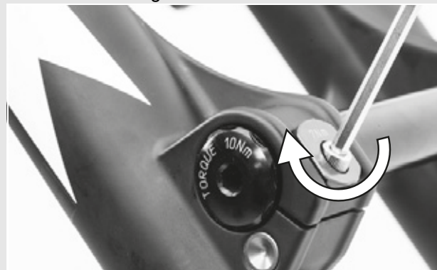
Figura 27: Apriete la abrazadera de sujeción
