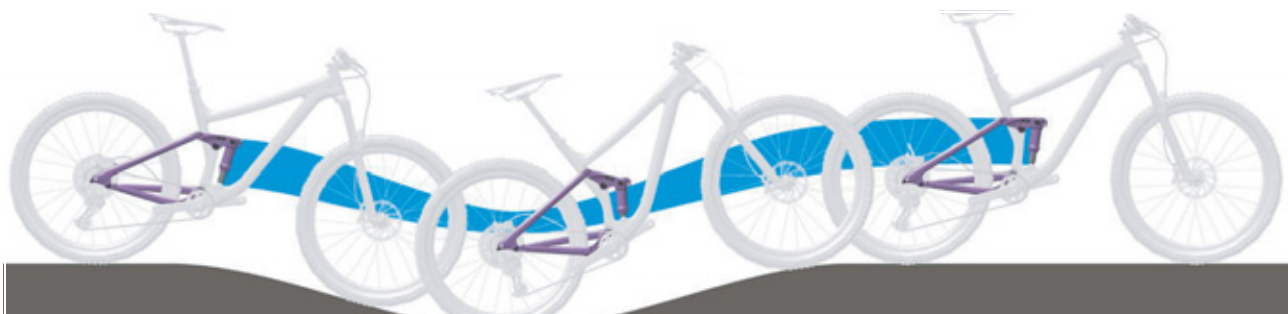
Figura 101: Suspensión del amortiguador de la horquilla trasera demasiado blanda en montaña
