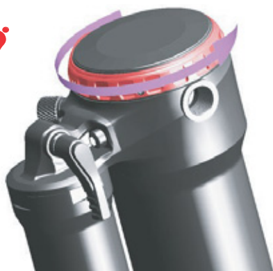
Figura 100: Giro del amortiguador de niveles de tracción en dirección al conejo
