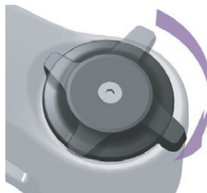
Figura 78: Ajuste para un regulador de niveles de presión más duro
