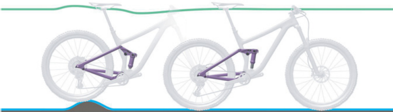
Figura 69: Condición óptima de marcha del amortiguador de la horquilla trasera en caso de irregularidades
