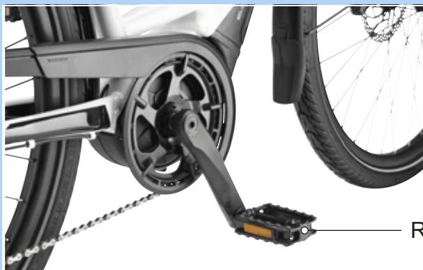
Rysunek 69: Pedał „R” w prawym ramieniu korby
