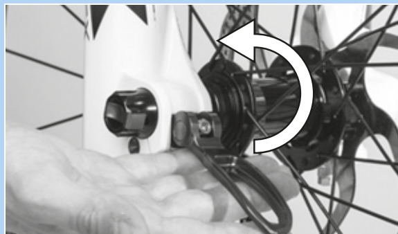
Rysunek 60: Docisnąć dźwignię zacisku szybkomocującego zgodnie z kierunkiem strzałki
