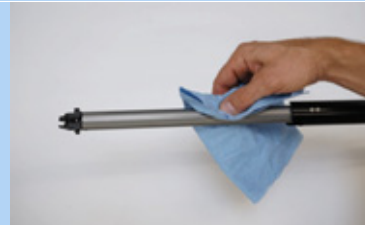
Rysunek 215: Czyszczenie podłużnego rowka prowadzącego
