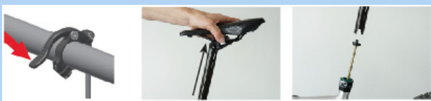
Rysunek 163: Wyciąganie sztycy podsiodłowej
