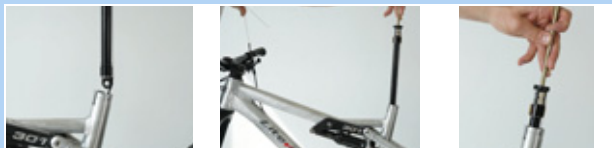
Rysunek 190: Mocowanie nakrętki zaworu wkładu
