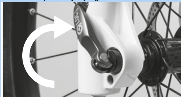
Rysunek 66: Zamykanie zacisku szybko mocującego
