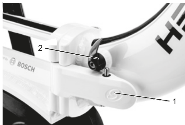
Rysunek 141: Otwarta (1) i zamknięta (2) dźwignia zabezpieczająca ramy
