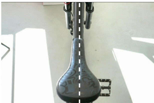
Rysunek 72: Ustawianie siodełka zgodnie z kierunkiem jazdy
