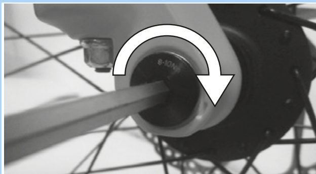
Rysunek 54: Dokręcić oś zgodnie z kierunkiem strzałki
