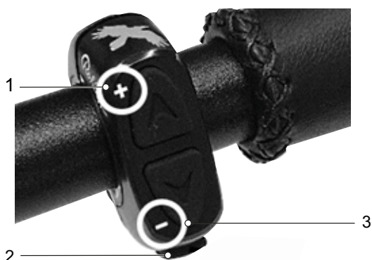
Rysunek 136: Przyciski na kierownicy ROHLOFF E-14
