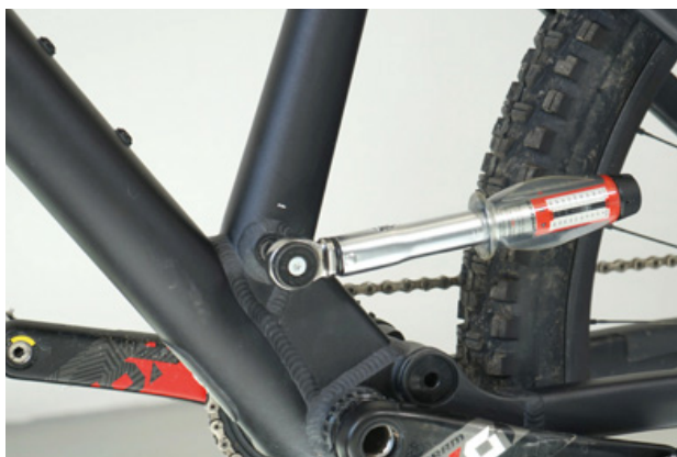
Rysunek 73: Dociąganie osi sztycy podsiodłowej
