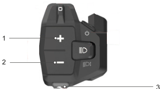
Rysunek 122: Położenie przycisków Plus (1), Minus (2), i mechanizmu wspomagającego pchanie (3)
