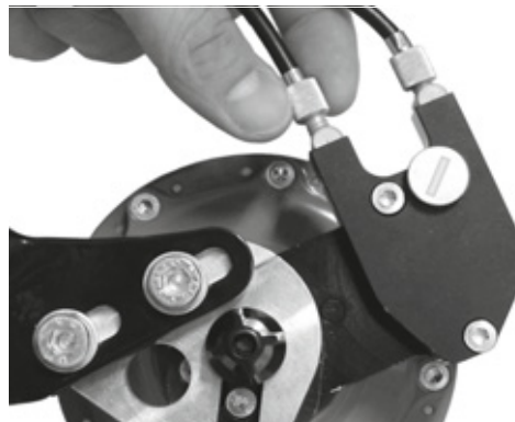
Rysunek 155: Wersje piast Rohloff z zewnętrznym sterowaniem zmiany biegów mają regulator linki na przepustnicy kablowej, która znajduje się po lewej stronie
