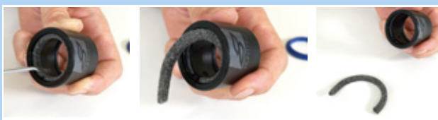
Rysunek 208: Wyciąganie pierścienia filcowego
