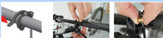
Rysunek 164: Demontaż wkładu
