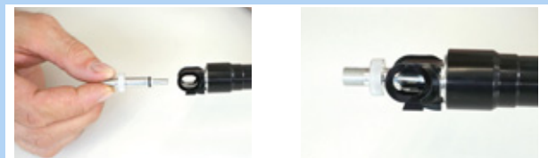
Rysunek 179: Wkręcanie adaptera zaworu
