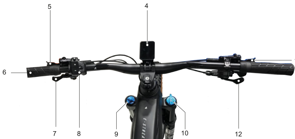
Rysunek 32: Widok szczegółowy kierownicy z komputerem pokładowym Intuvia firmy BOSCH
