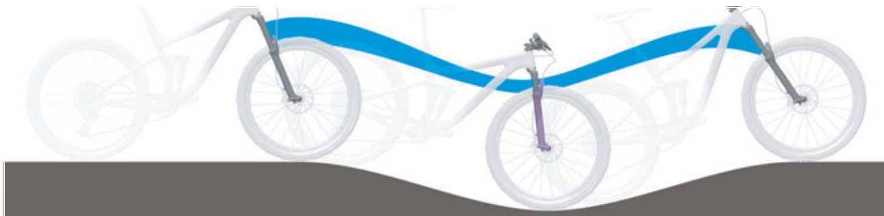
Rysunek 228: Zbyt miękkie amortyzowanie widelca na wzniesieniu
