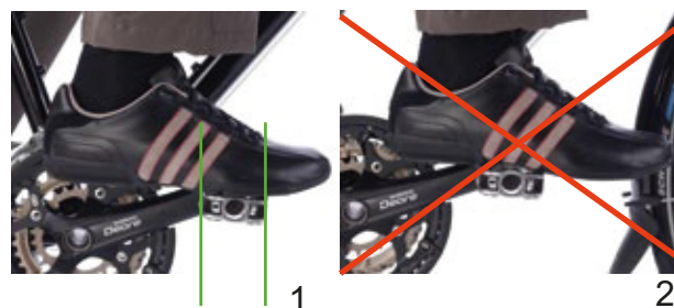
Rysunek 117: Prawidłowe (1) i nieprawidłowe (2) ułożenie stopy na pedale
