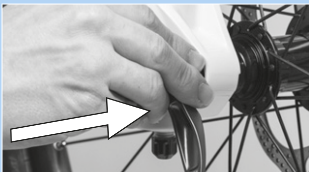
Rysunek 64: Wcisnąć zacisk szybko mocujący zgodnie z kierunkiem strzałki
