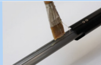
Rysunek 216: Nakładanie smaru
