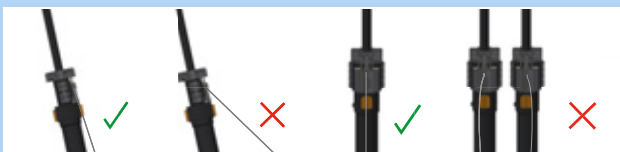
Rysunek 189: Prawidłowa i nieprawidłowa pozycja cięgna Bowdena
