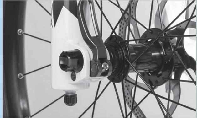
Abbildung 186: Spannkraft des Schnellspanners einstellen
