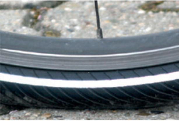
Abbildung 111: Korrekter Fülldruck. Der Reifen ist unter der Last des Körpergewichts kaum verformt
