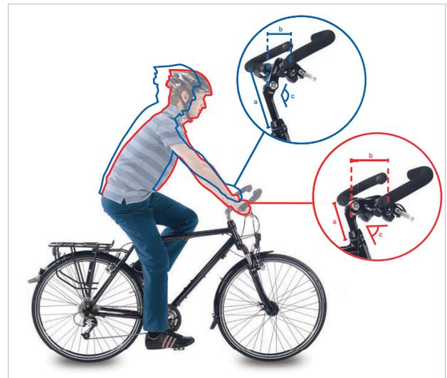
Abbildung 109: Citybike (blau) und Trekkingrad Position (rot) durch Winkeländerung
