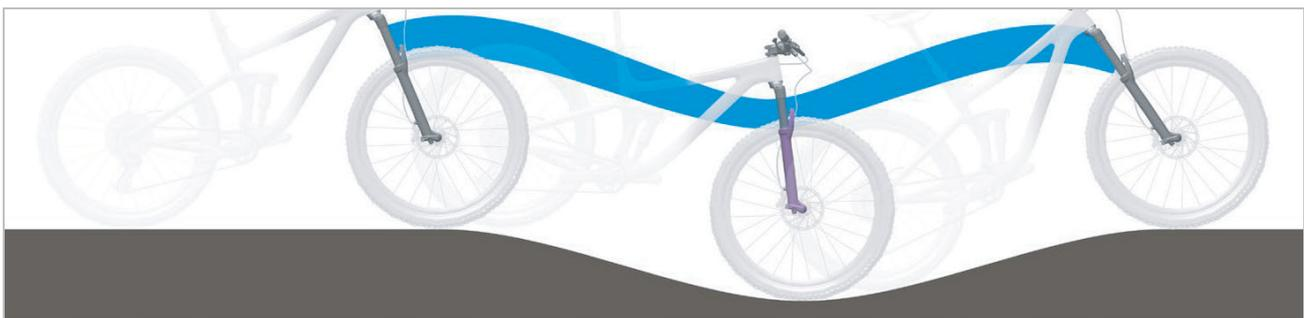
Abbildung 13: Optimales Fahrverhalten der Federgabel im hügeligen Gelände
