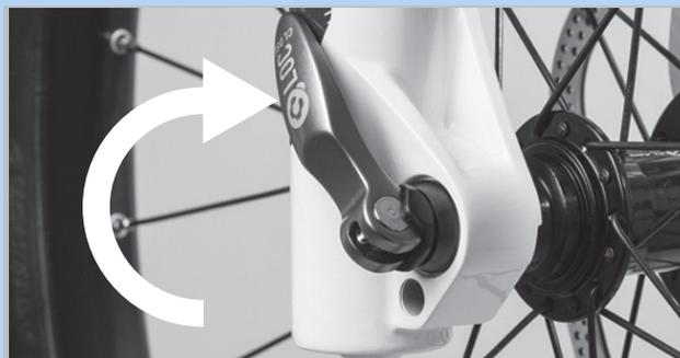
Abbildung 82: Schnellspanner schließen
