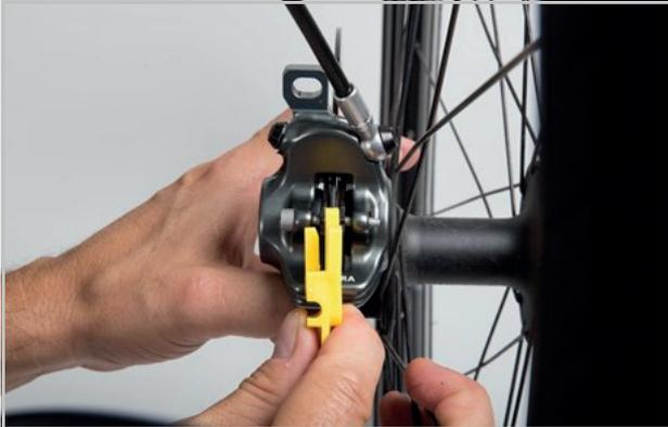
Abbildung 157: Bremsbelag im eingebauten Zustand mithilfe der Transportsicherung prüfen
