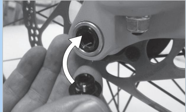
Abbildung 71: Sicherungsschraube einsetzen
