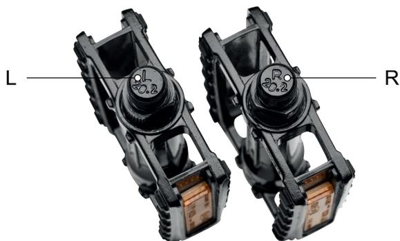
Abbildung 85: Beispiel Kennzeichnung von Pedalen
