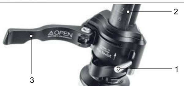
Abbildung 83: Geöffneter Spannhebel des Vorbau-Schnellspanners (3) am Vorbau (2), Ausführung I, mit Sicherungshebel am Vorbau (1)
