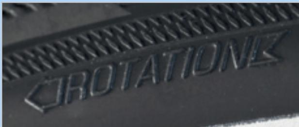
Abbildung 67: Laufrichtungspfeil
