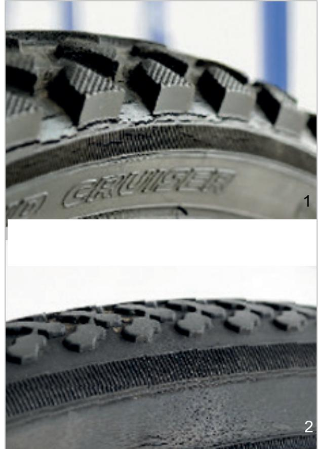
Abbildung 156: Beispiele für Ermüdungsrisse (1) und Alterungsrisse (2)
