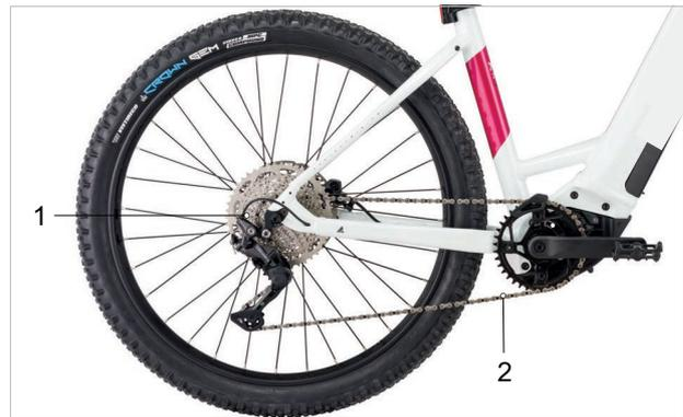
Abbildung 42: Schema Kettenantrieb mit Kettenschaltung
