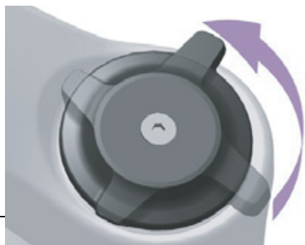
Figur 133: GabelBlødere indstilling på tryktrins-indstillingsanordning
