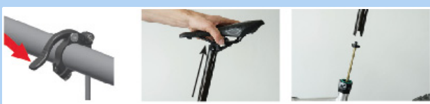
Figur 156: Udtrækning af sadelpind
