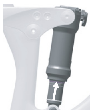
Figur 100: Forskyd O-ringen på bagdæmperen
