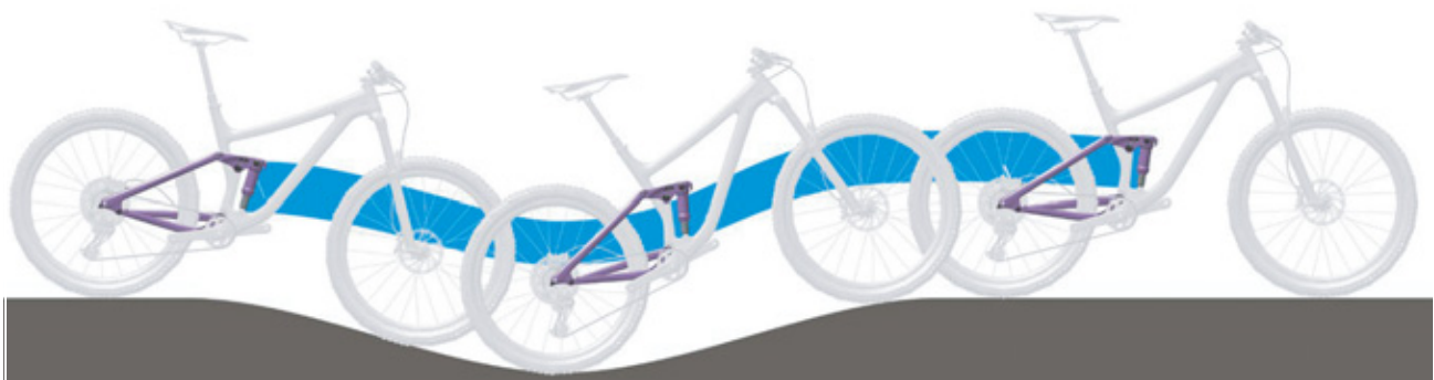
Figur 19: Bagdæmperen fungerer optimalt under kørsel i kuperet terræn
