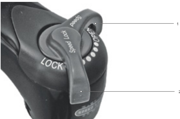
Figur 222: Hårdere indstilling på tryktrins-indstillingsanordning
