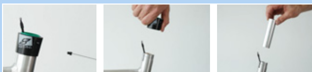
Figur 163: Afmontering af udvendig kappe og glidebøsning
