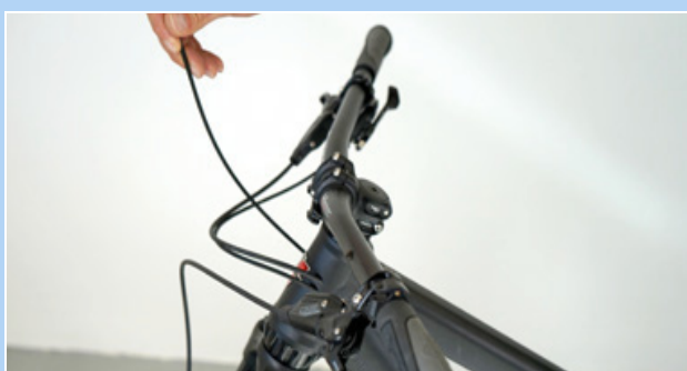
Figur 214: Fasthægtning af endekappe
