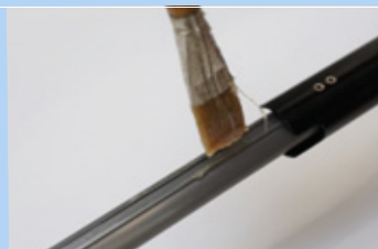
Figur 209: Påføring af fedt
