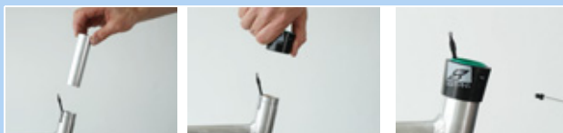
Figur 179: Montering af glidebøsning og udvendig kappe
