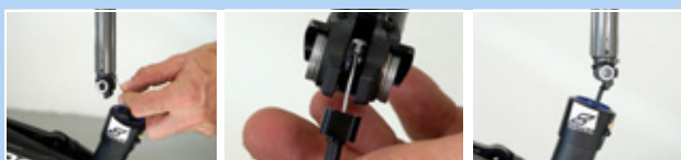
Figur 213: Påhægtning og indskubning af sadelpind
