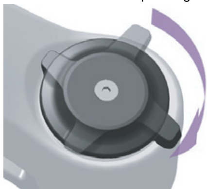
Figur 132: Hårdere indstilling på tryktrins-indstillingsanordning
