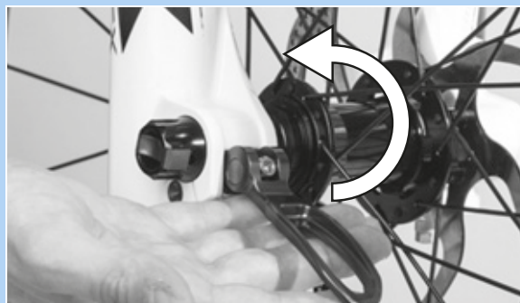
Figur 57: Hurtigbespændingsgrebet trykkes i pilens retning
