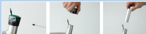
Figur 197: Afmontering af udvendig kappe og glidebøsning
