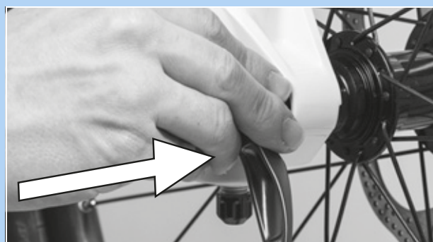
Figur 61: Skub hurtigbespændingen ind i pilens retning
