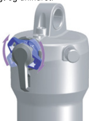
Figur 108: Hårdere indstilling på tryktrinsindstillingsanordning
