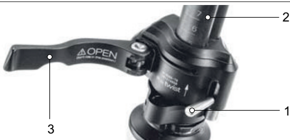
Abbildung 71: Geöffneter Spannhebel des Vorbau-Schnellspanners (3) am Vorbau (2), Ausführung I, mit Sicherungshebel am Vorbau (1)
