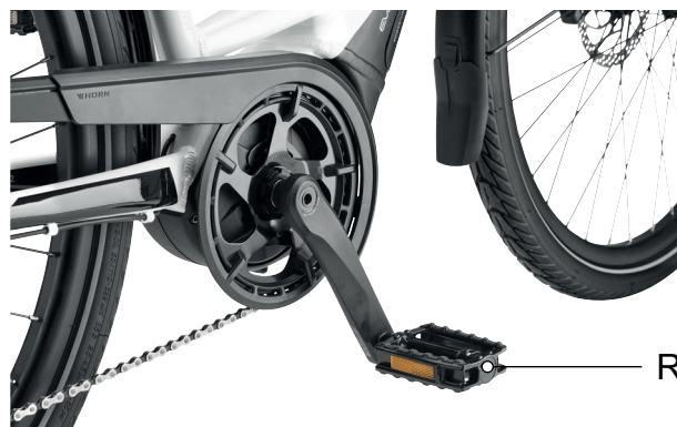
Abbildung 75: R Pedal im rechten Kurbelarm
