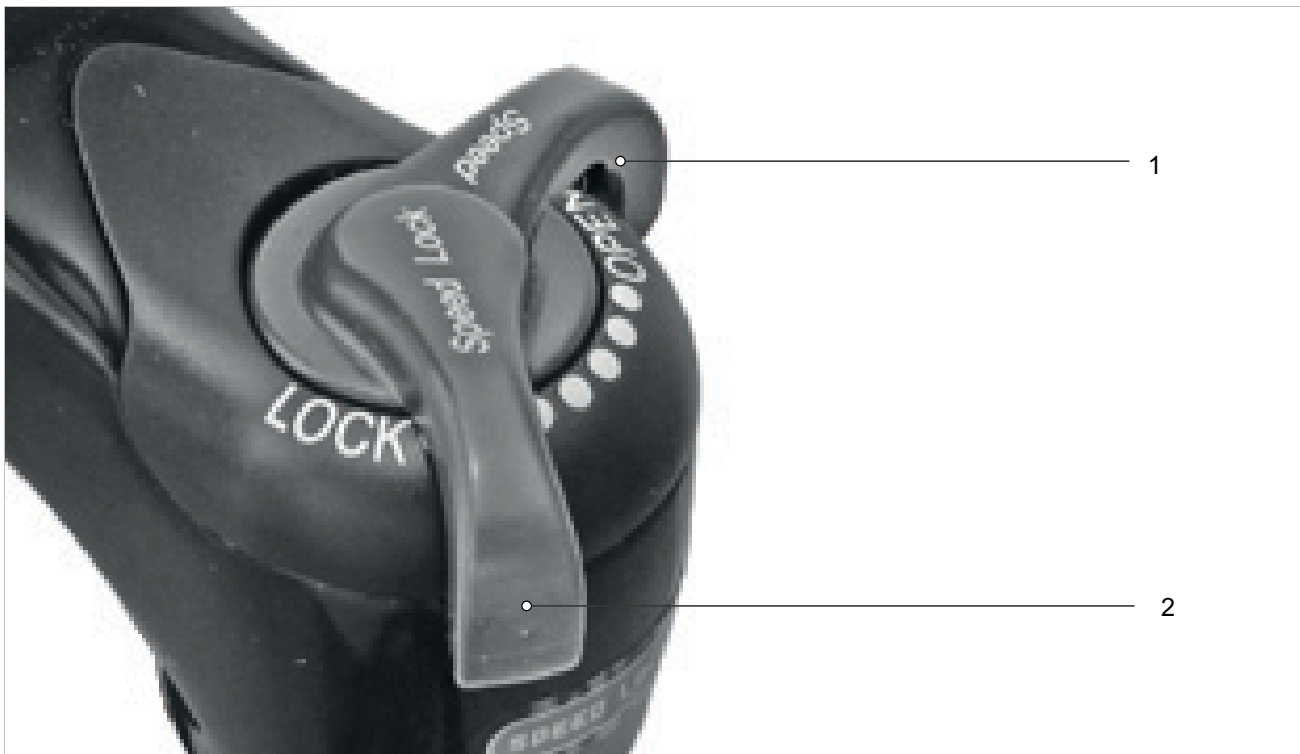
Abbildung 135: SR SUNTOUR-Druckstufendämpfer in offener (1) und geschlossener (2) Position
