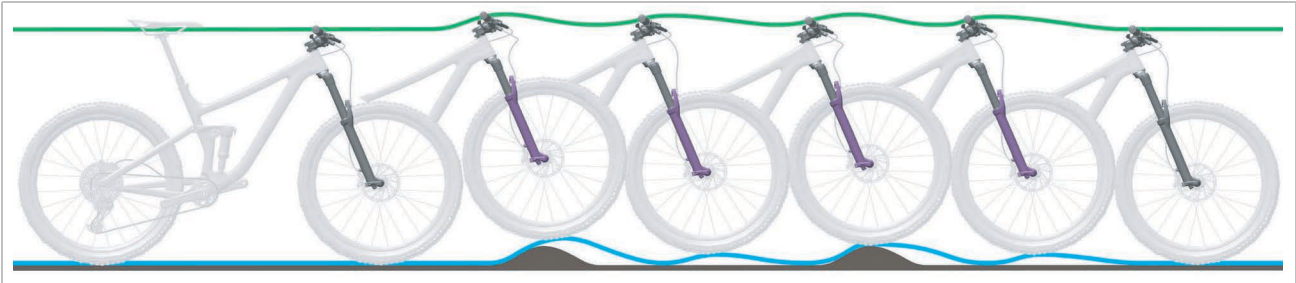
Abbildung 171: Zu schnelles Ausfedern der Federgabel
