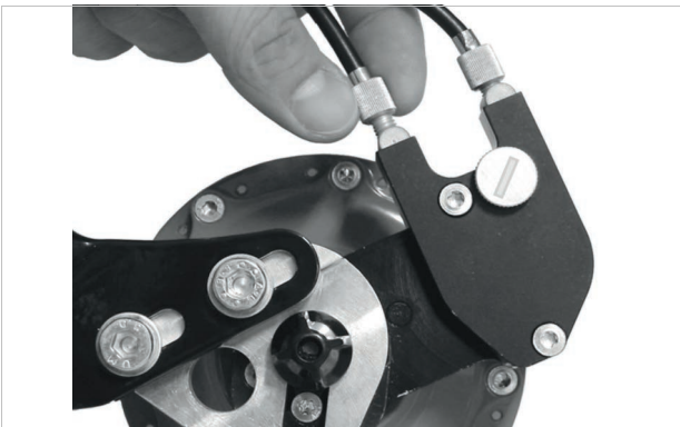
Abbildung 164: ROHLOFF-Naben Versionen mit externer Schaltansteuerung haben die Zugeinsteller an der Seilbox, die sich auf der linken Seite befindet
