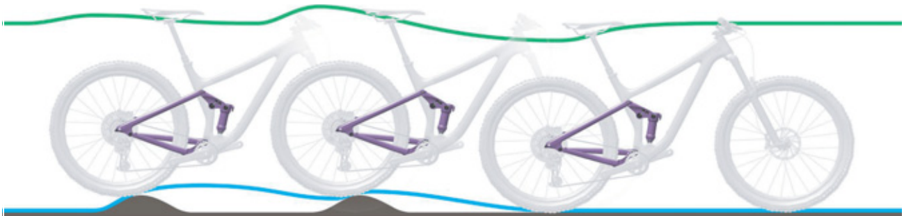
Afbeelding 229: Te langzaam uitveren van de achterbouwdemper
