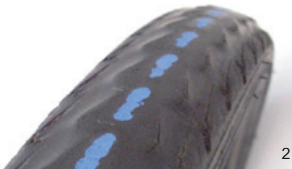
Afbeelding 168: Een band zonder profiel, die kan worden vervangen (1), en een band met zichtbare lekbescherming (2), die moet worden vervangen
