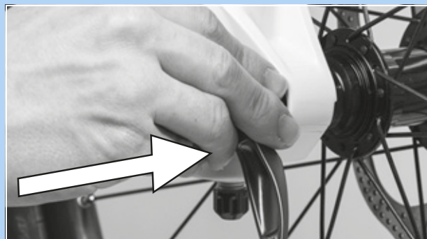
Afbeelding 82: Snelspanner in de richting van de pijl inschuiven
