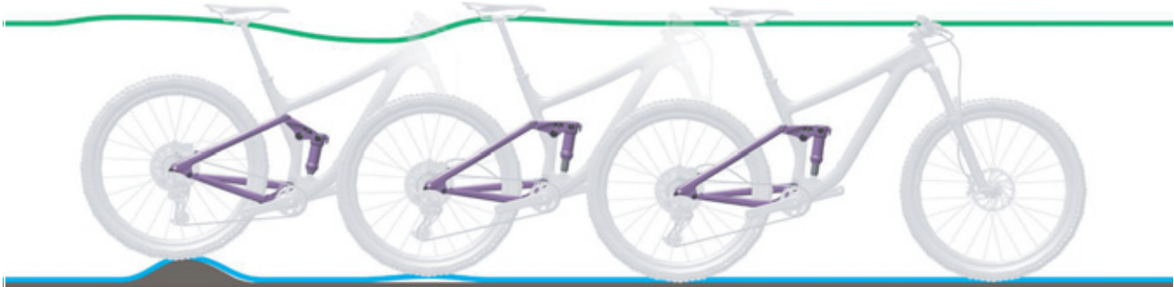
Afbeelding 219: Te snel uitveren van de achterbouwdemper
