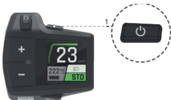
Afbeelding 136: Display (1) op de FIT Remote met LCD
