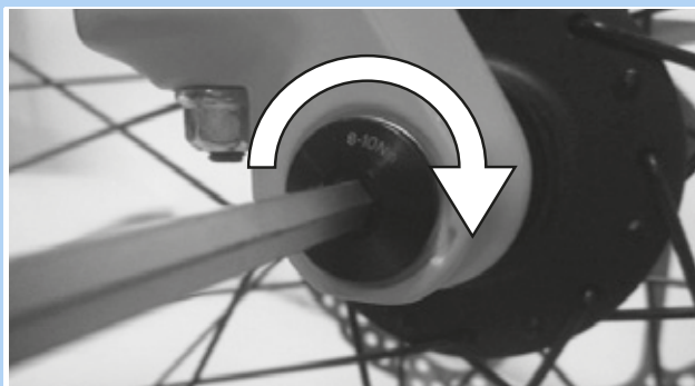
Afbeelding 72: As in de richting van de pijl vastdraaien
