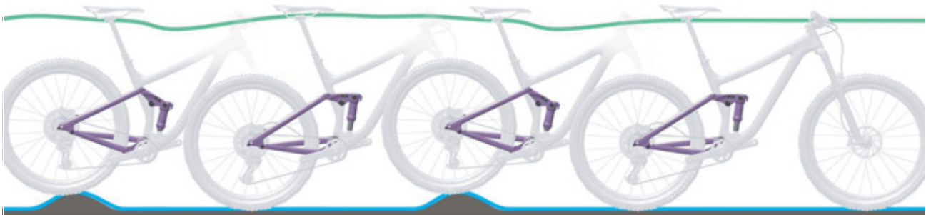
Afbeelding 16: Optimaal rijgedrag van de achterbouwdemper
