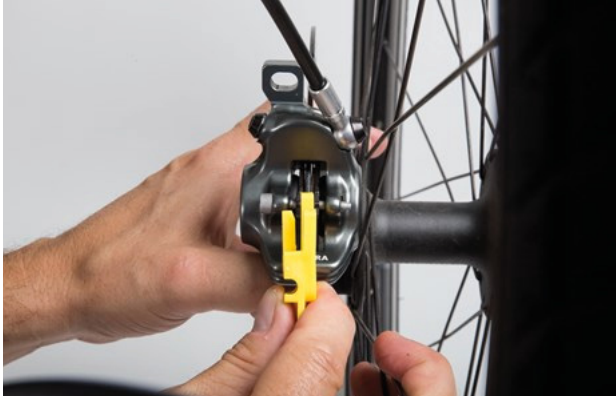
Afbeelding 170: Remvoering in gemonteerde toestand controleren met behulp van de transportbeveiliging
