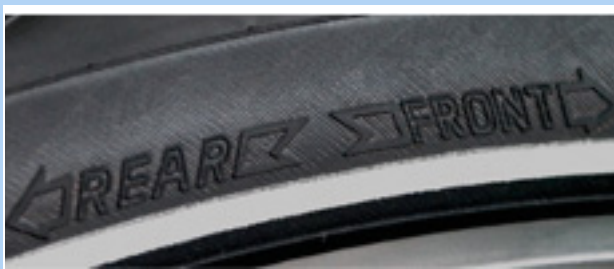
Afbeelding 70: Pijl draairichting op MTB-banden
