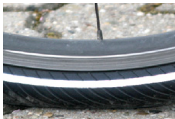
Afbeelding 122: Juiste vuldruk. De band is onder de belasting van het lichaamsgewicht nauwelijks vervormd
