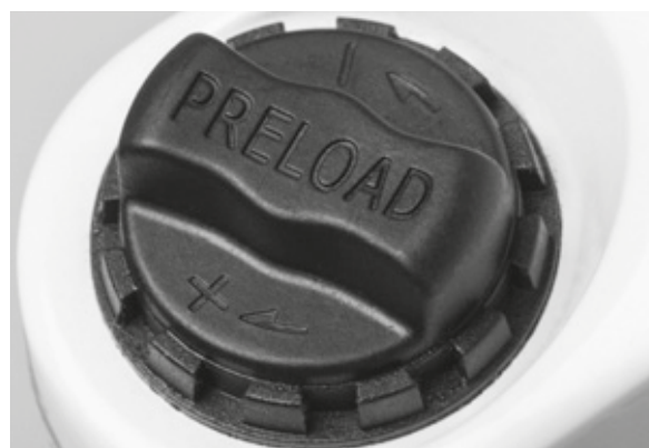
Figura 57: Rueda de ajuste del recorrido de muelle negativo en la corona de la horquilla de suspensión
