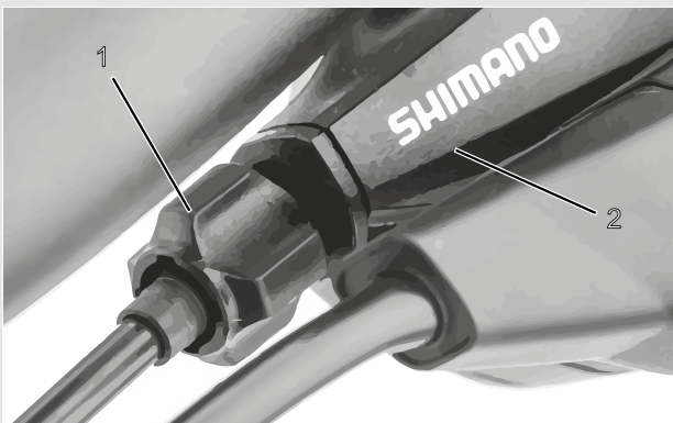
Figura 84: Casquillo de ajuste (1) del cambio de marchas accionado por cable de accionamiento con carcasa de la palanca de cambio (2), ejemplo
