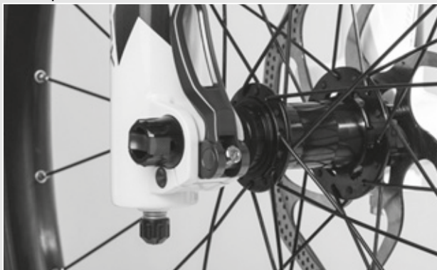
Figura 34: Posición perfecta de la palanca tensora
