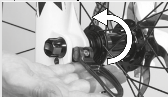
Figura 33: Seguridad de la palanca
