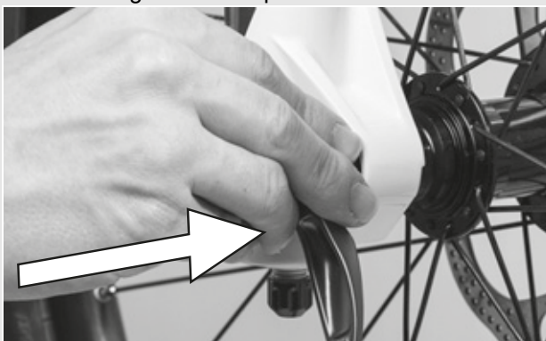
Figura 37: Inserción del cierre rápido
