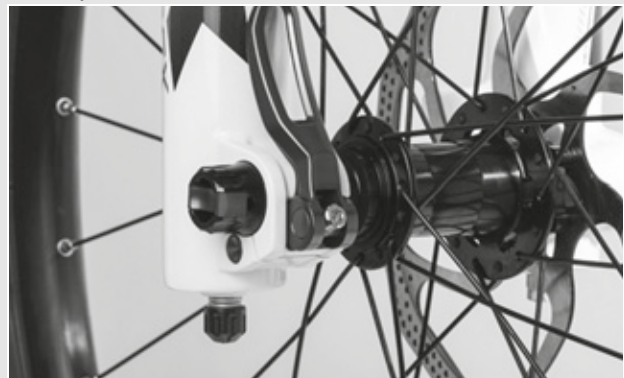
Figura 82: Ajuste de la fuerza de tensado del cierre rápido
