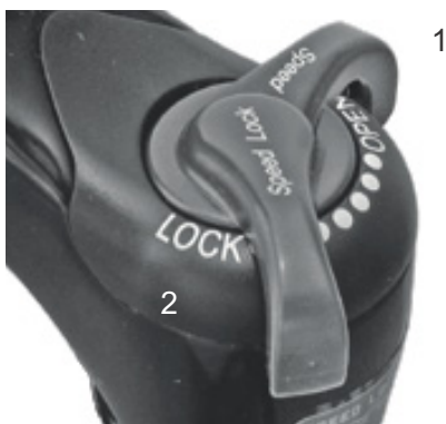
Figura 78: Regulador de niveles de presión Suntour con las posiciones OPEN (1) y LOCK (2)
