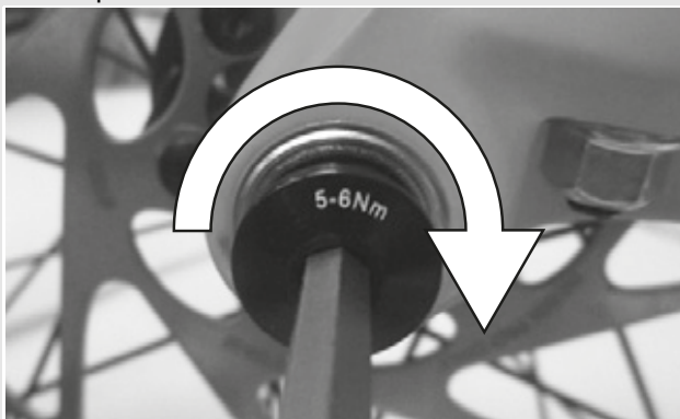
Figura 27: Apriete del tornillo de seguridad
