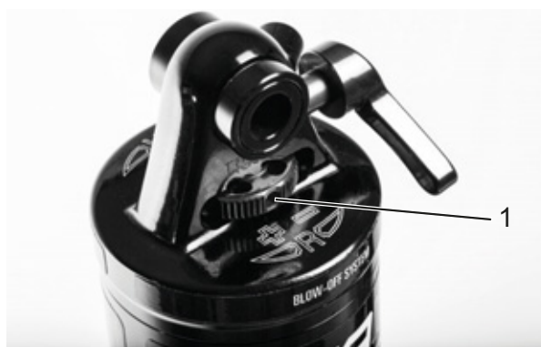
Figura 60: Rueda del regulador de niveles de tracción Suntour (1) en el amortiguador de la horquilla trasera
