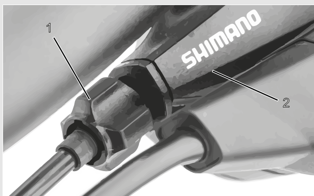
Figur 39: Slutmuffe (1) på gearskiftet med ét kabel og gearvælgerhus (2), eksempel
