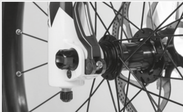
Figur 37: Indstilling af hurtigbespændingens spændekraft
