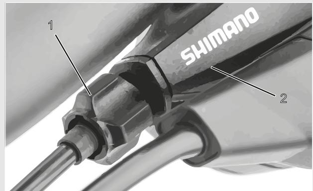
Illustration 40 : Douille de réglage (1) du changement de vitesse à un câble actionné par câble avec boîtier de manette de vitesse (2), exemple
