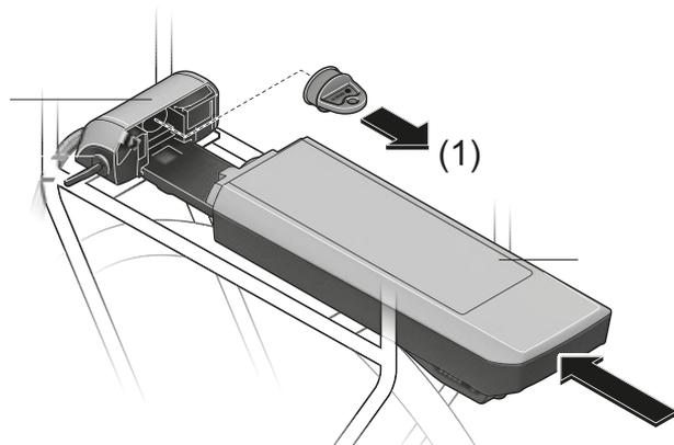
Illustration 33 : Couvrir les contacts ouverts avec un cache, exemple d'une batterie pour porte-bagages
