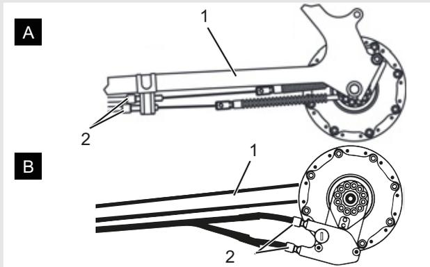
Illustration 41 : Douilles de réglage (2) sur deux modèles alternatifs (A et B) d'un changement de vitesse actionné par câble à deux câbles sur la base de cadre (1)
