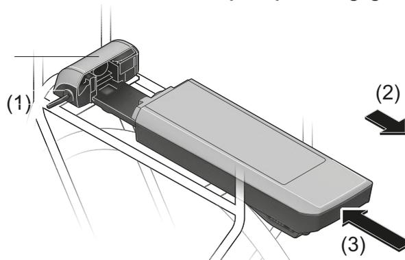
Illustration 30 : Retirer (2) et insérer (3) la batterie pour porte-bagages
