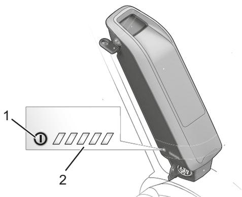
Illustration 15 : Indicateur de charge, exemple d'une batterie sur cadre
