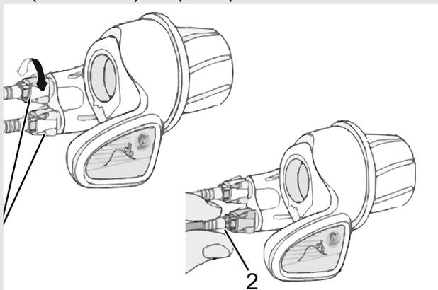
Illustration 42 : Poignée de vitesse rotative avec douilles de réglage (1) et jeu du changement de vitesse (2)
