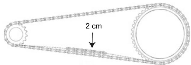
Illustration 37 : Contrôler la tension de la chaîne
