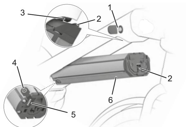
Illustration 11 : Détail d'une batterie intégrée
