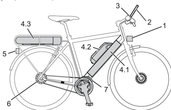
Illustration 6 : Schéma du système d'entraînement électrique
