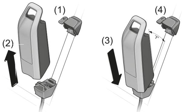
Illustration 29 : Retirer et insérer la batterie sur cadre
