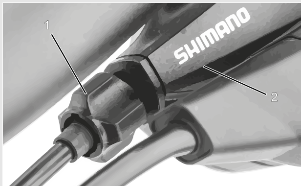
Figur 74: Slutmuffe (1) på gearskiftet med ét kabel og gearvælgerhus (2), eksempel
