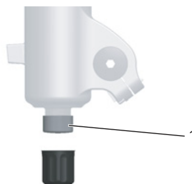
Figur 54: FOX-træktrins-indstillingsanordning (1) på gaflen
