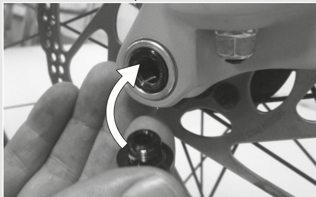
Figur 22: Skub hurtigbespændingen ind i akslen
