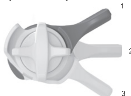
Figur 62: FOX-trykindstillingsanordning på bagdæmper med positionerne ÅBEN (1), MELLEM (2) og HÅRD (3)
