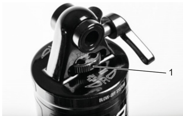
Figur 55: Hjul (1) for Suntour-træktrinsindstillingsanordning på bagdæmperen
