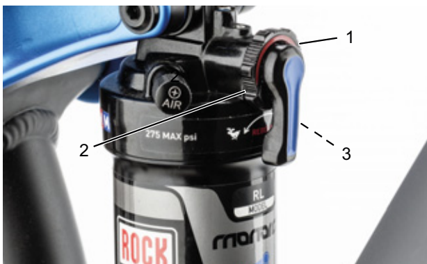
Figur 67: Indstilling af trækdæmperens hårdhed på bagdæmperens indstillingshjul (1)
