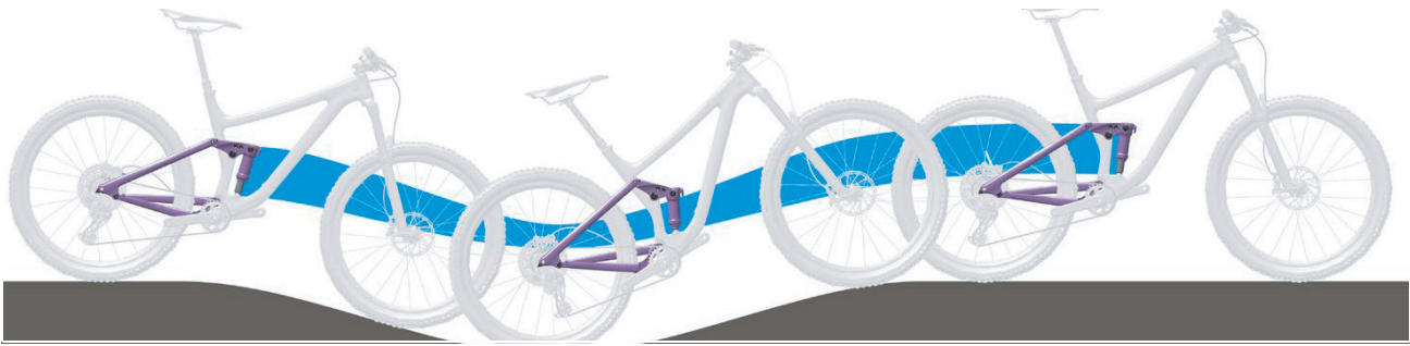
Abbildung 231: Zu weiche Federung des Hinterbau-Dämpfers am Berg
