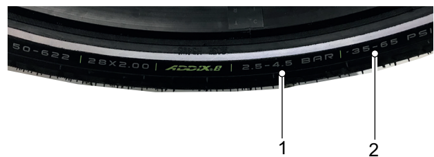
Abbildung 167: Fülldruck in bar (1) und psi (2)
