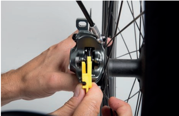
Abbildung 170: Bremsbelag im eingebauten Zustand mithilfe der Transportsicherung prüfen
