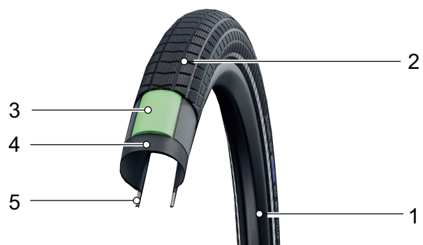
Abbildung 24: Aufbau offener Reifen
