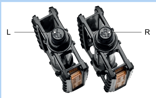
Abbildung 90: Beispiel Kennzeichnung von Pedalen
