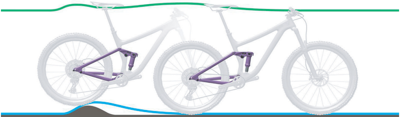
Abbildung 233: Zu harte Dämpfung des Hinterbau-Dämpfers bei Unebenheiten
