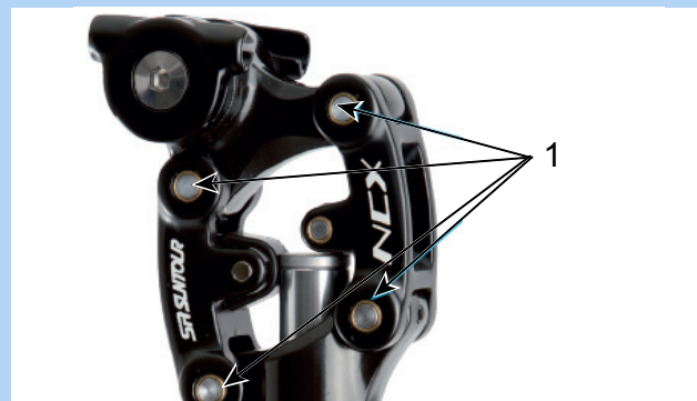
Abbildung 201: Schmierpunkte SR SUNTOUR Feder-Sattelstütze
