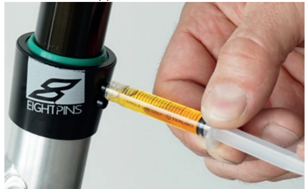
Abbildung 166: Eightpins Sattelstütze schmieren
