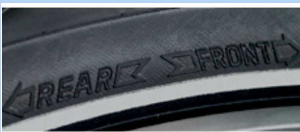
Abbildung 70: Laufrichtungspfeil auf MTB-Reifen
