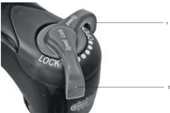
Abbildung 208: Druckstufeneinsteller härter einstellen
