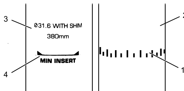
Abbildung 109: Detailansicht Sattelstützen, Beispiele für die Markierung der Mindesteinstecktiefe
