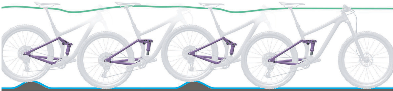
Abbildung 19: Optimales Fahrverhalten des Hinterbau-Dämpfers
