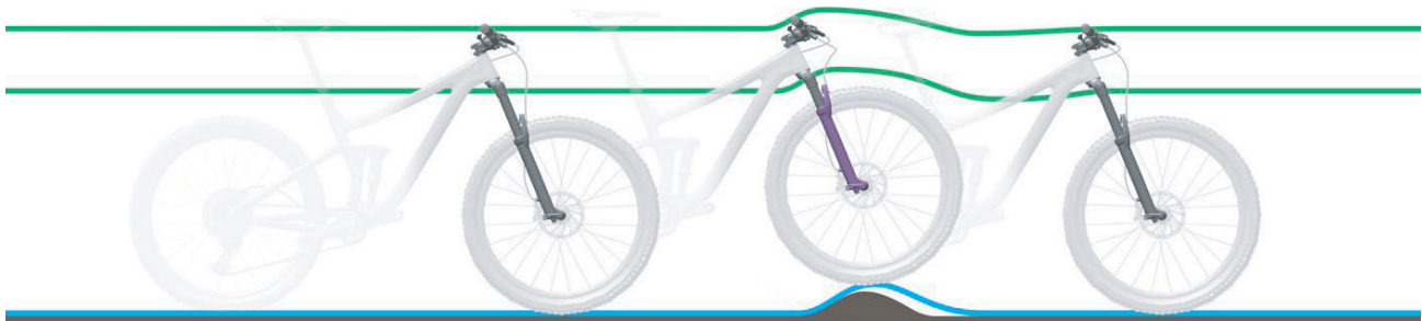
Abbildung 209: Zu harte Dämpfung der Federgabel bei Unebenheiten
