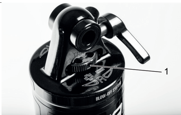
Abbildung 220: SR SUNTOUR-Zugstufen-Einsteller Rad (1) am Hinterbau-Dämpfer
