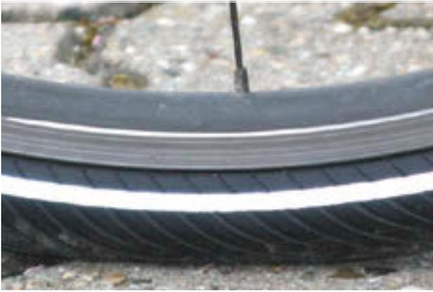
**Illustration 130** : Pression correcte. Le pneu se déforme à peine sous le poids du corps.
