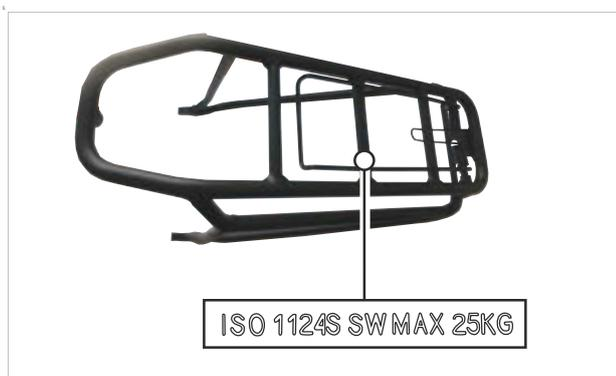
Illustration 184 : La capacité de charge maximale est indiquée sur le porte-bagages
