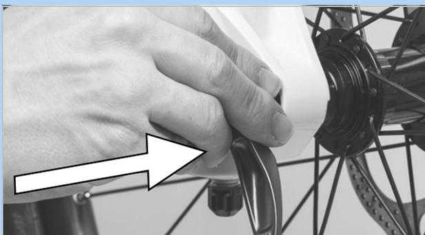
Illustration 101 : Enfoncez l'attache rapide dans le sens de la flèche
