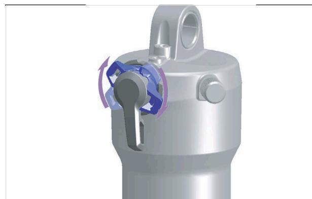
Illustration 192 : Régler le dispositif de réglage de la compression sur un niveau plus dur
