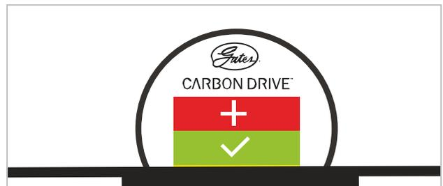
Illustration 247 : Exemple : Sur le bord jaune inférieur, la tension de la courroie doit donc être légèrement réduite
