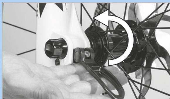
Illustration 97 : Enfoncez le levier d'attache rapide dans le sens de la flèche
