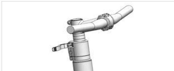
Illustration 216 : Exemple d'un All Up avec levier de serrage de la potence ouvert
