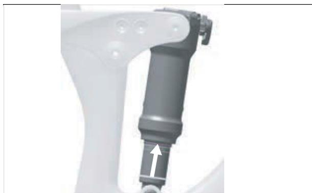
Illustration 152 : Déplacer le joint torique sur l'amortisseur arrière
