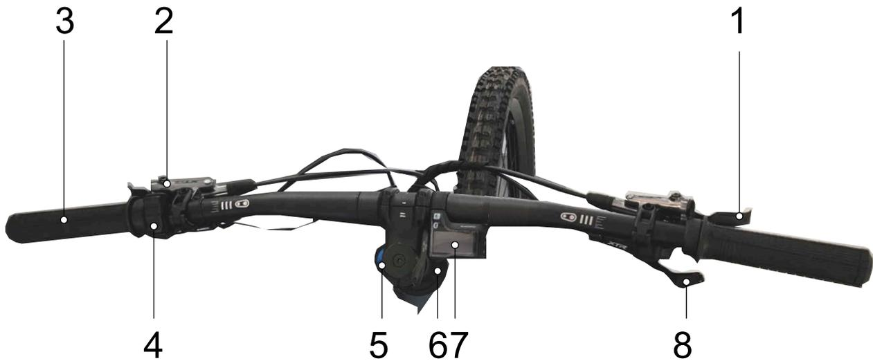
Illustration 72 : Vue détaillée d'un guidon avec ordinateur de bord SHIMANO SC-E800, exemple
