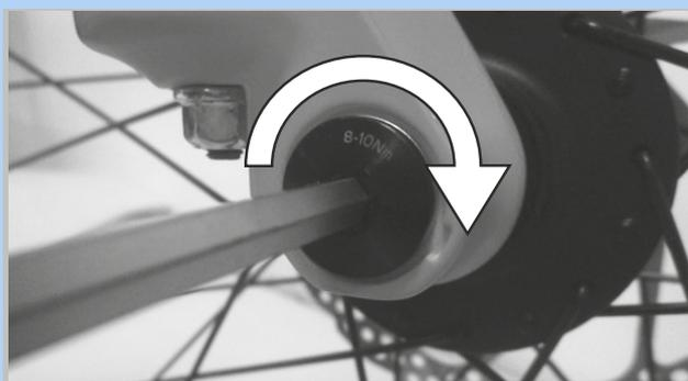
Illustration 91 : Serrer l'axe dans le sens de la flèche
