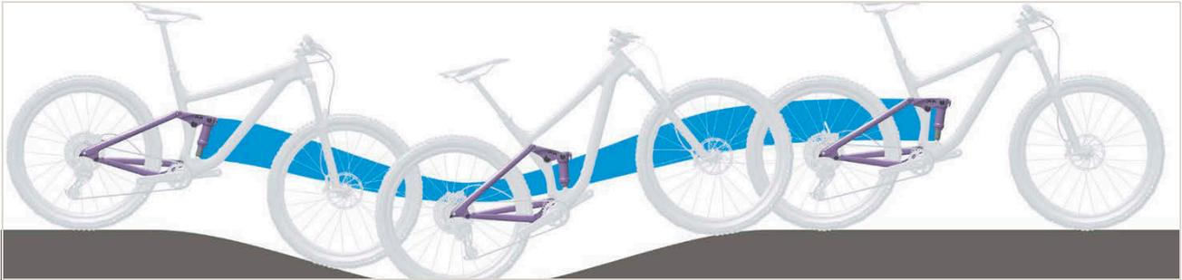
Illustration 281 : Suspension trop souple de l'amortisseur arrière dans les côtes
