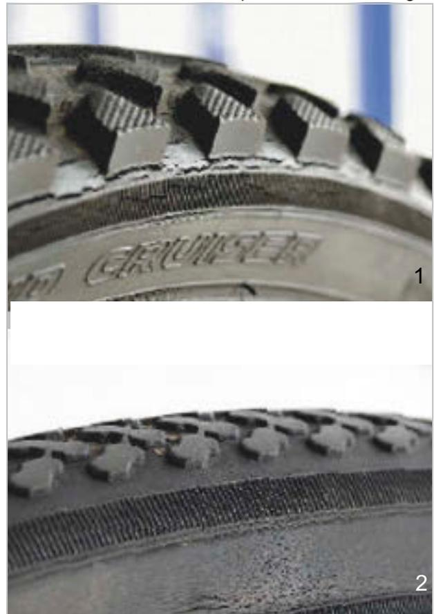
Illustration 225 : Exemples de fissures de fatigue (1) et de fissures d'âge (2)
