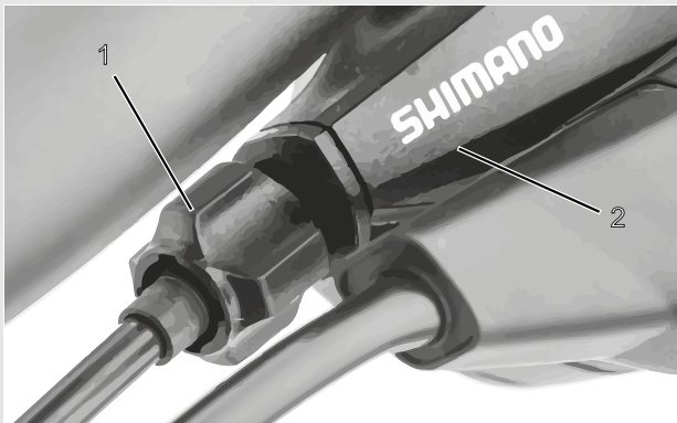
Figura 90: Casquillo de ajuste (1) del cambio de marchas accionado por cable de accionamiento con carcasa de la palanca de cambio (2), ejemplo
