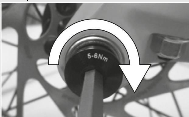
Figura 28: Apriete del tornillo de seguridad
