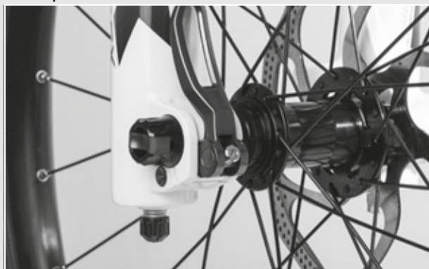
Figura 35: Posición perfecta de la palanca tensora
