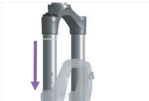
Afbeelding 145: O-ring op de verende voorvork verschuiven
