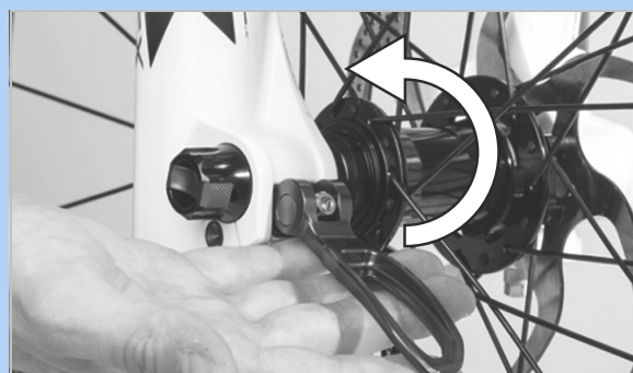
Afbeelding 96: Snelspanhendel in de richting van de pijl drukken
