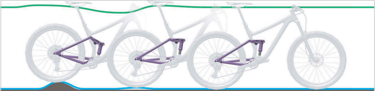
Afbeelding 276: Te snel uitveren van de achterbouwdemper
