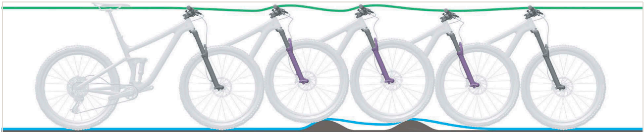
Afbeelding 270: Te langzaam uitveren van de verende voorvork
