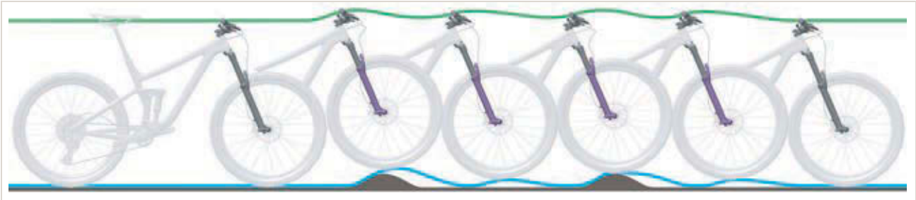
Afbeelding 268: Te snel uitveren van de verende voorvork
