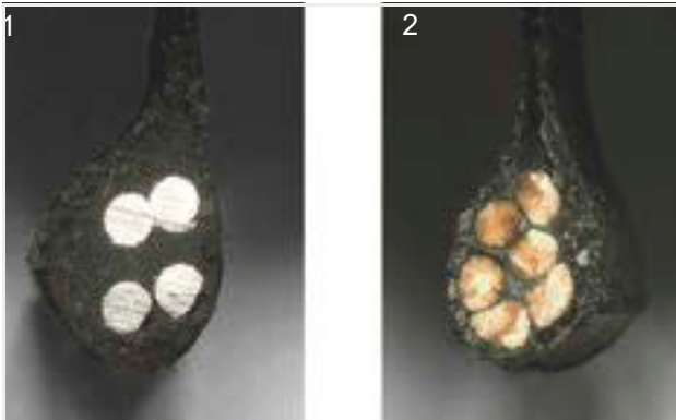
Afbeelding 32: draadkern (1) en Kevlarkern (2)
