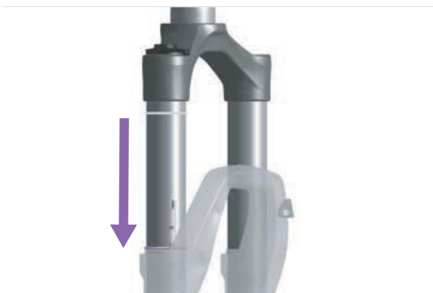
Afbeelding 142: O-ring op de verende voorvork verschuiven
