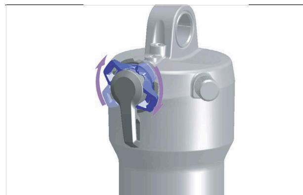
Afbeelding 191: Drukdemperafsteller harder afstellen
