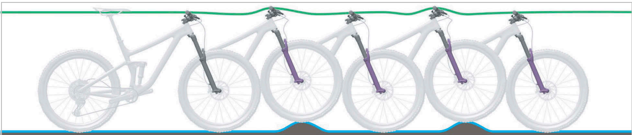
Afbeelding 21: Optimaal rijgedrag van de verende voorvork
