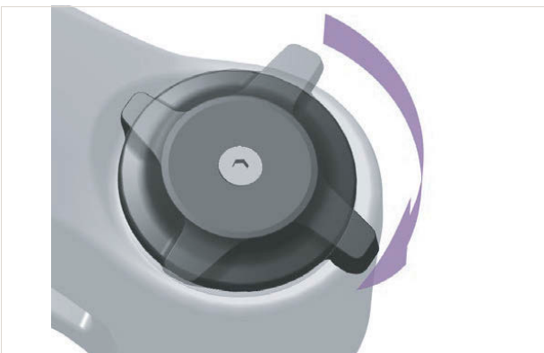
Afbeelding 273: Drukdemperafsteller harder afstellen
