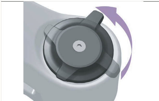
Afbeelding 275: Drukdemperafsteller zachter afstellen
