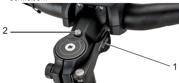
Abbildung 42: Vorbau, Ausführung II mit Spannhebel des Vorbau-Schnellspanners (1) und Entsperrknopf (2)
