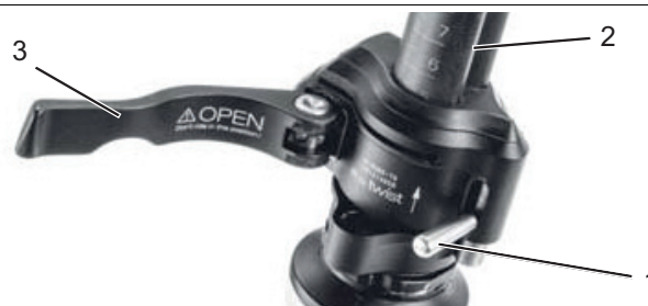
Abbildung 41: Geöffneter Spannhebel des Vorbau-Schnellspanners (3) am Vorbau (2), Ausführung I, mit Sicherungshebel am Vorbau (1)
