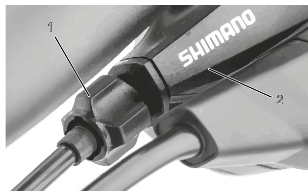
50. ábra: Az egybovdenes, bovdenel működő sebességváltó beállítóhüvelye (1) váltókarházzal (2), példa
