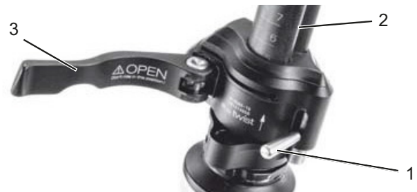
41. ábra: A kormányszár-gyorszár (3) nyitott gyorskioldója a kormányszáron (2), I kivitel, a kormányszáron (1) lévő rögzítőkarral
