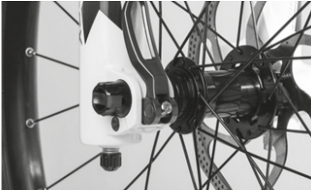
48. ábra: A gyorsár szorítóerejének beállítása
