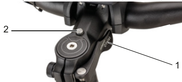
42. ábra: II kivitelű kormányszár a kormányszár-gyorszár (1) gyorskioldójával és reteszelésoldó gombbal (2)
