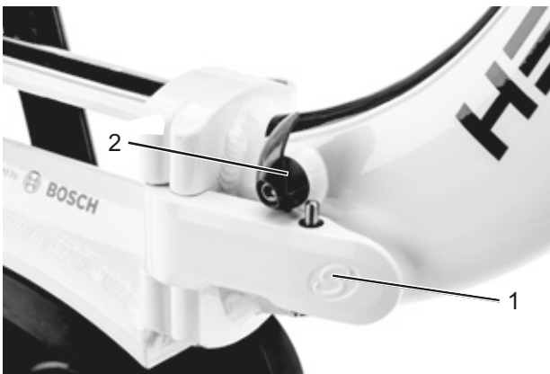
43. ábra: Zárt (1) és nyitott (2) váz-rögzítőkar
