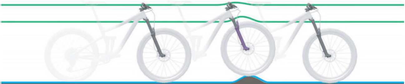
7. ábra: A villa optimális menetviselkedése egyenetlenségek esetén
